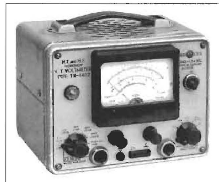
24. ábra. EMG 1343/C univerzális csövoltmérő
