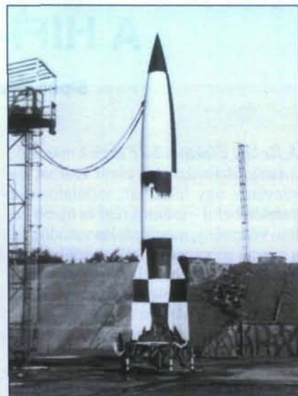
2. ábra. A jellegzetes alcázófestéssel ellátott A-4/V-2 (alkohol+folyékony oxigén üzemű) rakéta egy német rakétakísérleti telepen, az egyszerű acél indítóasztalon, indításra készen
