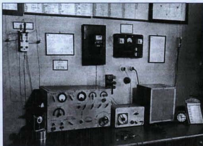
Az egyik híradóőrszolgálati helyiségének üzemi asztala: a 100 W-os adó bal oldalt, középen a vevőkészülék, mellette az anódpótló része
