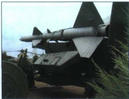
6. ábra. Korai fejlesztésű, elektroncsöves technikájú, szovjet kétlépcsős légvédelmi rakéta az indítóállványon. Igen sok országban volt hadrendben (pl. Egyiptom, Távol-Kelet stb.). A V-2 minőségi továbbfejlesztésének tekinthető. (Haditechnikai Múzeum, Kecel)
