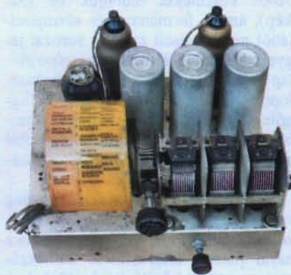
27. kép. A TRT Szuper Olimpikon skálaszerkezete (Körömi Imre gyűjtése)
