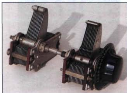
27. kép. Y-forgók összekapcsolása (Simoncsics László gyűjtése)
