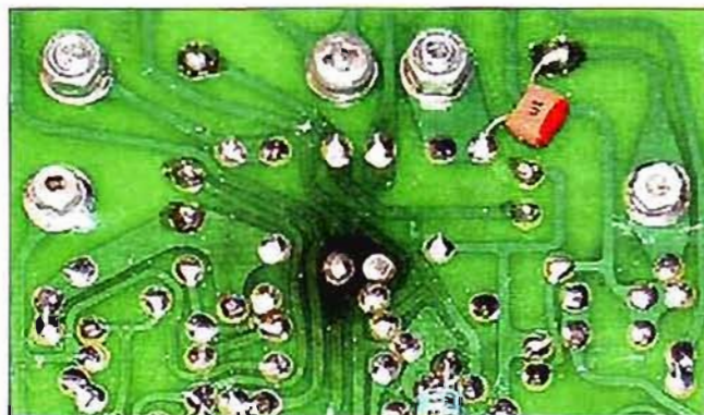
14. ábra. Az R30, R31 jelű, nagy terhelhetőségű, erősen melegedő ellenállások idővel elszeszesítik a QUAD panelt a helyi túlzott hőterhelés folytán (QUAD 405-1)
