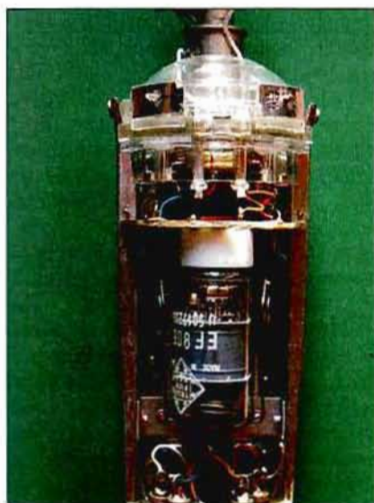
1. fotó. A Neumann gyártású U 67 mikrofon erősítője EF 806 elektroncsövel
