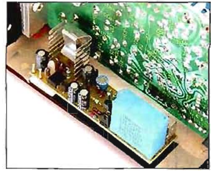
46. ábra. A monó kivitelű (kereskedelmi) koppanásgátló és védőáramkör nyomtatott kis panelja, az átgondolt tervezés folytán, elért a gyári 405-ös erősítő végfok nyákja és a doboz (a képen nem látható) oldalsó fala között
