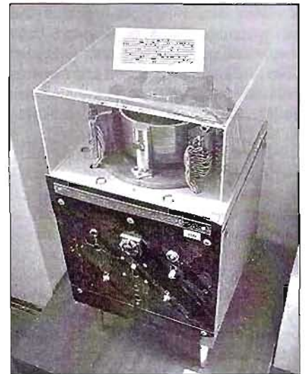
51. ábra. Az új, kétszeres kapacitású mágnesdob. A géphez nem volt hozzákapcsolva
