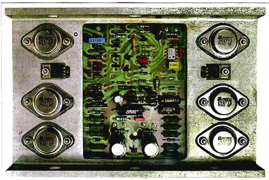
39. ábra. A QUAD 606 erősítő egyik szerelt csatornája a hűtőbordához csatlakozó lapos, U profilú szegleten
