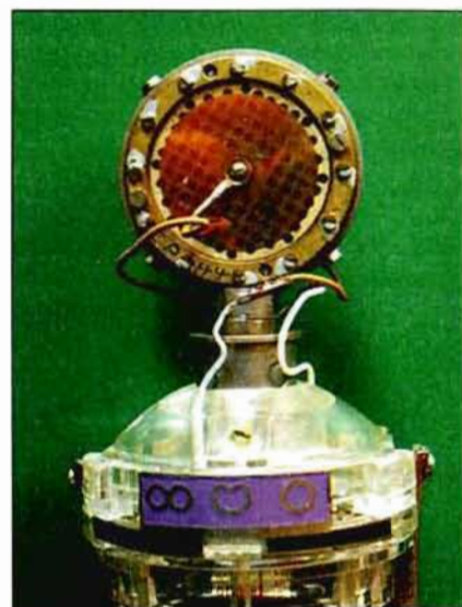
2. fotó. A Neumann U 67 kondenzátor mikrofon 1 hüvelykes kapszulája
