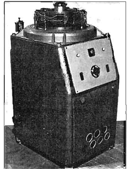
64. ábra. Az M-3 mágnesdobja a szegedi technikatörténeti múzeumban
