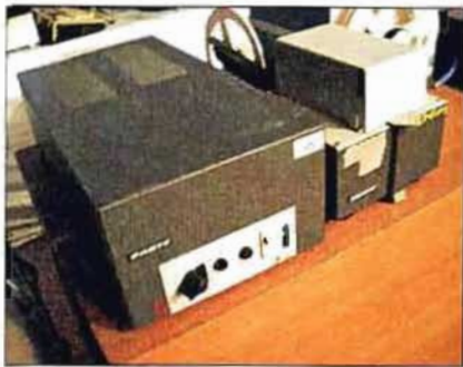
40. ábra. Egy, a Ferrantihoz hasonló Facit 8 csatornás lyukszalag olvasó
