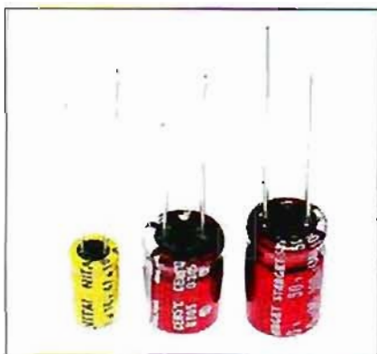
13. ábra. A QUAD erősítő számára a neten árusított egyik elkőkészlet a túl hamar kiszáradó elkők pótlására. Számos cég kínál ilyesféle javító-készleteket
