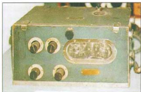
25. ábra. Az N-4 léghajó vevőkészüléke. A plexi ablakon keresztül lehetett szabad szemmel is ellenőrizni a csövek fűtésállapotát
