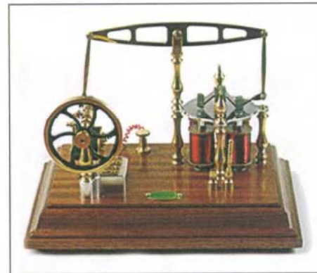
5. ábra. A gőzgép mintájára épített, „kéthengeres” villanymotor-modell, himbával. A két tekercset váltakozva kapcsolgató kommutátor a lendkerék tengelyére van erősítve (Old Model Company, U.K.)
