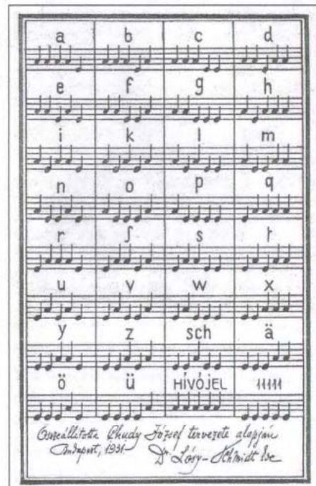
17. ábra. Chudy József akusztikus távirójának betűsora két különböző hangmagasságú dobra alkalmazva. (Lósy-Schmidt Ede rekonstrukciója, 1931.) [Évfordulóink...1988. MTESZ. Budapest, 1987. 80. old.]
