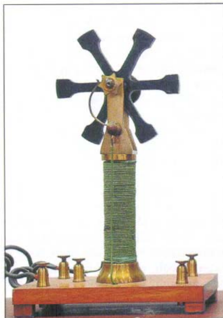
4. ábra. Kizárólag vonzáson alapuló primitív, motor szerű forgó szerkezet, kommutátorral kapcsolgatott elektromágnessel. (Jedlik Ányos Emlékszoza, Czuczor Gergely Bencés Gimnázium és Kollégium, Győr)
