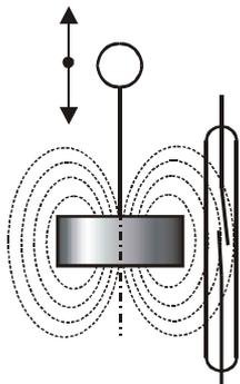
Obr. 1. Vzájomná poloha tabletkového magnetu a jazýčkového kontaktu v pohotovostnom režime
