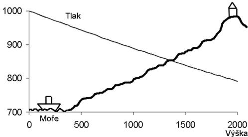
Obr. 2. Závislost tlaku na výšce
