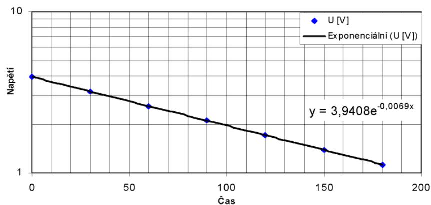
Obr. 1. Vybíjecí křivka kondenzátoru v semilogaritmických souřadnicích
