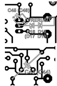
spoji podle obr. 3. Výhodou úpravy podle obr. 2 je možnost použít levnější a menší transformátor a menší tepelná zátáta konstrukce. Nevýhodou je vyšší cena stabilizátorů L4940V05 a nutnost úpravy desky s plošnými spoji.
