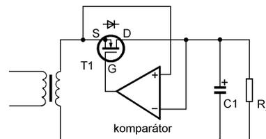
Obr. 21. Řízený usměrňovač pro velmi malá napětí
