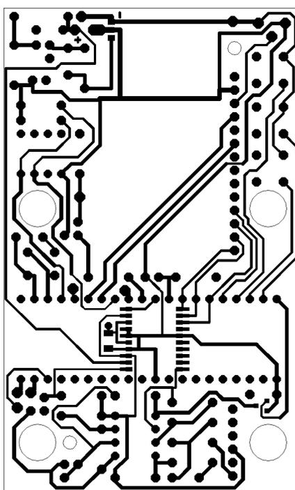
Obr. 8. Deska s plošnými spoji výškoměru
