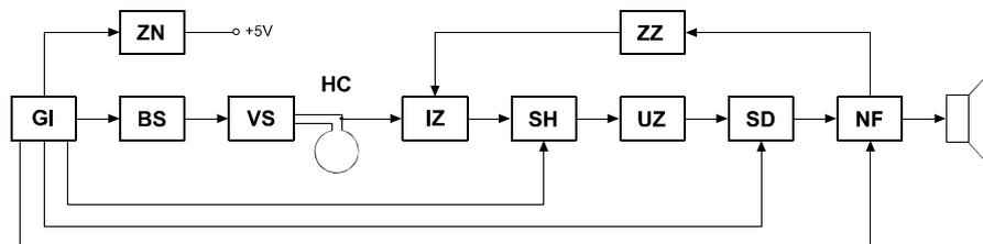
Obr. 14. Blokové zapojení složitějšího hledače kovů: GI - generátor impulsů, BS - budicí stupeň, VS - výkonový stupeň, HC - hledací cívka, IZ - impulsní zesilovač, SH - vzorkovací obvod (sample and hold), UZ - úzkopásmový zesilovač, SD - synchronní detektor, NF - nízkofrekvenční zesilovač, ZZ - zpětnovazební zesilovač, ZN - zdroj napětí
