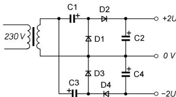
Obr. 19. Zapojení pracující jako symetrický jednocestný zdvojovač nebo dvojecestný násobič čtyřmi
