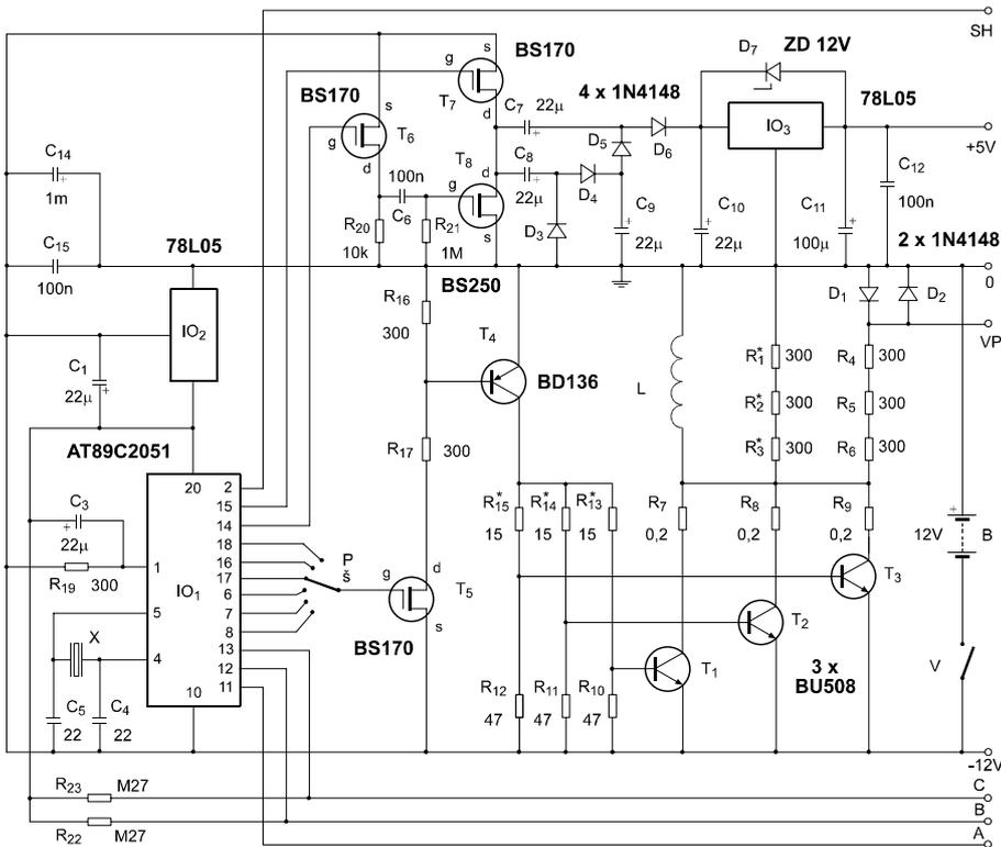
Obr. 16. Podrobné schéma vysílače složitějšího impulsního hledače kovů (nahore obvody měniče napětí)
