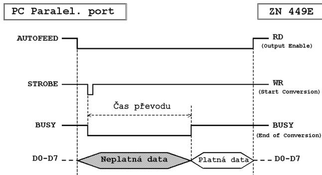
Obr. 2. Diagram průběhů řídicích signálů převodníku
