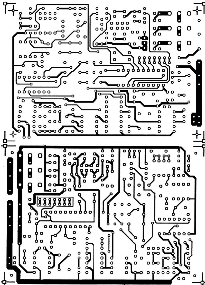
Obr. 18. Deska s plošnými spoji složitějšího impulsního hledače kovů
