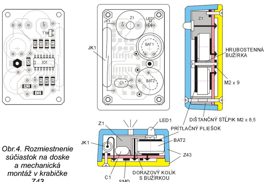
Obr.4. Rozmiestnenie súčiastok na doske a mechanická montáž v krabičke Z43
