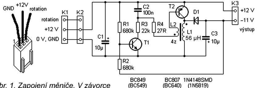
Obr. 1. Zapojení měniče. V závorce jsou typy pro klasickou montáž
