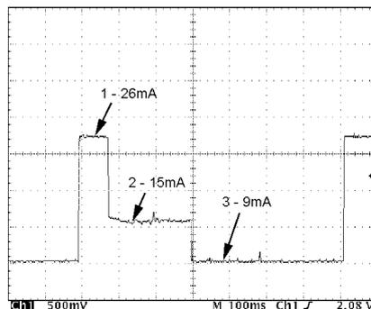
Obr. 6. Spotřeba proudu výškoměru
