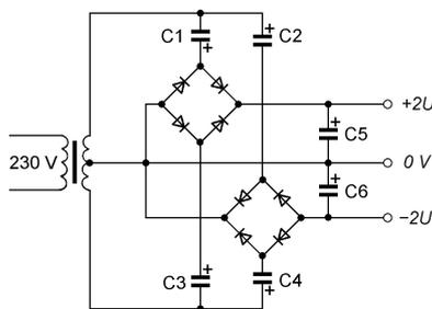
Obr. 20. Dvojecestný symetrický zdvojovač
