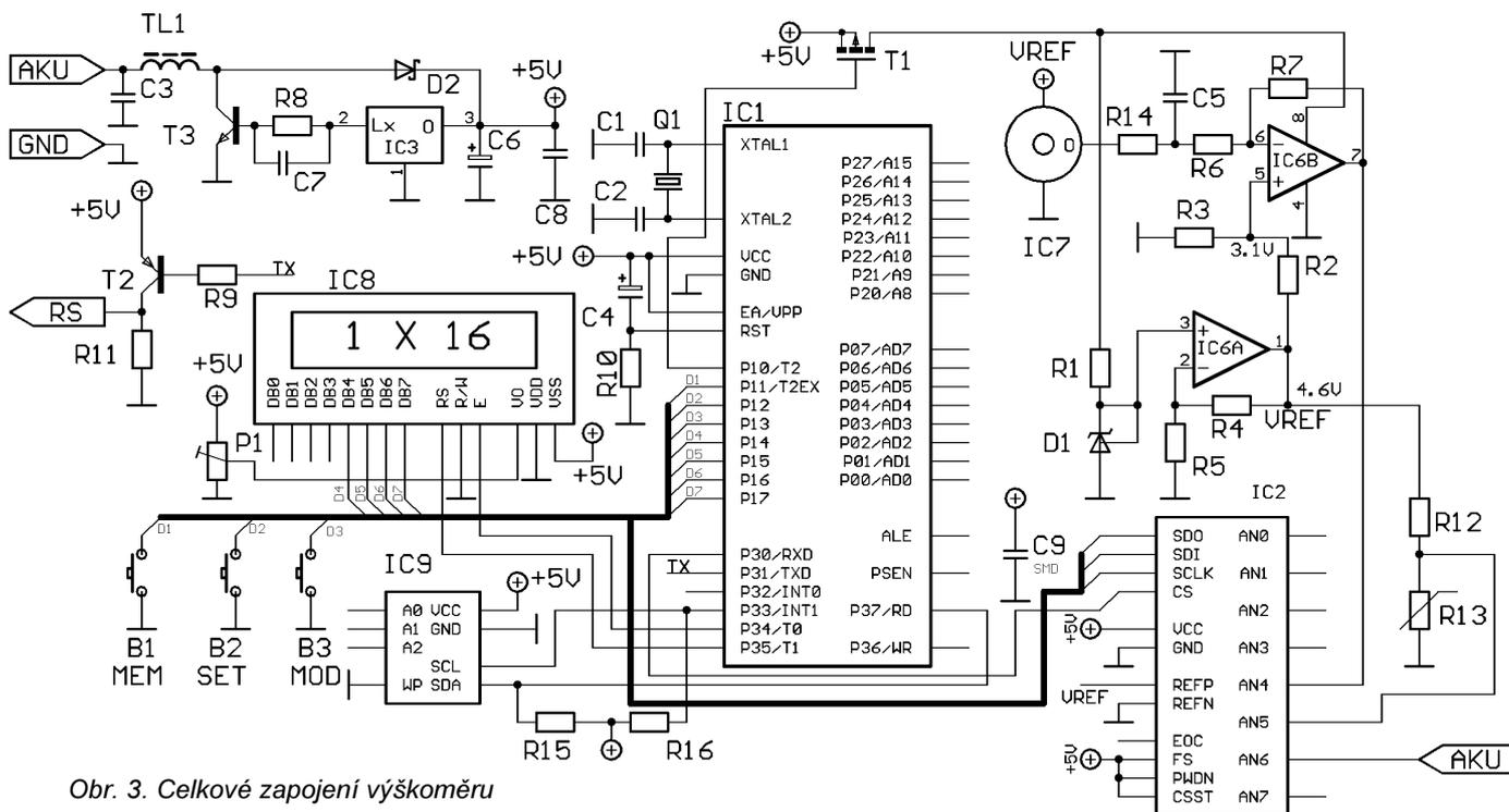
Obr. 3. Celkové zapojení výškoměru
