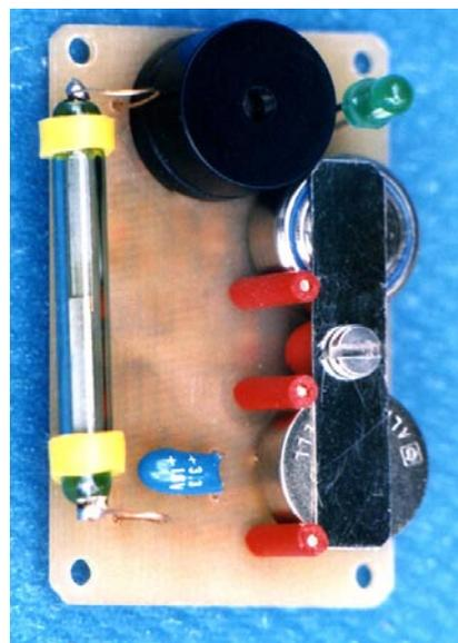
lostivé na mechanické namáhanie, neodporúčam tvarovať jeho vývody a zapájkovať ho do dosky plošných spojov priamo, lebo by to mohlo znížiť nárazuvzdornosť signalizátora ako celku. Vhodnejšie je pripojenie slučkami z tenkých pružných drôťov, ktoré nie sú schopné preniesť väčšie mechanické sily na zátavy a jemne pritlačajú jazýček na vnútornú stenu krabičky. Me-
