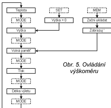
Obr. 5. Ovládání výškoměru
