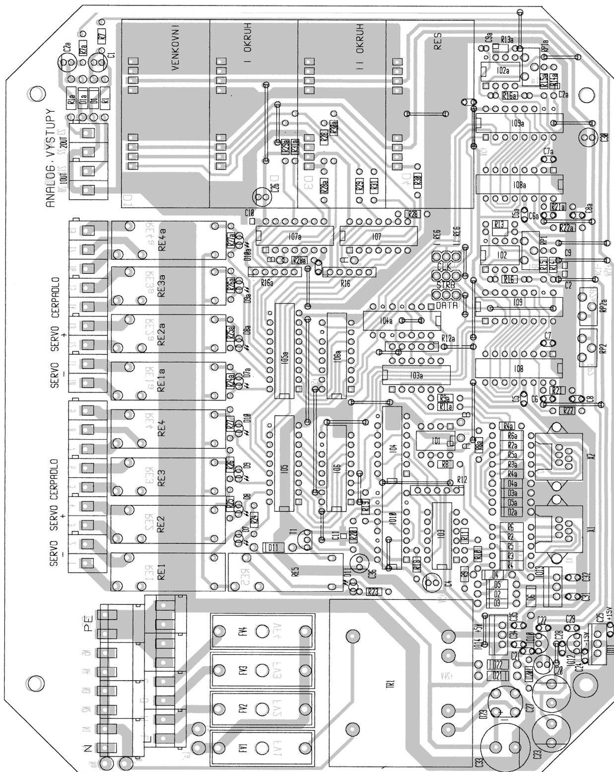
Obr. 9. Rozmístění součástek na výkonové desce s plošnými spoji regulátoru
