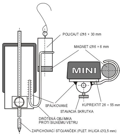
Obr. 5. Príklad mechanickej konfigurácie "do vetra aj dažďa" (pohľad zozadu a zhora)
