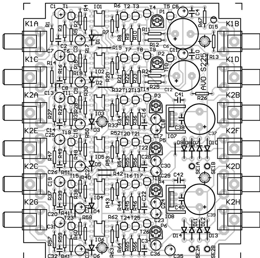
Obr. 6. Rozmístění součástek
