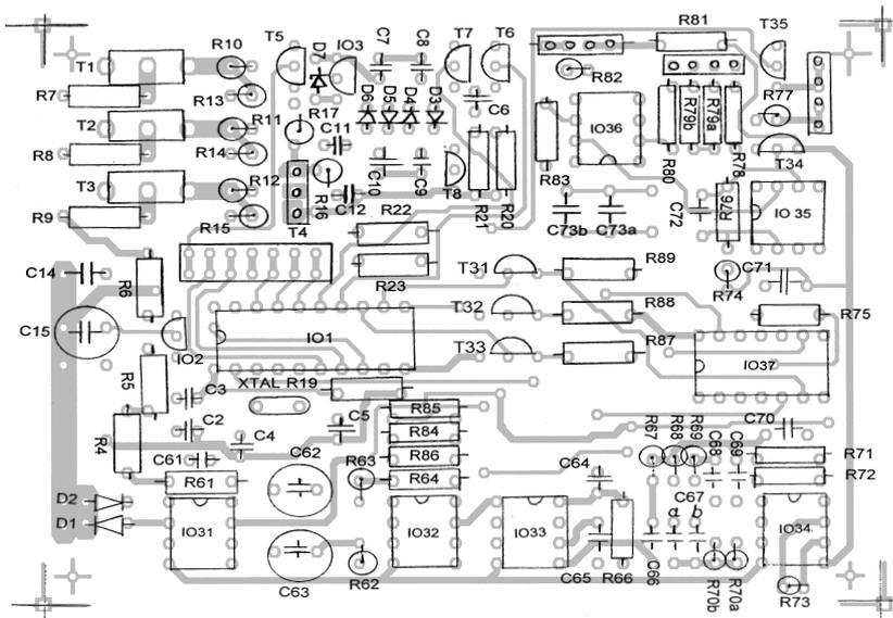
Obr. 19. Rozmístění součástek složitějšího impulsního hledače kovů
