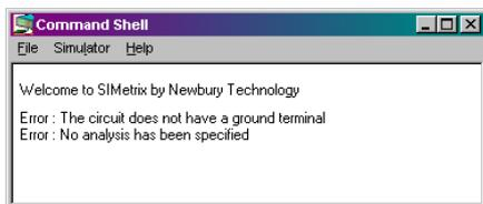
Obr. 1. Pracovné okno s dvoma „začiatočnickými“ chybami: nie je zadaný spoločný vodič (zem) a typ simulácie
