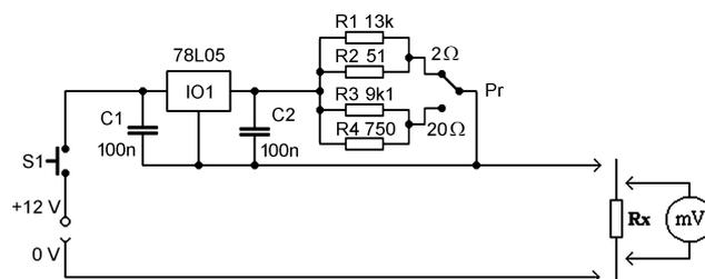
Obr. 1. Zapojenie prípravku na meranie malých odporov
