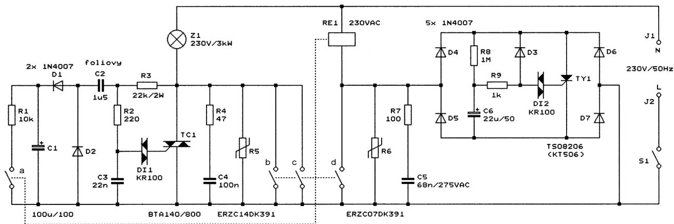
Obr. 3. Obvod pro ochranu síťové žárovky s relé
