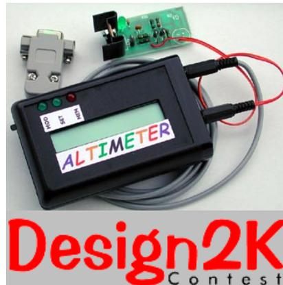
Parametrem určujícím výsledné rozlišení výškoměru je citlivost tlakového čidla. Podle katalogových údajů je to 4,9 mV/hPa. S využitím rovnice (1) a základní matematiky můžeme určit, že pokles tlaku o 1 hPa odpovídá změně výšky o 8 m. Podobně změna o 1 m výšky vyvolá změnu výstupního napětí čidla o 0,6 mV.
