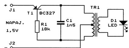
Obr. 8. LED napájená napětím 1,5 V
