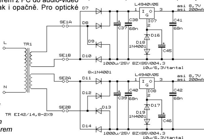
Obr. 2. Zapojení zdroje s menším transformátorem
