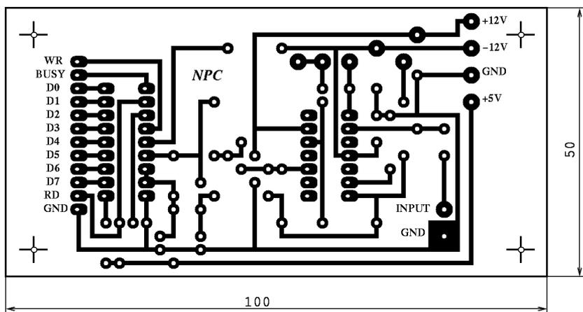
Obr. 3. Deska s plošnými spoji paměťového osciloskopu a rozmístění součástek na desce
