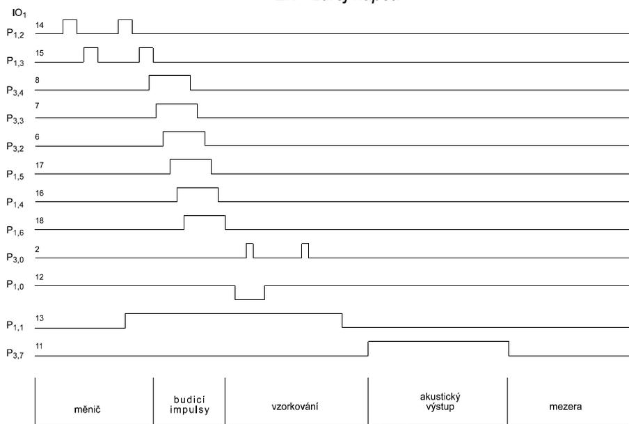
Obr. 15. Impulsní časový diagram složitějšího hledače
