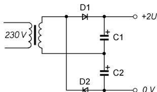
Obr. 17. Dvojecestný zdvojovač napětí
