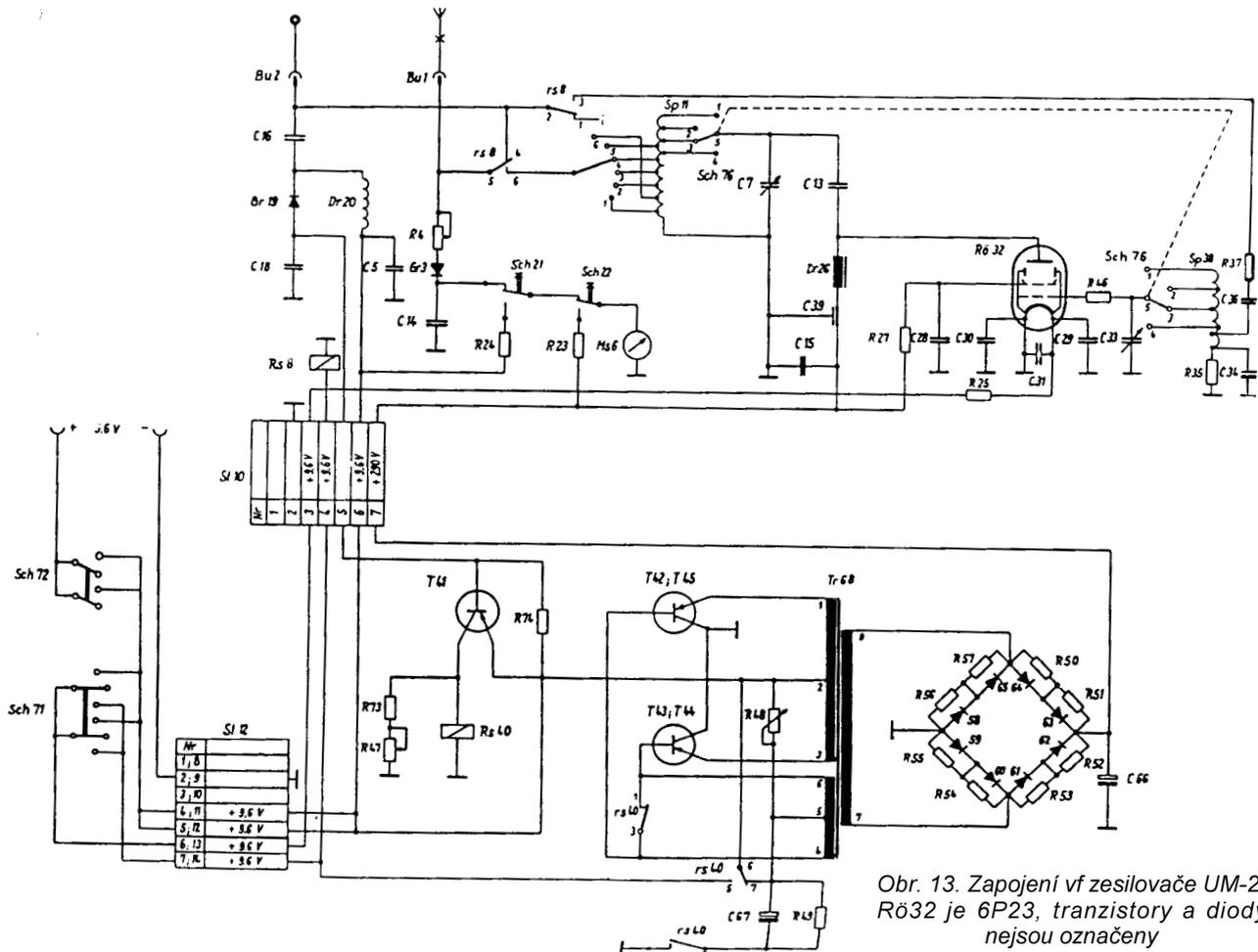
Obr. 13. Zapojení vf zesilovače UM-2. R632 je 6P23, tranzistory a diody nejsou označeny
