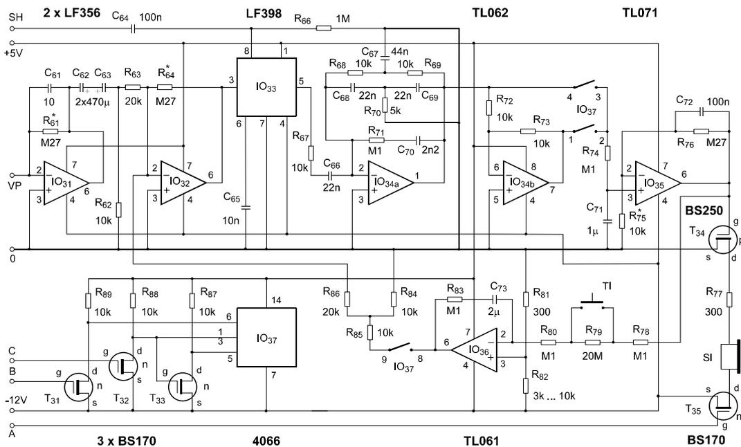
Obr. 17. Podrobné schéma přijímače složitějšího impulsního hledače kovů
