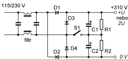
Obr. 18. Přepínatelný usměrňovač – zdvojovač
