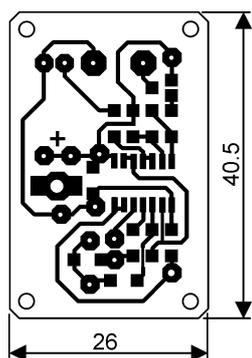
Obr. 3. Doska s plošnými spojmi v mierke 1:1
