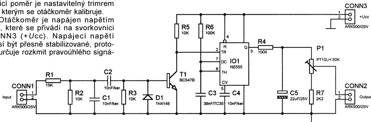
Obr. 1. Digitální otáčkoměr
