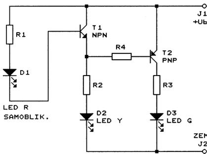
Obr. 6. Blikač se samoblikající LED
