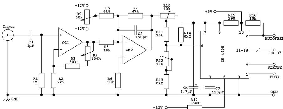
Obr. 1. Schéma zapojení modulu paměťového osciloskopu
