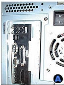
Obr. 2. Ventilátor s foukáním ven ze skříně
