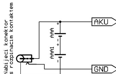
Obr. 10. Příklad zapojení nabíjecího konektoru
