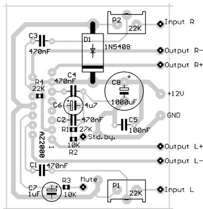
Obr. 1. Deska s plošnými spoji pro zesilovač v měřítku 1:1 a rozmištění součástek na desce
