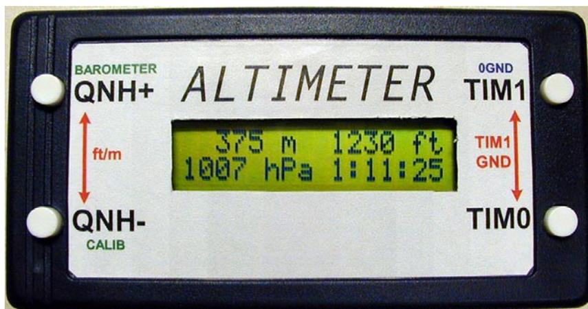
Obr. 11. Vzhled výškoměru pro letadlo
