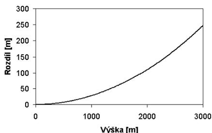
Obr. 12. Vliv korekce teploty na vypočítanou výšku
