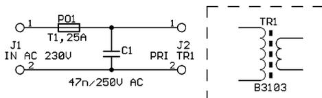
Obr. 5. Schéma externího zdroje
