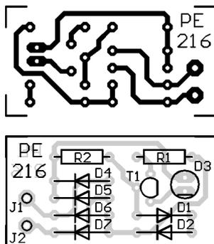
Obr. 2. Obrázek plošných spojů a rozmístění součástek na desce univerzálního indikátoru napětí (měř.: 1 : 1)
