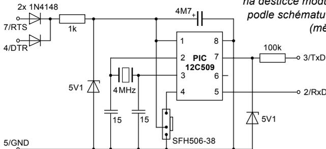
Obr. 1. Schéma modulu UIR s hodinovým kmitočtem řízeným krystalem
