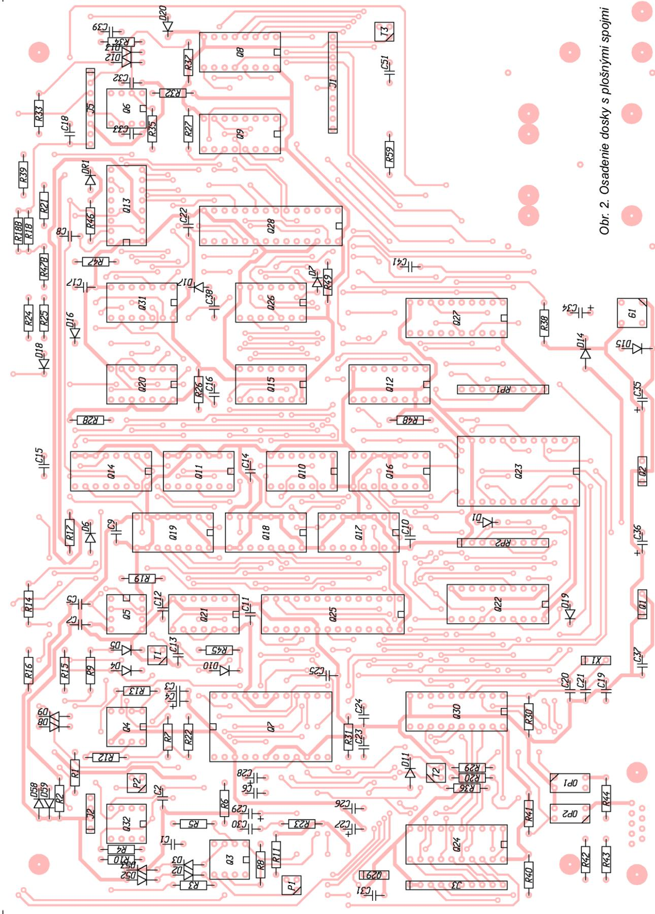
Obr. 2. Osadenie dosky s plošnými spojmi
