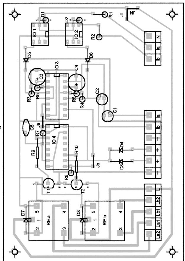
Obr. 4. Deska s plošnými spoji přepínače
