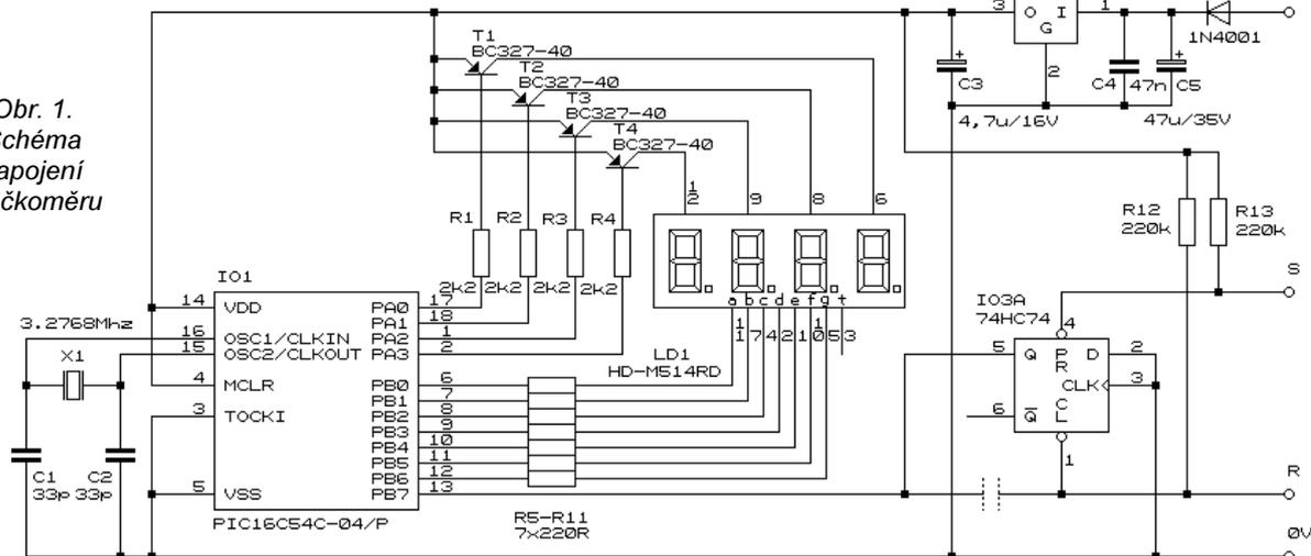
IO2. Při napájení od +14 do +24 V musíme použít chladič DO1 (GM). Klopný obvod RS IO3A je použit pro odstranění případných zákmitů na vstupu.
