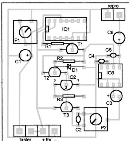
Stisknutím tlačítka se nabije kondenzátor C1 a na vstupu hradla je úroveň H. Na výstupu hradla je taktéž úroveň H, otevře se tranzistor T1 a přivede napětí na obvod generátoru, kde je zařazen stabilizátor napětí, tvořený obvodem T2-R2-D1. Ten upravuje napájecí napětí na jmenovité napětí generátoru, které je 3 V. Tranzistor T3 otevírá a zesiluje výstup generátoru na
