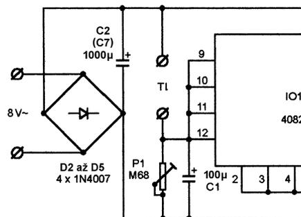
Obr. 7. Úprava zapojení z obr. 1 a 4 pro napájení zvonkovým transformátorem
