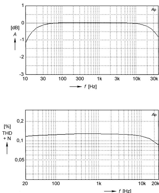
Obr. 4. Kmitočtová charakteristika zesilovače (vlevo)
