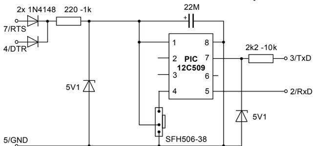
Obr. 2. Schéma modulu UIR s interními hodinami
