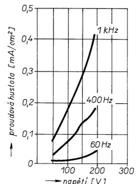
Obr. 7. Proudová hustota luminiscenční fólie v závislosti na kmitočtu a napájecím napětí
