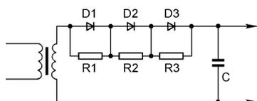
Obr. 22. Usměrňovač vysokého napětí
