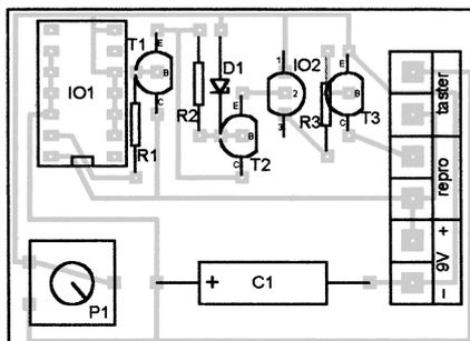
Obr. 2 a 3. Deska s plošnými spoji pro zvonek z obr. 1 v měřítku 1:1 a rozmístění součástek na desce
