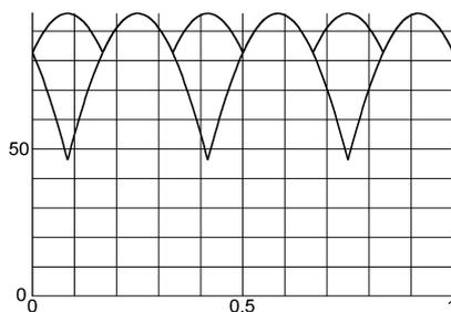
Obr. 26. Porovnání průběhu výstupního napětí usměrňovače z obr. 23 a obr. 25.
