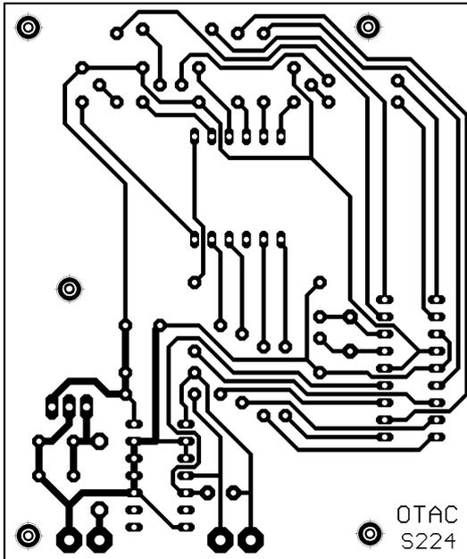
Obr. 8. Deska s plošnými spoji otáčkoměru
