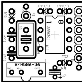
Obr. 4b. Rozmístění součástek na desce s plošnými spoji podle obr.4a (2:1)
