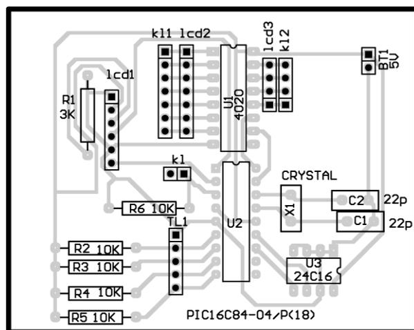
Obr. 2. Deska s plošnými spoji pro databanku z obr. 1 v měřítku 1:1 a rozmístění součástek na desce
