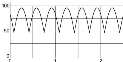
Obr. 24. Průběh napětí na zátěži usměrňovače z obr. 23
