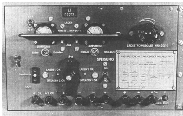
Obr. 15b. Nabíjecí souprava stanice R-104
