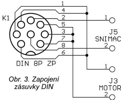
Obr. 3. Zapojení zásuvky DIN
