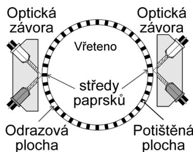
Obr. 5. Vzájemné umístění optických závor
