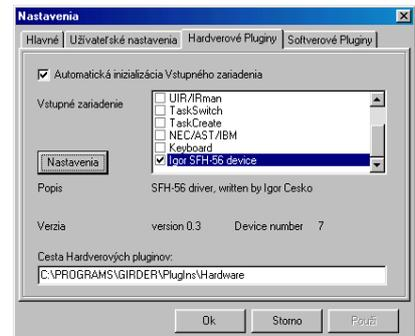
Obr. 11. K vyhodnocování přijatého IR signálu zvolil autor volně šířený program Girdler a naprogramoval do něj plug-in
