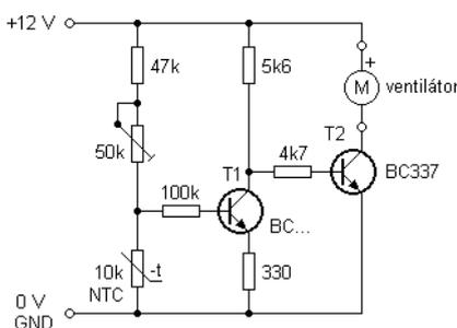
Obr. 1. Regulátor ventilátoru
