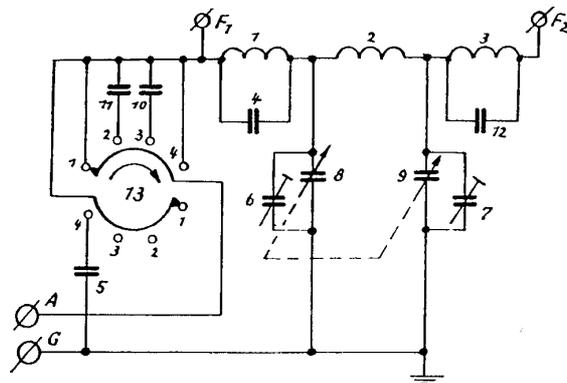
Obr. 15c. Nesymetrický výstup v výkonového stupně stanice R-104 se připojuje na svorky „A“ a „G“, na symetrický výstup - svorky „F1“ a „F2“ se připojí napáječ dipólu (je součástí výbavy stanice)
