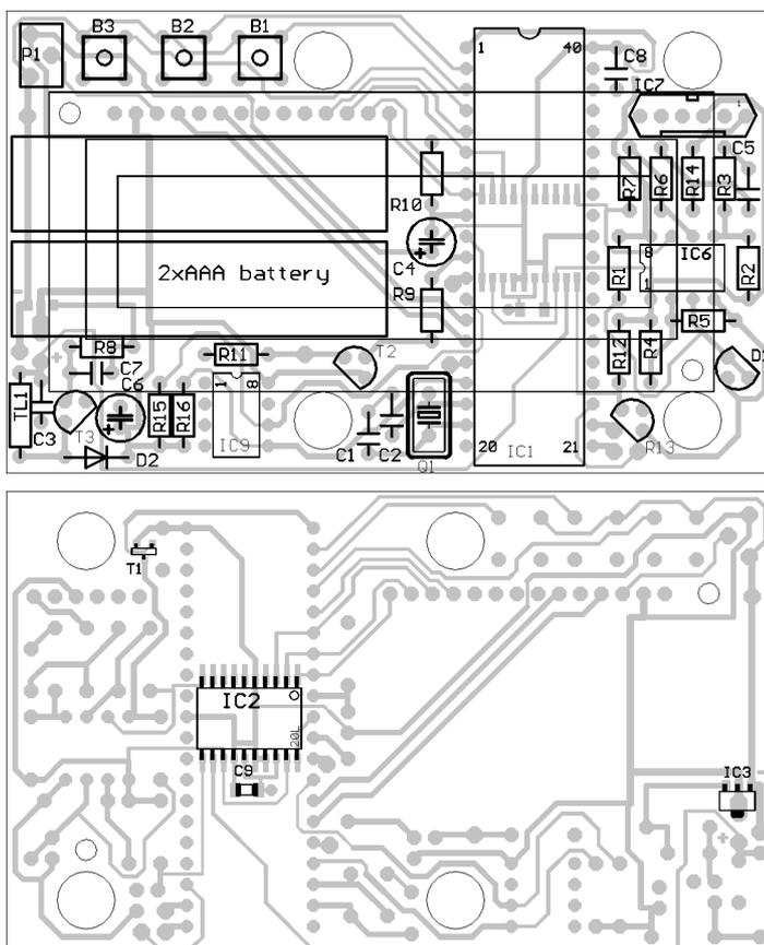
Obr. 9. Rozmístění součástek na obou stranách desky
