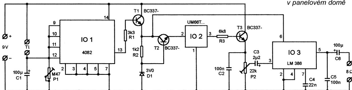
Obr. 4. Melodický zvonek se zesilovačem a napájením z baterie
