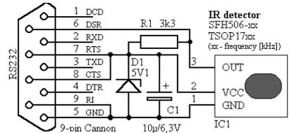
Obr. 9. Zapojení IR modulu podle ing. Igora Cesko
