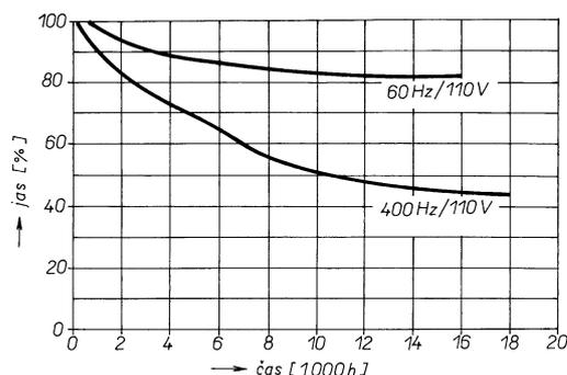
Obr. 5. Relativní jas luminiscenční fólie v závislosti na stárnutí
