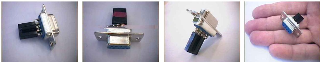
Obr. 8. Fotografie modulu jednoduchého přijímače ing. I. Ceska, zapojeného přímo na konektoru (pro zasunutí do sériového portu PC)
