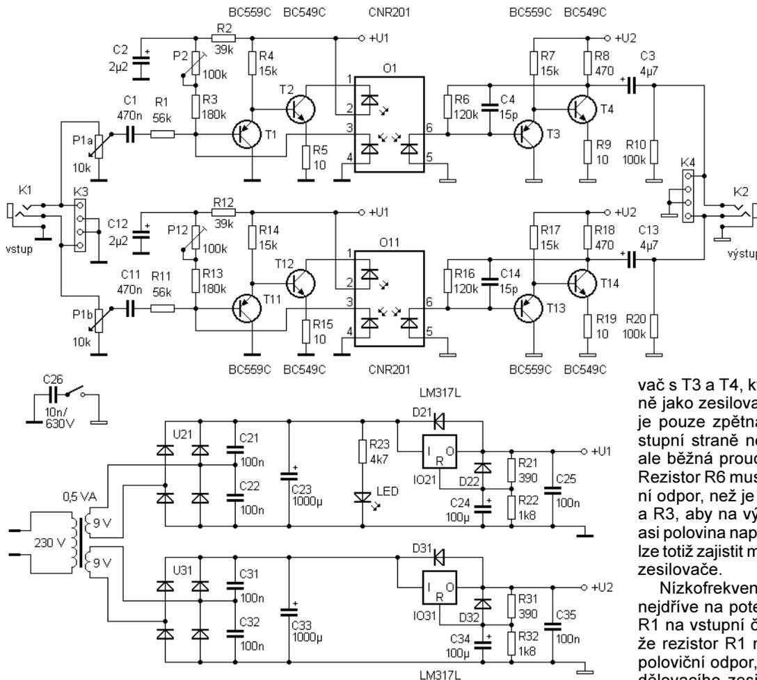
vač s T3 a T4, který je zapojen obdobně jako zesilovač s T1 a T2. Rozdílná je pouze zpětná vazba, která na výstupní straně není optická přes LED, ale běžná proudová přes rezistor R6. Rezistor R6 musí mít přibližně poloviční odpor, než je součet odporů R2, P2 a R3, aby na výstupu zesilovače byla asi polovina napájecího napětí. Jen tak lze totiž zajistit maximální vybuditelnost zesilovače.
