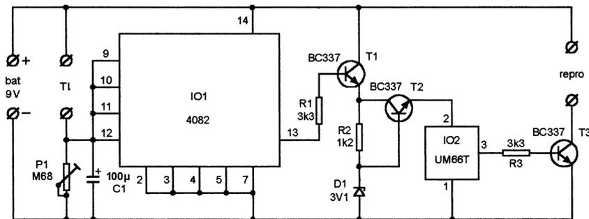
Obr. 1. Melodický zvonek s napájením z baterie
