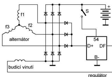
Obr. 27. Automobilový alternátor s regulátorem
