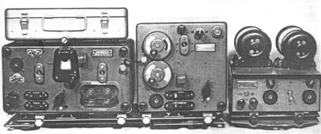
Obr. 16. Souprava KV stanice 10RT. Odleva přijímač, vysílač a dva rotační měniče. Hmotnost s baterií 42 kg
