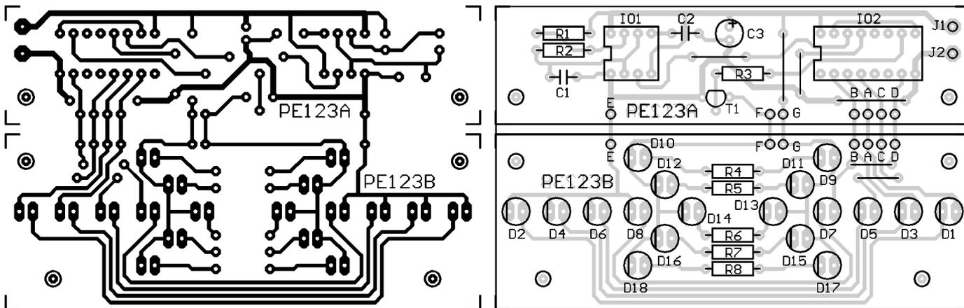
Obr. 4. Obrázek plošných spojů a rozmístění součástek na desce běžících šipek (měř.: 1 : 1)
