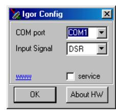
výrobce obvodu TSOP17xx. Výstup z modulu je přiveden na vstup DSR sériového portu, kde ho již zpracovává software osobního počítače.
