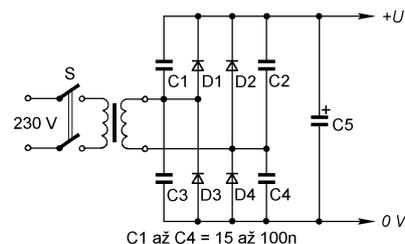
Obr. 28. Můstkový usměrňovač s odrušovacími kondenzátory
