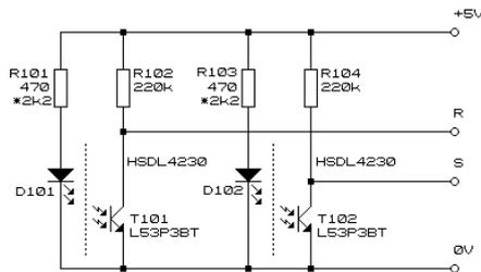
Obr. 2. Zapojení optické závory pro otáčkoměr
