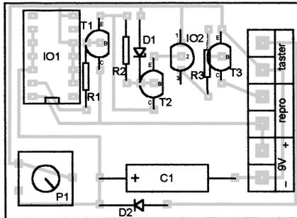
Obr. 9 a 10. Deska s plošnými spoji pro zvonek z obr. 1 s napájením ze zvonkového transformátoru a rozmístění součástek na desce
