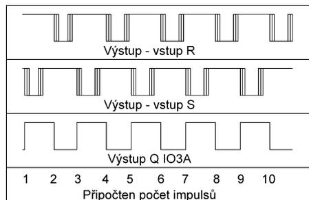
Obr. 6. Průběh impulsů z optických závor a následné zpracování až do vstupu mikrokontroléru
