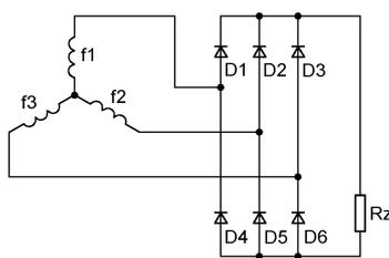
Obr. 25. Celovlnný třífázový usměrňovač
