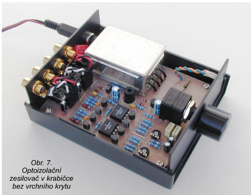
Obr. 7. Optoizolační zesilovač v krabičce bez vrchního krytu
