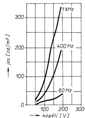
Obr. 7. Jas luminiscenční fólie v závislosti na kmitočtu a napájecím napětí
