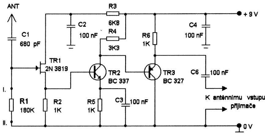
Obr. 5. Neladěný anténní zesilovač
