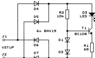
Obr. 1. Univerzální indikátor napětí
