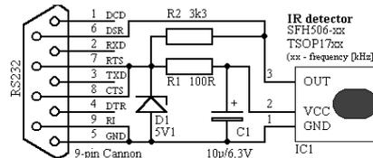
Obr. 10. Zapojení IR modulu s vyšší citlivostí
