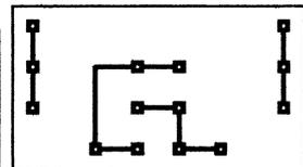
Obr. 3 Deska s plošnými spoji usměrňovače
