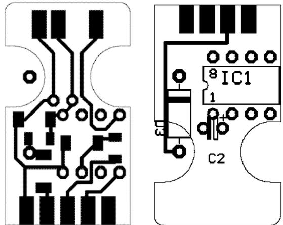
RxD sériového portu PC. RS232 má sice definovanou minimální úroveň pro log. 1 –3 V a pro log. 0 +3 V, ale běžné sériové porty překlápějí někde kolem 1 V, což je dostatečně vhodné napětí i pro logiku TTL. Aby PC mohl s mikroprocesorem komunikovat, je napětí z vývodu TxD omezen rezistorem 100 k a Zenerovou diodou 5V1 na asi 5 V při log. 0 a 0 V (popř. – 0,6 V) při log. 1.
