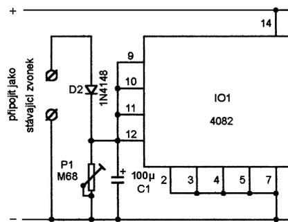
Obr. 8. Úprava zapojení z obr. 1 a 4 pro připojení místo stávajícího zvonku v panelovém domě
