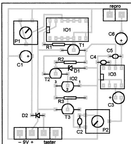
Obr. 13 a 14. Deska s plošnými spoji pro zvonek z obr. 4 s napájením ze zvonkového transformátoru a rozmístění součástek na desce
