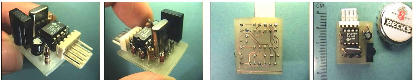
Obr. 3. Fotografie osazeného modulu UIR s PIC 12C509 na destičce s plošnými spoji podle obr. 4a
