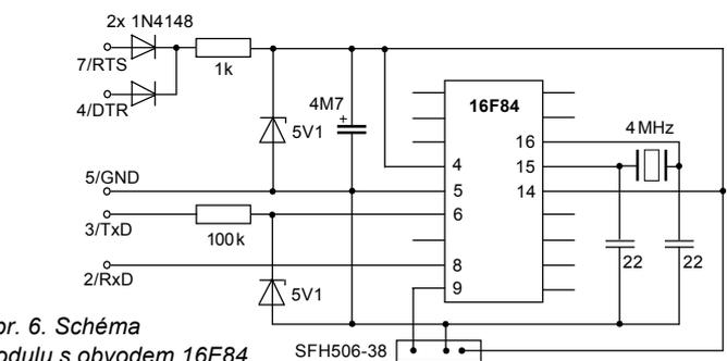
Obr. 6. Schéma modulu s obvodem 16F84
