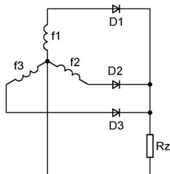
Obr. 23. Třífázový usměrňovač s jednocestným usměrněním fází
