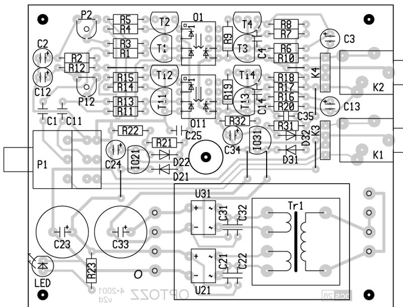
Obr. 2 a 3. Deska s plošnými spoji v měřítku 1:1 a rozmístění součástek
