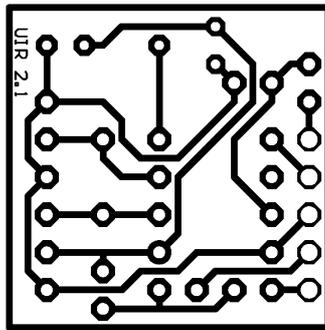
Obr. 4a. Obrázek plošných spojů pro zapojení podle obr.1 (2:1)
