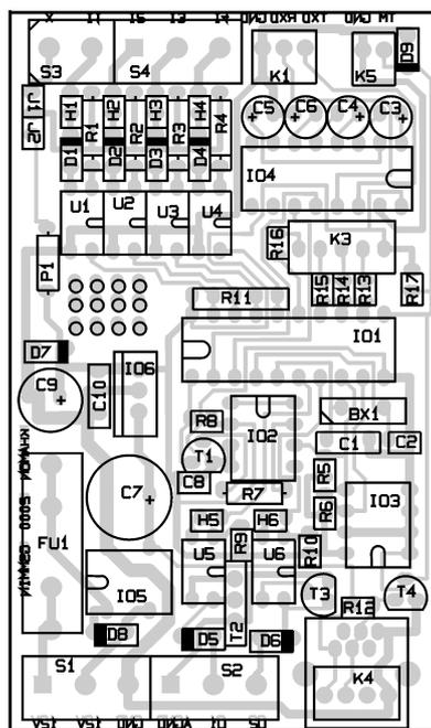
Obr. 2. Doska s plošnými spojmi a osadenie dosky
