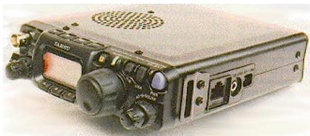
Samozřejmě, že kromě perníkových byly k vidění i k dostání transceivery skutečné - ve stánku FCC Connect např. YAESU FT-817 neuvěřitelného kapesního formátu se všemi pásmy KV, 50, 144 i 430 MHz, všemi druhy provozu a výkonem 5 W ⇕⇔
