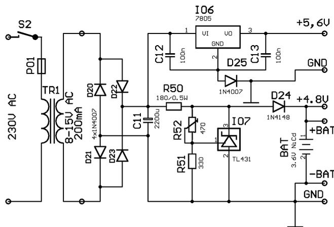
Obr. 3. Schéma zapojenia bloku č. 3 – zdroj
