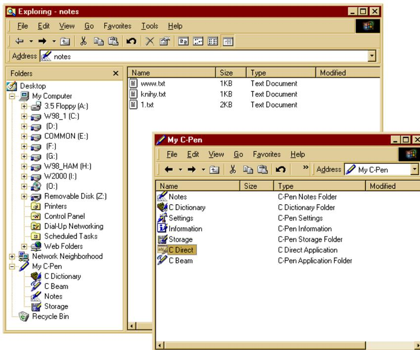
Obr. 8. Pro osobní počítač má ruční skener C-Pen aplikaci CWin - umožňuje pracovat s pamětí C-Penu jako s diskem a provádět se soubory všechny obvyklé operace obvyklým způsobem. Pro přímé přenášení textu do aplikací Windows je to pak aplikace CDirect, která pracuje na pozadí a nemá žádné pracovní okno
