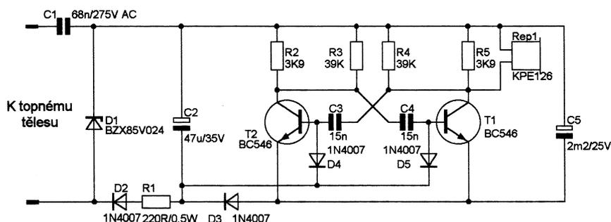
Obr. 4. Indikátor vypnutí varné konvice
