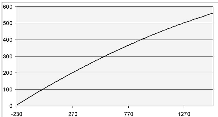
Na obr. 2 vidíme závislost odporu čidla CRZ-1632 japonské firmy Hayashi Denko na teplotě. Na ose X je teplota, na ose Y odpor čidla. Pracovní oblast testovaného čidla je -50 až +800 °C. Podle tabulky mohou některé typy pracovat v rozsahu -200 až +850 °C. Rozsah -230 až 1529 °C byl dopočítán.
