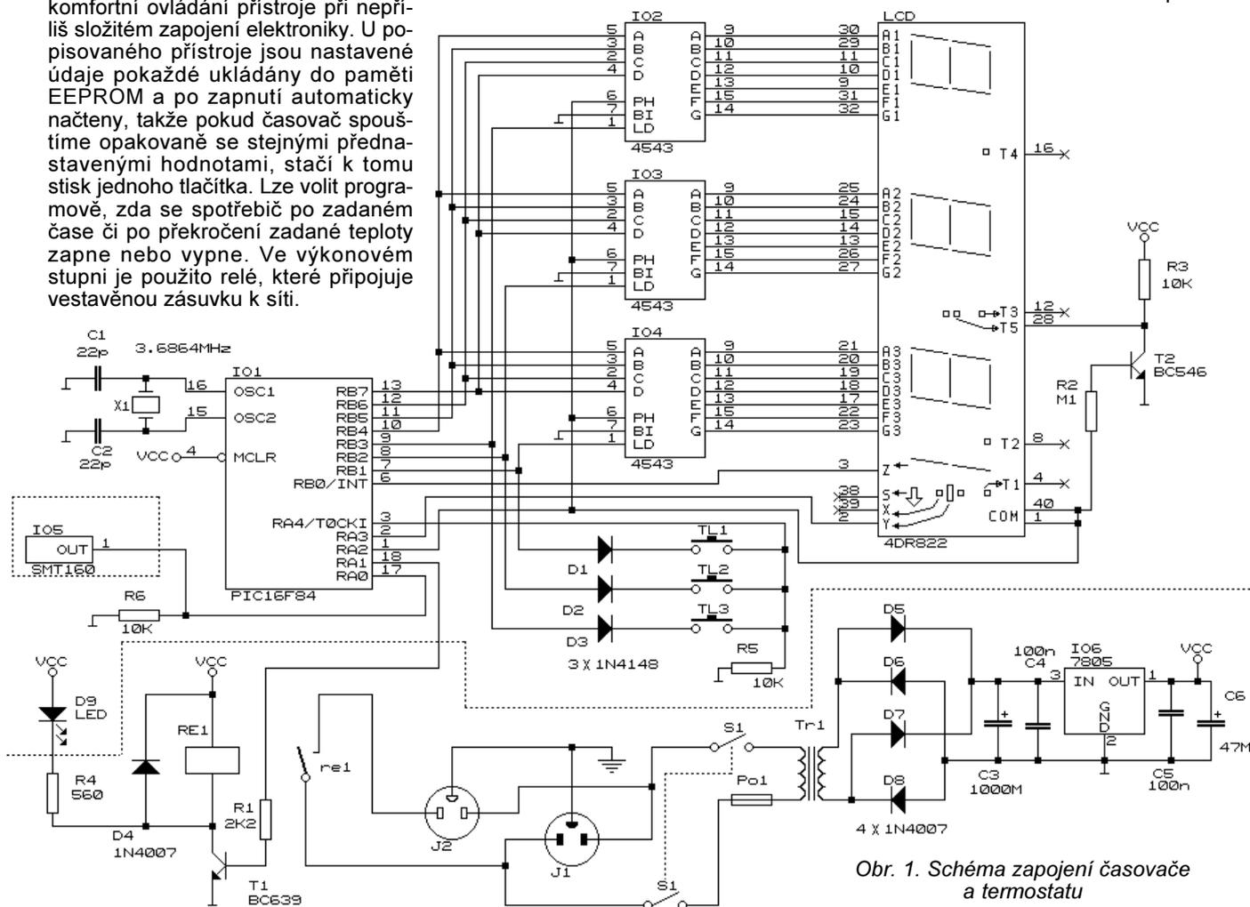
Obr. 1. Schéma zapojení časovače a termostatu
