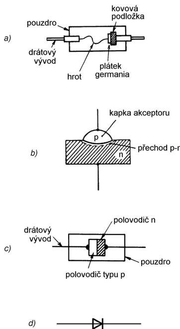
Obr. 4. Uspořádání germaniové hrotové diody (a), přechod vytvořený sléváním (b), křemíková dioda (c) a schematická značka diody (d)
