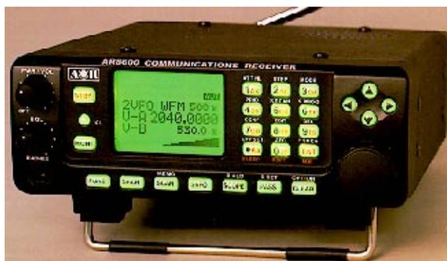
⇕ Komunikační přijímač AOR typu AR8600 předváděli ve stánku firmy ELIX. Pracuje v rozsahu 530 kHz až 2040 MHz všemi druhy provozu s vynikajícími vř vlastnostmi, s filtry Collins jako příslušenstvím a s možností přímého připojení k počítači ⇕ pfm
