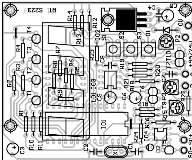
Obr. 3. Deska s plošnými spoji měřiče teploty
