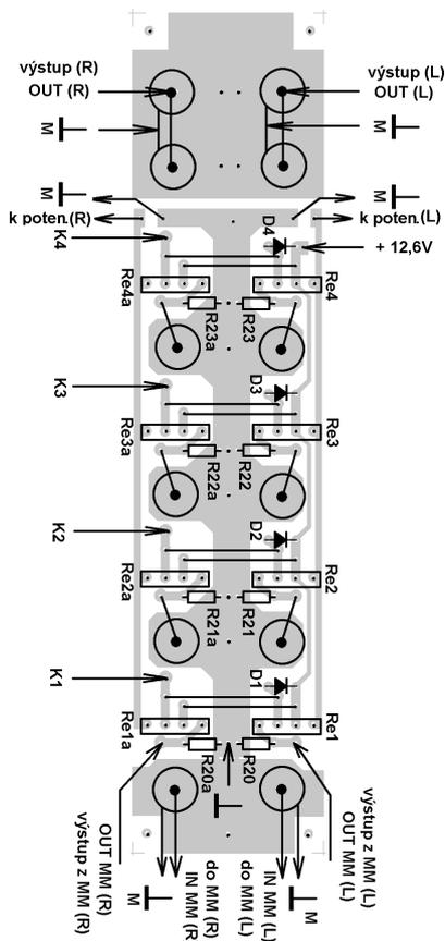
Obr. 9. Rozmístění součástek desky vstupů
