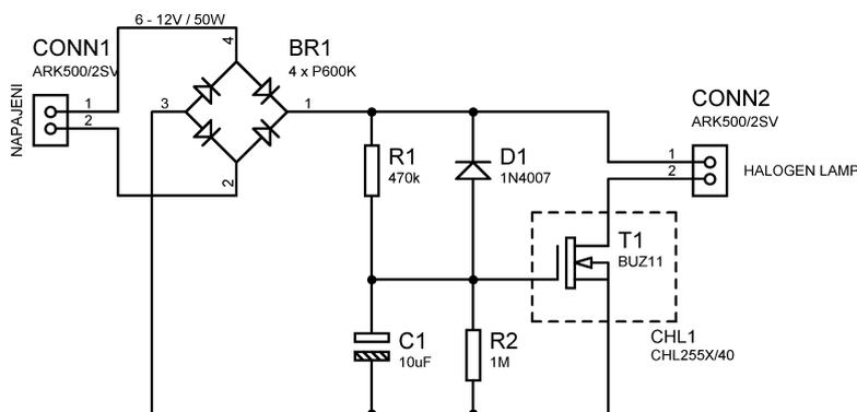
Obr. 1. Schéma zapojení spínače
