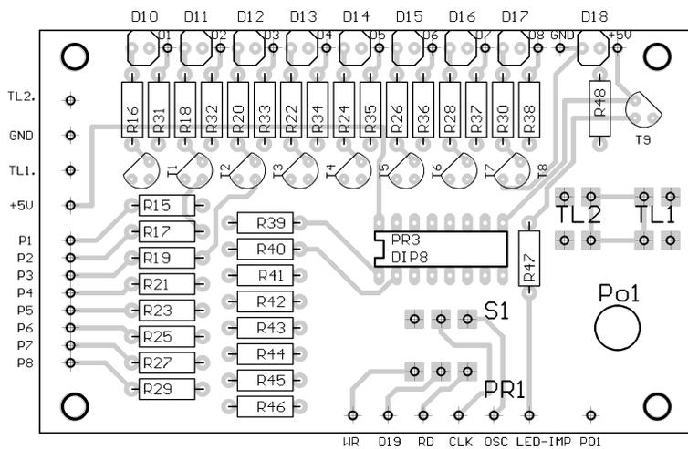
Obr. 5. Doska s plošnými spojmi pre blok č. 2: shora spodná vrstva, strana súčiastok a rozmiestnenie súčiastok
