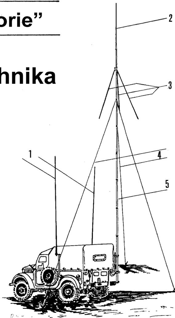
Obr. 26. Souprava R-125 se vztyčenými anténami v pohotovostním stavu: 1 - pevné tyčové antény; 2 - tyčová anténa vzor „Kulikov“; 3 - protiváhy antény „Kulikov“; 4 - napínací a kotevní lana; 5 - teleskopický vysunovací stožár (Magirus)
