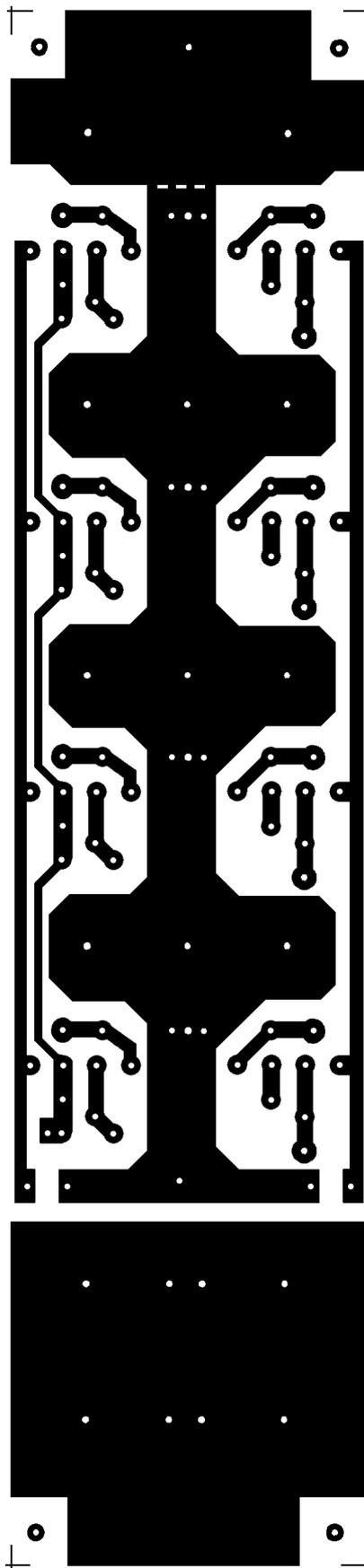
Obr. 10. Deska s plošnými spoji vstupů (230 x 52 mm)
