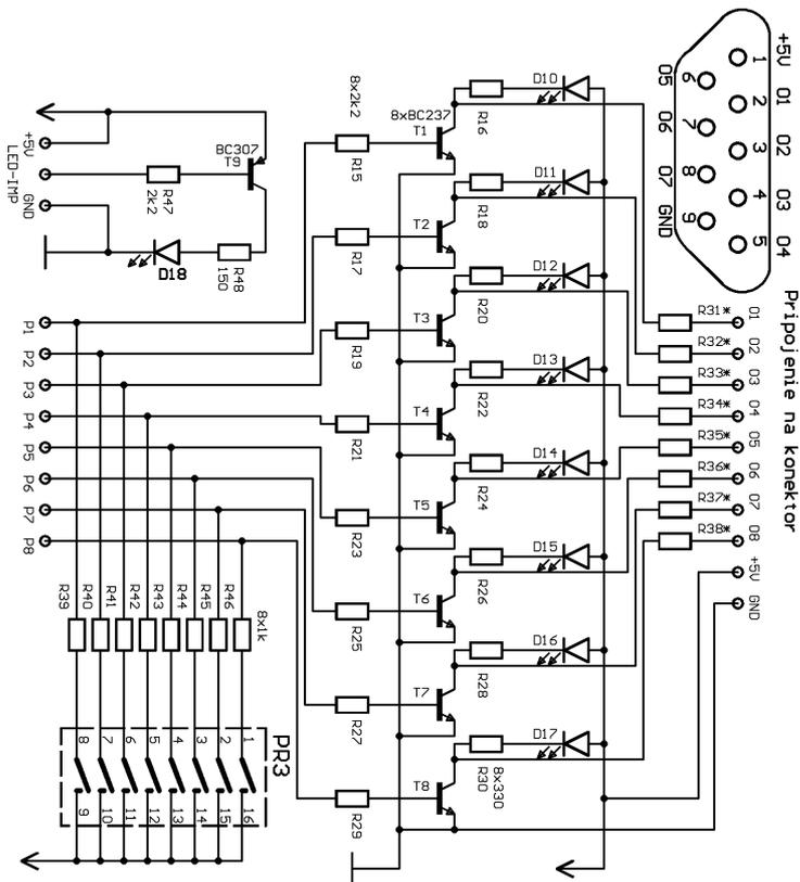
Obr.2. Schéma zapojenia bloku č. 2 – výstupné zosilovače a nastavovacie prvky
