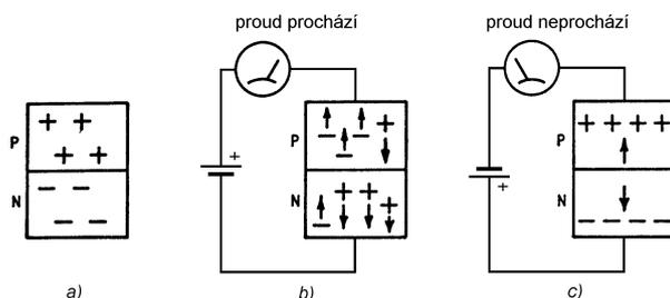
Obr. 5. Průchod proudu přechodem p-n v závislosti na polaritě připojeného napětí
