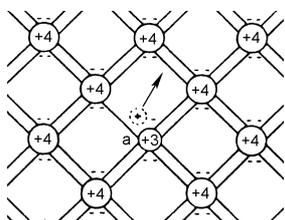
Obr. 3. Schematické znázornění krystalové mřížky s akceptorem
