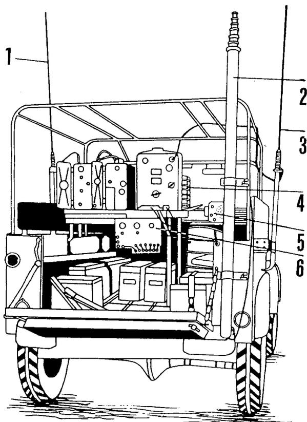
Obr. 25. Umístění soupravy R-125 v terénním voze GAZ-69: 1, 3 - pevné tyčové antény; 2 - teleskopický vysunovací stožár (Magirus); 4 - tornistr s napájecími zdroji; 5 - velitelské stanoviště; 6 - panel nabíječe (obr. 25 a 26 se vztahují k předchozí části rubriky Rádio „Historie“ v PE-AR 9/2001, s. 43)
