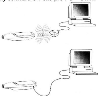
Obr. 7. S osobním počítačem se C-Pen propojí buď sériovým kabelem, nebo infraportem
