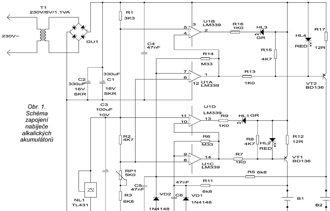
Obr. 1. Schéma zapojení nabíječe alkalických akumulátorů
