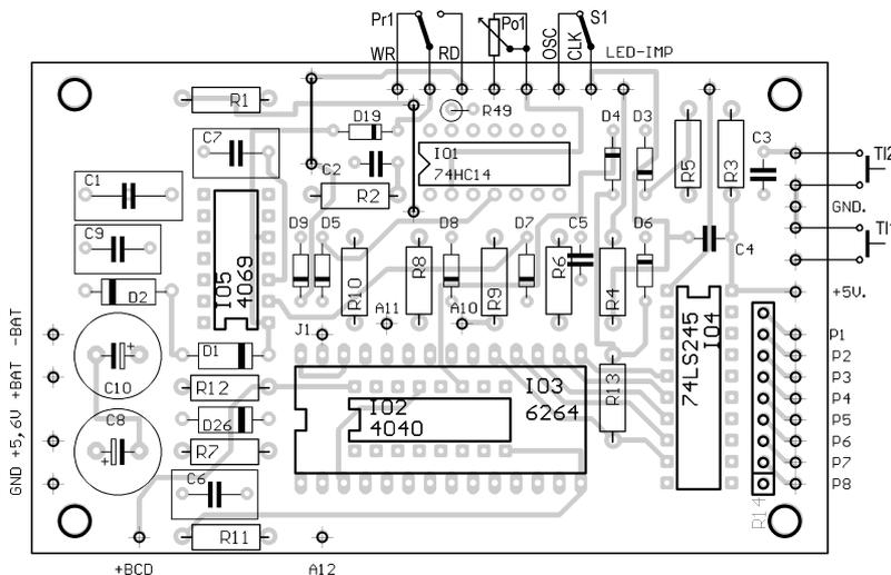
Obr. 4. Doska s plošnými spojmi pre blok č. 1: shora spodná vrstva, strana súčiastok a rozmiestnenie súčiastok
