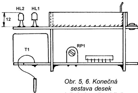
Obr. 5, 6. Konečná sestava desek s plošnými spoji nabíječe
