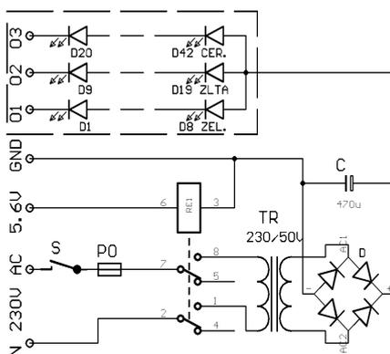
Obr. 7. Príklad zapojenia vianočnej hviezdy a pripojenie k blikaču
