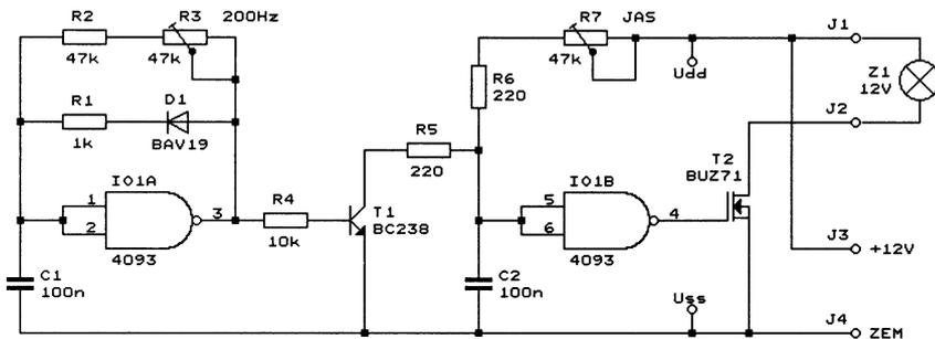
Obr. 5. Regulař jasu žárovky se ss napájením 12 V
