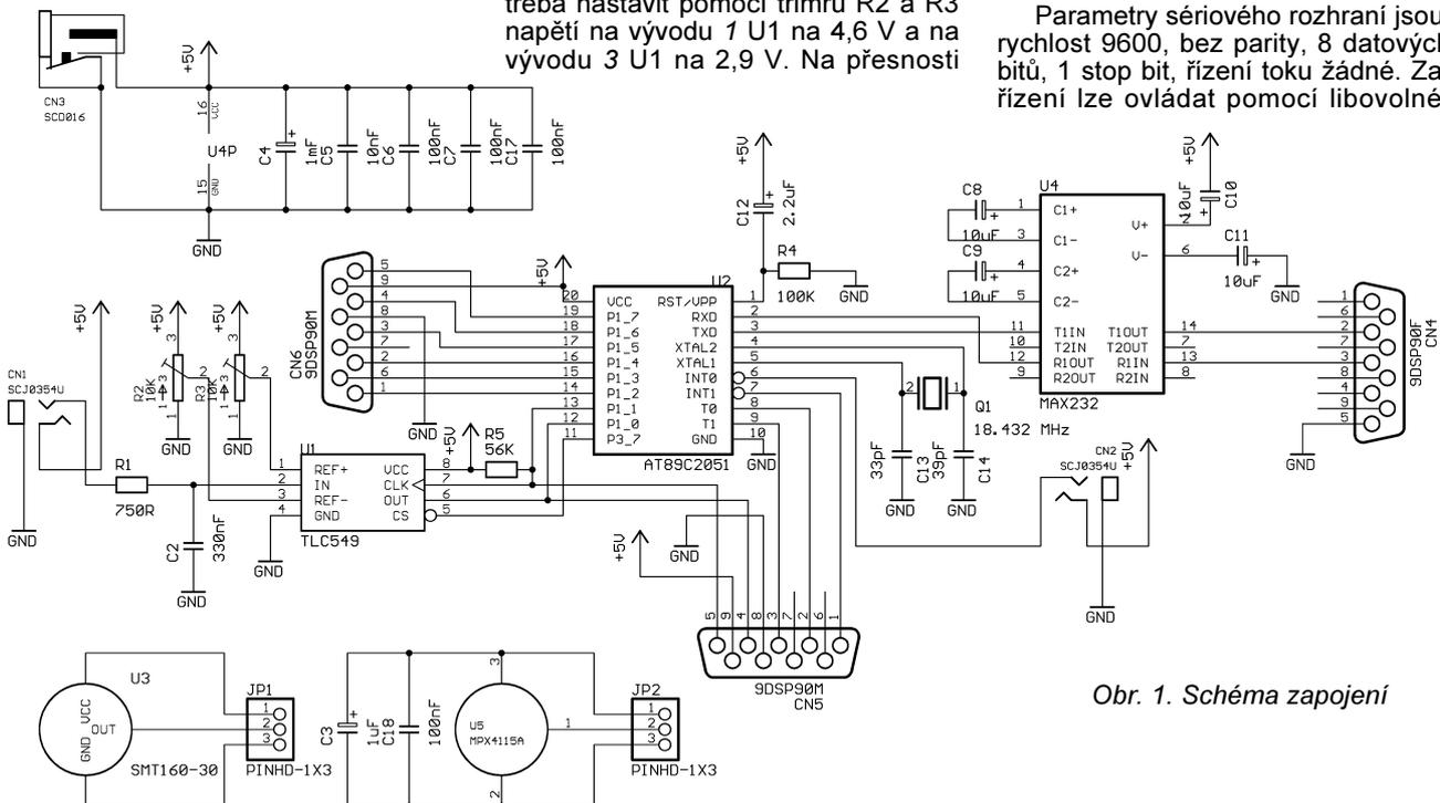
Obr. 1. Schéma zapojení
