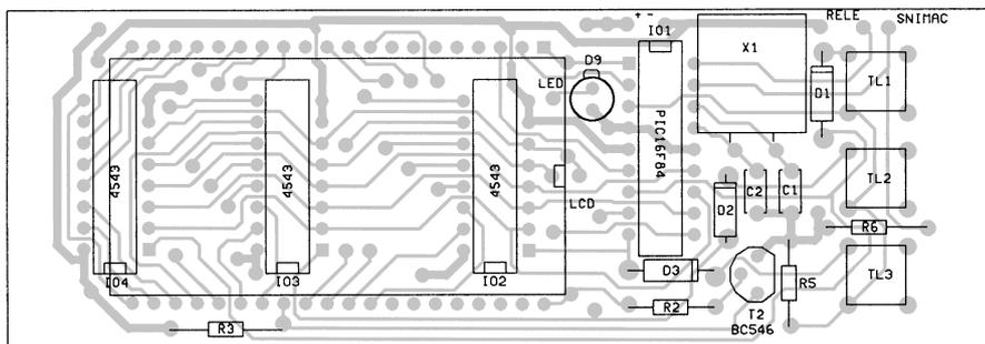
Obr. 3. Deska s plošnými spoji řídicí elektroniky
