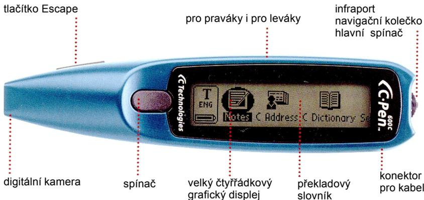
Obr. 1. Ruční skener C-Pen je malý, lehký a má jednoduché ovládání třemi základními ovládacími prvky - dvěma tlačítky a jedním otočným přepínačem s tlačítkem
