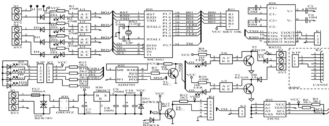
Obr. 1. Zapojenie modulu GsmMin
