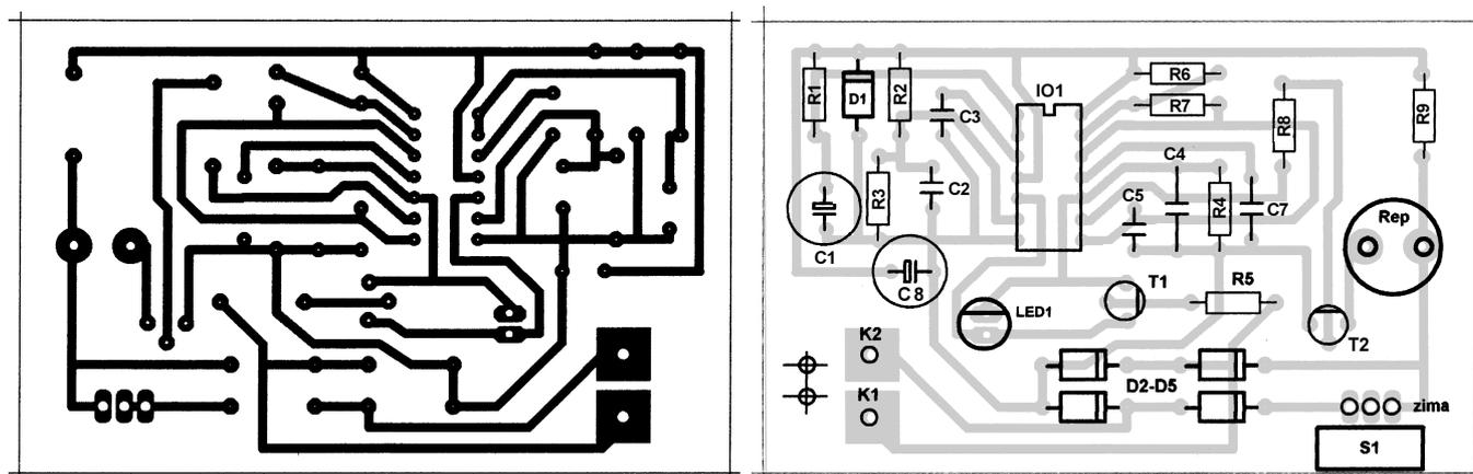
Obr. 2. Obrázec spojí a rozmístění součástek na desce hlídače světel (měř.: 1 : 1)
