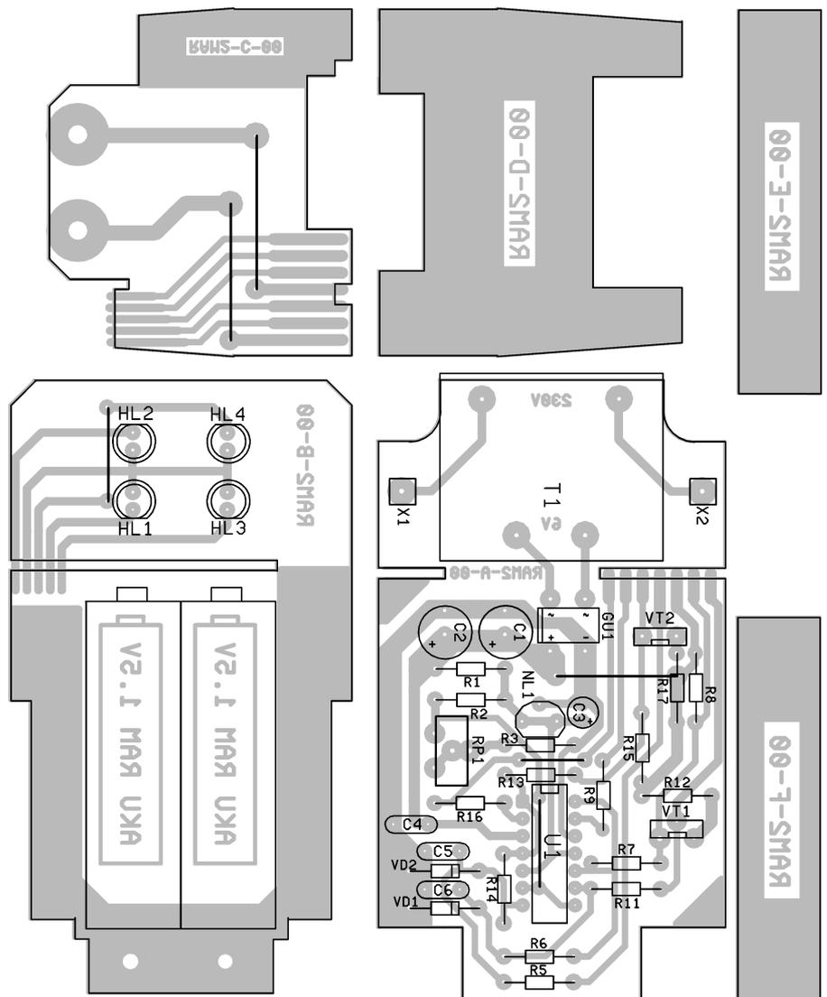
Obr. 3. Rozmístění součástek na deskách A až F
