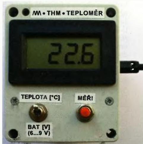
Obr. 8. Pohled na přední panel teploměru. Na pravém boku skříňky je čidlo teploty R1 v pouzdru vidlice K2V
