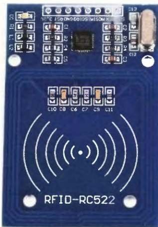
Modul má rozměry 40x60 mm
