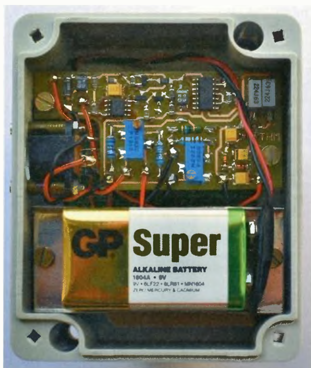
Obr. 9. Pohled do skříňky teploměru
