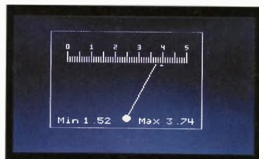
Obr. 5. Zobrazení virtuálního měřidla s pravidelně překreslovanou ručkou
