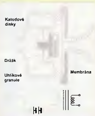
Obr. 3 Řez uhlíkovým mikrofonem E. Berlinerera
