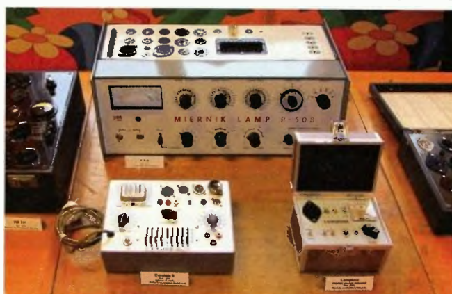
Obr. 4. Další část výstavky byla věnovaná měřícím přístrojům k měření a zkoušení elektronek. Nejstarším měřičem na výstavce byl přístroj WE 251 z r. 1938 od německého výrobce Josefa Neubergera. Na obrázku polský měřič P-508 (nahore), vlevo německý Euratele II a amatérsky zkonstruovaný cestovní zkoušeč nožičkových elektronek Lamptest (vpravo)
