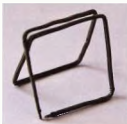
Obr. 28. Princip „srotání“ 20metrové smyčky MLA-B
