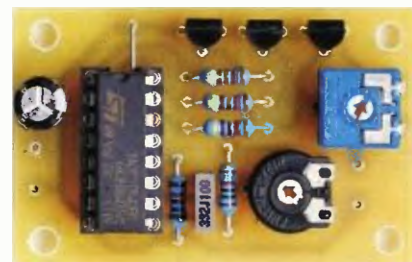
Obr. 3. Deska se součástkami výstražného zvukového signalizátoru
