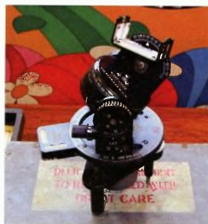
Obr. 2. Pozornost poutaly dva zajímavé přístroje: Letecký astrokompas MK II (na obrázku) a Bubble sextant Mark IX, které sloužily k určování azimutu pomocí Slunce a hvězd. Používaly je anglické i americké bombardéry během druhé světové války
