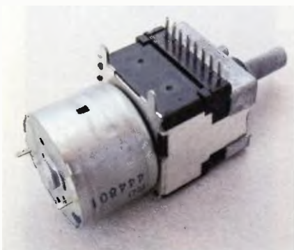
Obr. 7. Potenciometr ALPS s motorem
