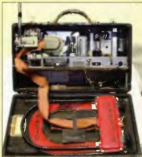
Obr. 3. Pohled dovnitř přijmače Trans-Oceanic TG605 a na jeho antény Shortwave Magnet a Wave Magnet, umístěné v zadním víku
