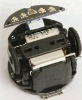
Obr. 8 a 9. Deska s elektronikou, zespodu pak pohon a deska s čidly
