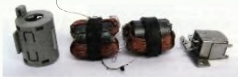
Obr. 6. Zleva: zaklapávací toroid, cívky 140 mH pro nf filtr, hlava z kazetového magnetofonu
