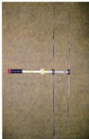
Obr. 5. Skládací anténa 2YDD pro pásmo 145 MHz, zhotovená z pokojových teleskopických TV antén
