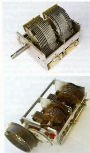
Obr. 122. Deskový ladicí kondenzátor se dvěma ladicími sekcemi a se čtyřmi sekcemi (2x SV, 2x VKV)
