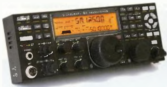
Obr. 1. Ovládací panel dálkového řízení prakticky kopíruje přední panel K3
