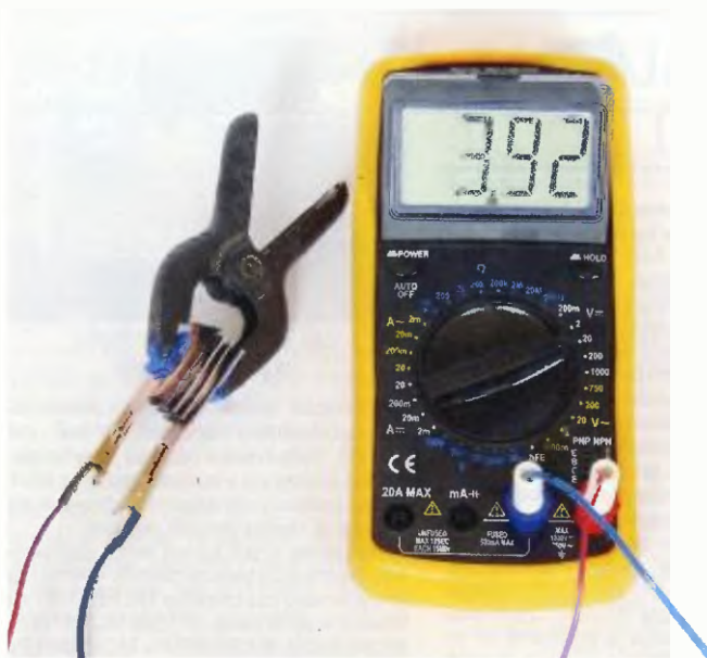
Obr. 7. Čtyřčlávková baterie z mincí a pozinkovaného plechu dodá napětí téměř 4 V
