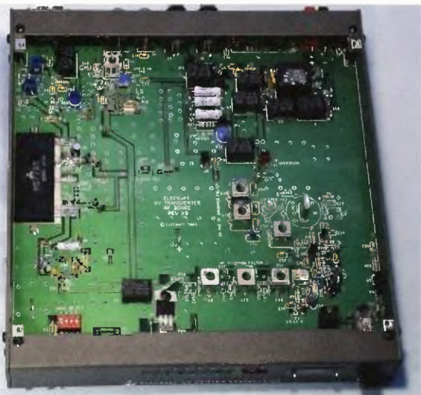
Obr. 6. Detailní pohled do odkrytého transvertoru
