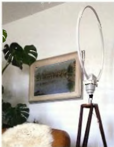
Obr. 34. Anténa MLA-ER na stojanu s rotátorem
