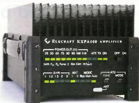
Obr. 3. 100W zesilovač a anténní tuner lze připojit k jakémukoliv QRP zařízení
