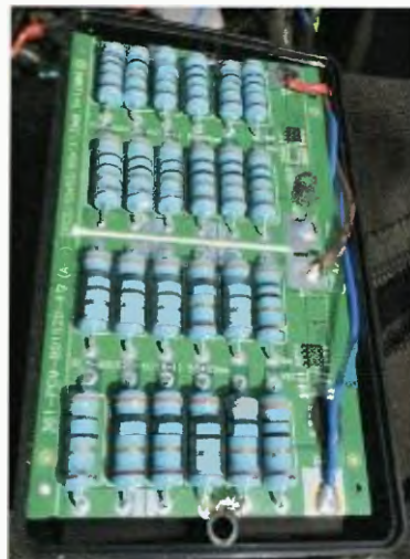
Obr. 8. Umístění a propojení balancérů
