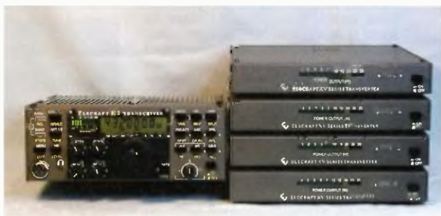
Obr. 5. Transvertory pro jednotlivá VKV pásma lze připojit prakticky k libovolnému transceiveru; v USA mají radioamatéři i pásmo 220 MHz
