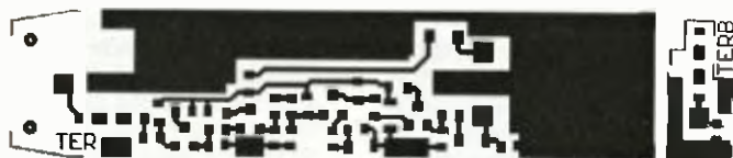
Obr. 3. Desky s plošnými spoji TER a TERB testeru rezonance (měř.. 1 : 1)
