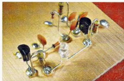
Obr. 129. Ukázka zapojení obvodu metodou „Manhattan“. Zemní konce součástek se pájejí na společnou plochu, ostatní na přilepené kuprexitové terčíky
