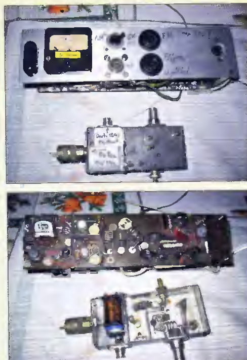
Obr. 14 a 15. S tímto vysílačem byly v sedmdesátých letech navázány stovky spojení v pásmu 70 a 23 cm. Vešel se do krabice od bot i se dvěma sadami napájecích baterií... Velmi zdařilá konstrukce
