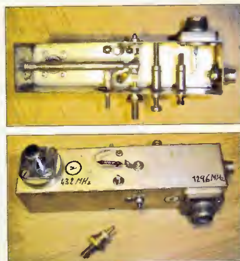
Obr. 16 a 17. Varaktorový násobič z pásma 70 na 23 cm s varikapem KA204S (varikap položen před násobičem)
