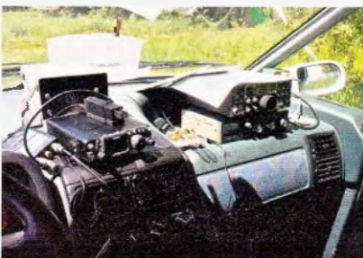
Obr. 1. Vysílací pracoviště při KV PD 2010 stanice OL0A/p, RIG Elecraft K2 a Yaesu FT-817ND s minielbugem Palm Radio. Současný provoz na KV při PD i na 144 MHz při Memorიაlu OM3AU
