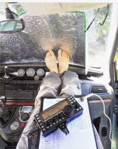
Obr. 2. Vysílací stanoviště při KV PD 2014 stanice OL0A/p, typ „pohoda“. RIG Elecraft KX3 napájený z baterie, výkon 5 W, paperlog
