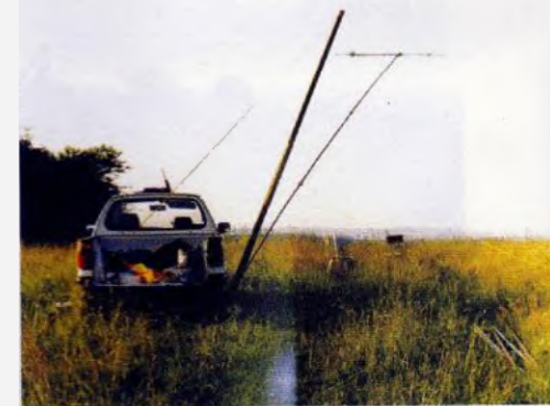
Obr. 16. Bouraná Yagi 7EY-2
