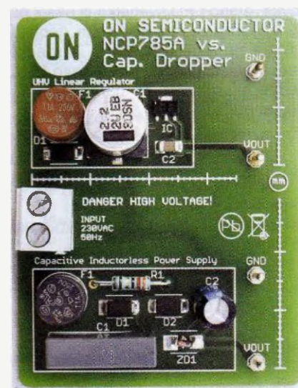
Obr. 3. Porovnání velikosti napájecího zdroje s NCP785A a zdroje se sériovým kondenzátorem
