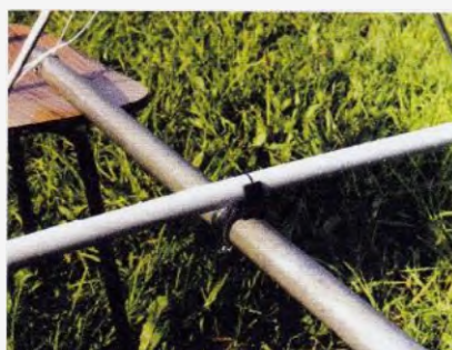
Obr. 13. Detail uchycení plastové trubky \varnothing 20 mm
