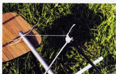
Obr. 14. Detail horního zářiče: úhelníček – 300Ω fázovací vedení – vyvázáno
