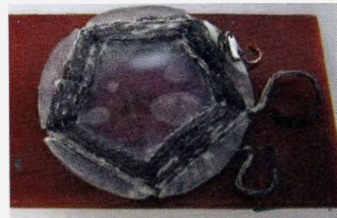
Obr. 6. Tahle cívka L1 je navinutá na průsvitné plastové formě s pěti výřezy dvěma vodiči z opředené vř 'licny' 20 x 0,05 mm, a aby bylo vinutí pevné, je štětce nřtena herkulesem, takže nevypadá nijak vábně, ale má vysoké Q e stabilní indukčnost
