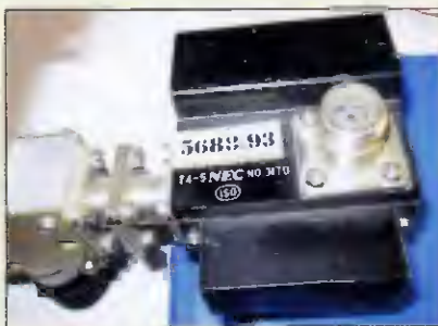
Obr. 23. Varaktorový násobič firmy NEC v pásmu 5,6 až 5,8 GHz. Nastoupily po roce 1979 za zrušené trasy RVG 958... (v současnosti jsou již patrně nahrazeny pokrokovější technologií)
