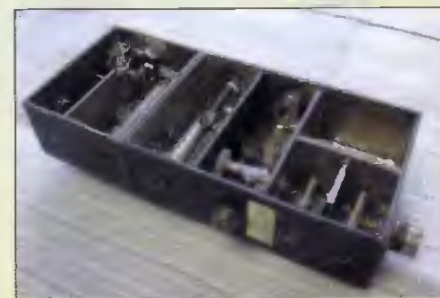
Obr. 24. Amatérský varaktorový násobič OK1AIY z 445 na 2671 MHz pro transvertor na pásmo 24 GHz (r. 1987)
