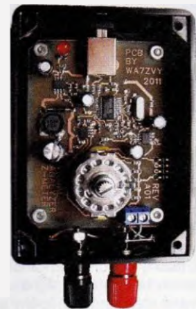
Konstrukční provedení doplňku z níže uvedeného zapojení
