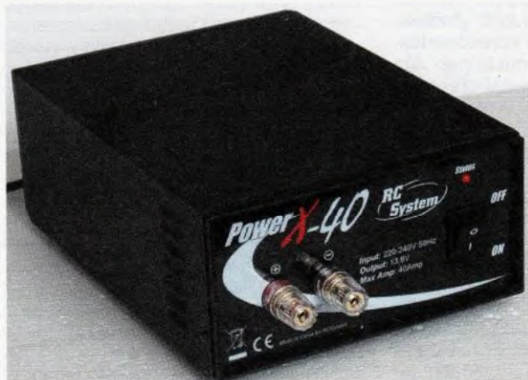
Obr. 25. Spínaný zdroj 13,8 V použitelný jako zdroj proudu 40 A
