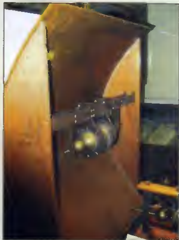
Obr. 11. Parabolická vysílač anténa Marconiho soupravy s Righiho oscilátorem (1896)
