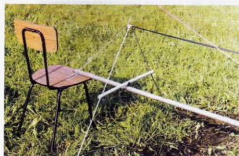
Obr. 12. Kompletní horní zářič 2 \times \lambda/2 antény 4V-2 OK2GU
