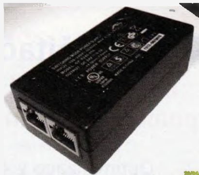
Obr. 1. Zdroj produkující nežádoucí rušení, který je dodáván v soupravě pro WiFi připojení internetu na 5,5 GHz
