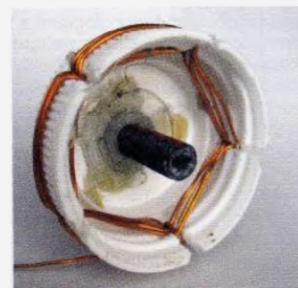
Obr. 7. Jiné možné provedení cívky L1, jak bylo popsáno v předchozí části
