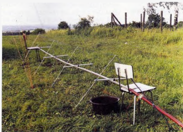
Obr. 8. Anténa 4V-2 OK2GU na montážních židlích
