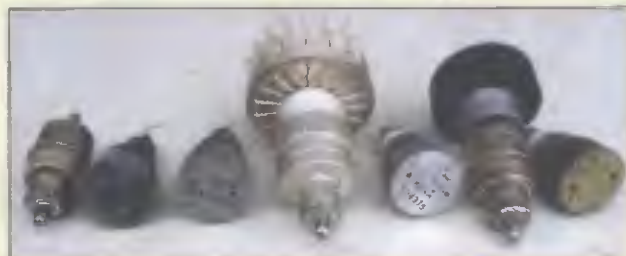
↑ Obr. 25. Výkonnější elektronky pro pásmo 23 cm
