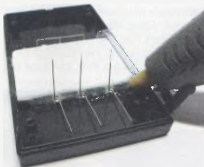
Obr. 6. Přilepení prosvětlovacích LED
