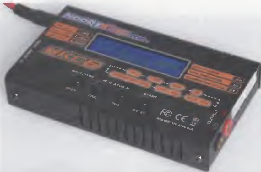
Obr. 41 Typický levný modelářský nabíječ (max. 6 článků/max. 6 A) s vyměnitelným programovým vybavením
