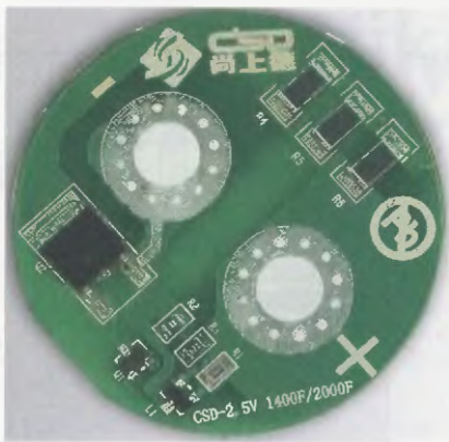
Obr. 36. Vyráběný omezovač pro jeden článěk s FET tranzistorem
