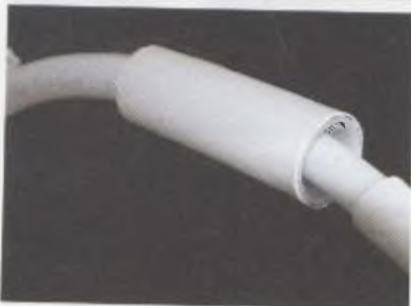
Obr. 42 a 43. Praktické provedení virtuálního kondenzátoru
