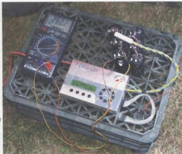
Obr. 30. „Polní“ paralelní nabíjecí sady za pomoci modelářského nabíječe
