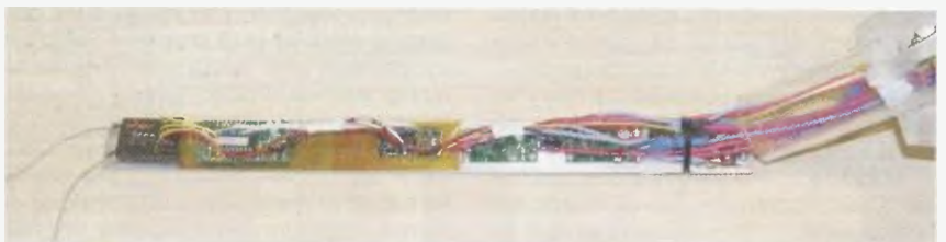
Obr. 9. Elektronika před zasunutím do hole. Z levé strany přijímač, modul Picaxe, Arduino PRO Mini, dva spínané zdroje pro LED pásky NeoPixel a úplně vpravo pod vrstvou silových kabelů FET spínač LED hlavice
