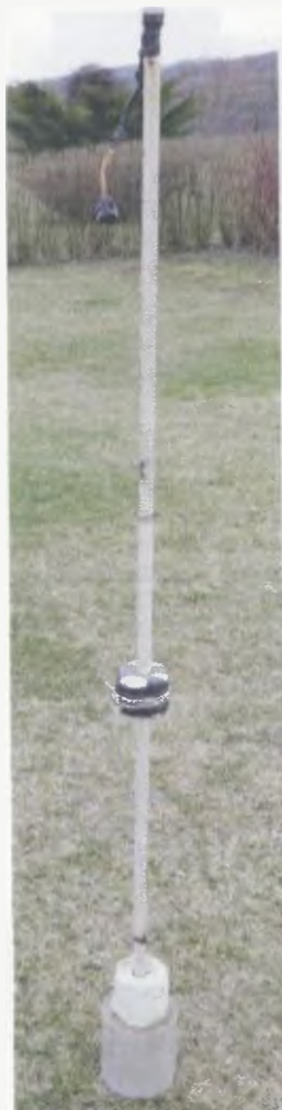
Obr. 4. Snímač hladiny s plovákem a jazýčkovými kontakty
