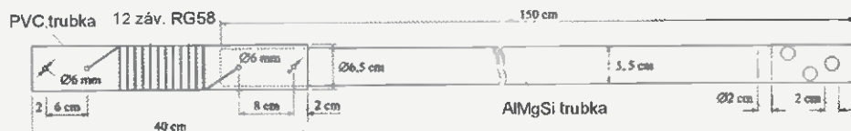
Obr. 6. Sestava horní části antény
