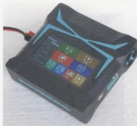
Obr. 39. 10A nabíječ X200 od firmy iMaxRC s moderní koncepcí ovládání barevným dotykovým displejem
