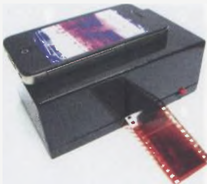
Sestavený „skener“ s vloženým filmem
