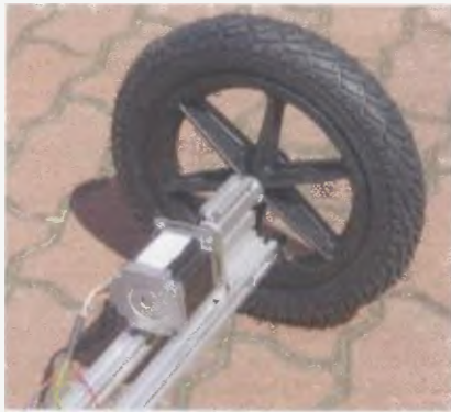
Obr. 4. Detail kola puku s pohonem
