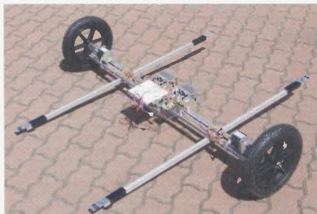
Obr. 1. Mechanika podvozku puku, chybí jen akumulátory na bílé plastové plošině a přijímač
