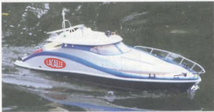
Obr. 29. Model lodí Lacaille napájený 6 ks kondenzátorů a snižujícím měničem
