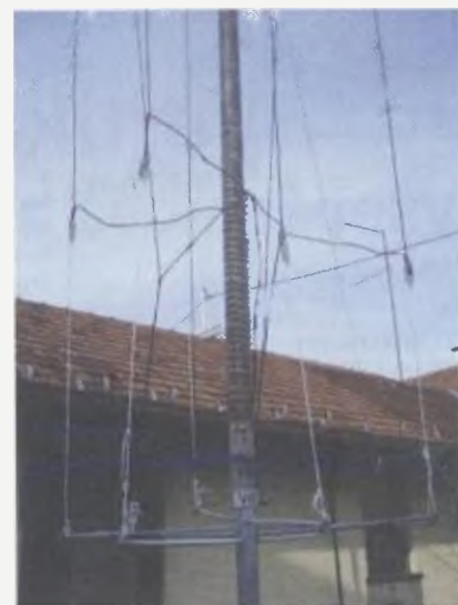
Obr. 8. Detail spodní části sestavené antény V8-9A4ZZ
