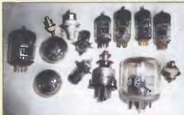
⇄ Obr. 26. Elektronky, používané pro pásmo 23 cm, QRP
