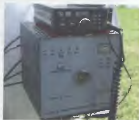
Obr. 5. Mikrovlnné zařízení OK1JHM, s výkony vysílače od 0,2 do 0,8 W, transceiver YAESU FT-290R
