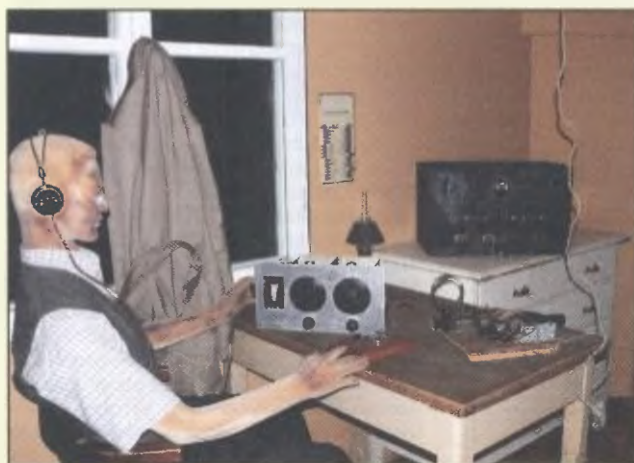
Obr. 3. Radiostanice domácího odboje. Zdrojový díl radiostanice SPARTA I, 3lampový amatérský vysílač a přijímač PENTO
