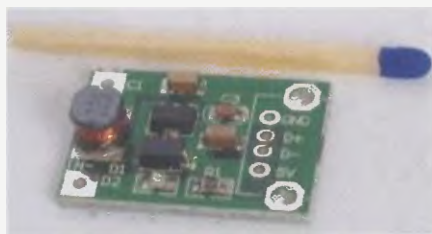
Obr. 47. Malý měnič 1 až 5 V => 5 V/500 mA
