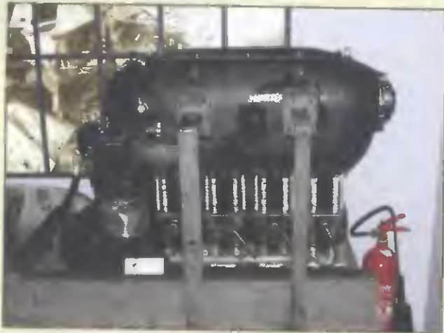
Obr. 7. Německý invertní řadový vzduchem chlazený motor Hirth HM 500 A do letounu Bücker Bü 181, vyráběný za války ve Zlínských leteckých závodech a. s.
