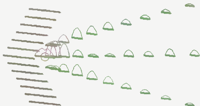
Obr. 7. Počítačové schéma antény T 416 s úhlovým reflektorem a dvojicí direktorových řad s rozvětvením 30^\circ . Proudové obložení všech prvků antény platí na kmitočtu 750 MHz ve svislé rovině (H)
