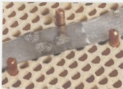
Obr. 45. Očištěné bodové svary dvou pásků konzervového plechu
