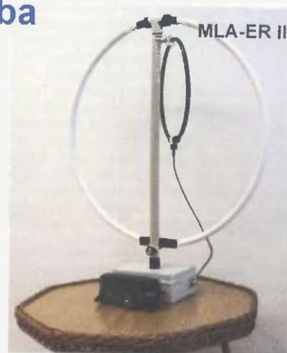
Obr. 50. Anténa MLA-ER II buzená FCC
