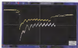
Obr. 53 Průběh napětí na autoakumulátoru při neúspěšném startování
