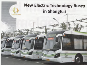
Obr. 57. Stojánka s trolejí pro elektroautobusy poháněné výhradně superkondenzátory. V roce 2010 již v Shanghai jezdilo 36. (propagační foto výrobce)
