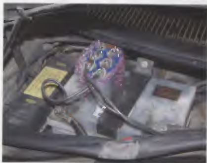
Obr. 54. Připojení kondenzátoru k autoakumulátoru
