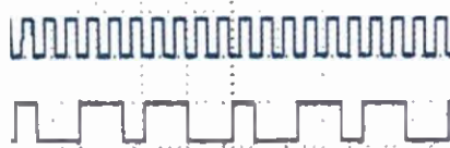
Obr. 5. Oscilogram při dělení 10/3
