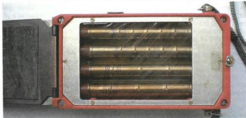
Obr. 5. Citlivý běloruský intenzimetr typu BELRAD-04-01 (belrad-institute.org) se čtyřmi GM trubicemi, vyvinutý po Černobylu, má rozsah od 0,01 do 10 mR/hod. Je určen ke kontrole slabých úrovní radiace na pracovištích a v obytných zónách. Foto: Tomáš Vizingr, www.dozimetry.eu
