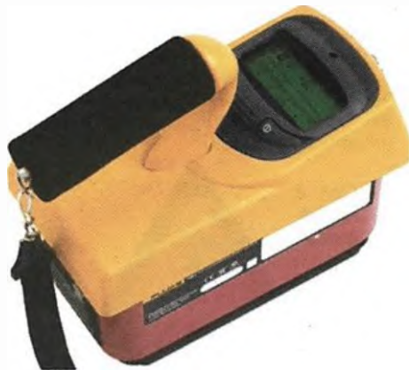
Obr. 3. Intenzimetr Fluke 481 na principu ionizační komory
