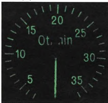
Obr. 8. Otáčkoměr z poválečné vojenské techniky s aktivně svítící (nejen fosforeskující) barvou na stupnici
