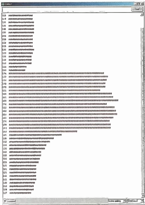
Obr. 18. Záznam z ionizační komory pořízený semigrafikou přes sériový terminál
