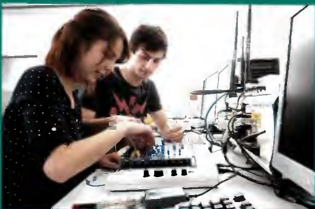
↑ Pájení a sestavování robotického brouka ze stavebnice
