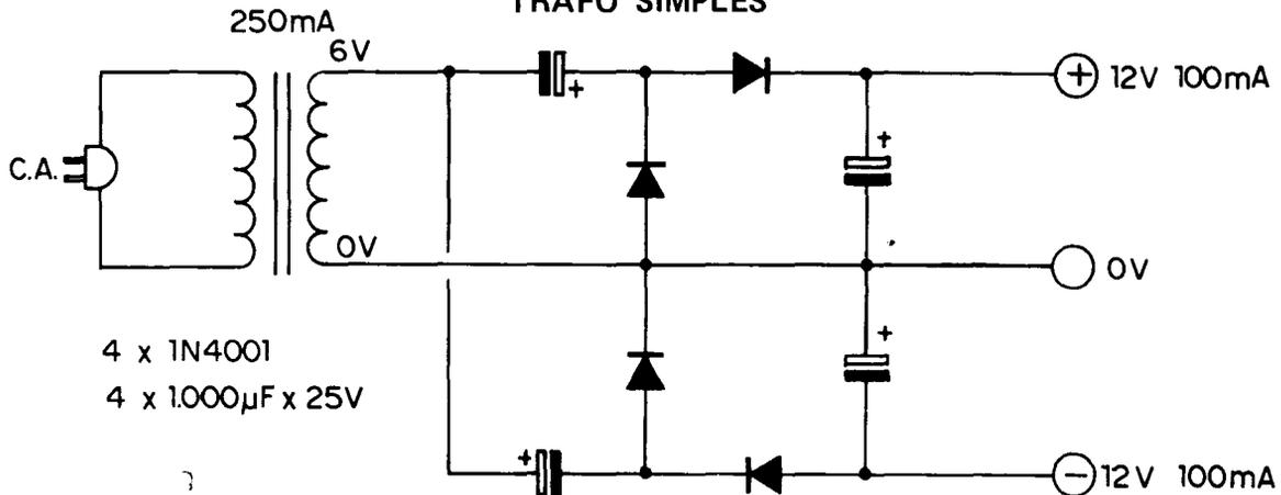
Geralmente os circuitos que utilizam Integrados Lineares do tipo "Amplificador Operacional" (741 e seus "primos"...), requerem uma fonte de alimentação **dubla e simétrica** (tipicamente capaz de fornecer +12V e -12V, com um "zero" ou "terra" central, sob algumas dezenas de miliampéres...). Isso, obviamente, não é difícil de se conseguir, a partir de um transformador cujo secundário, além de mostrar a necessária tensão, apresente uma "tomada central" (**center tap**).
