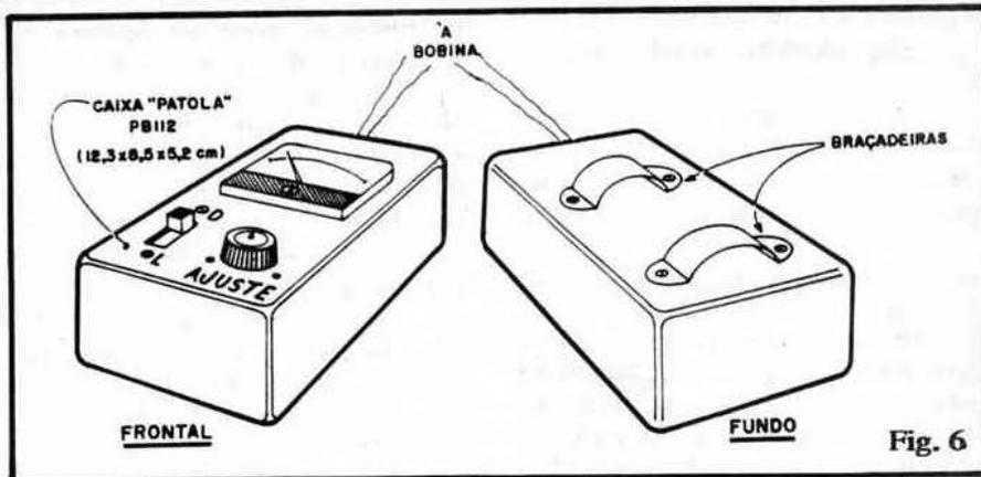
potenciômetro de ajuste e a chave interruptora geral. Numa das laterais pode ser feito um furinho para a passagem dos fios que vão à bobina sensora...
