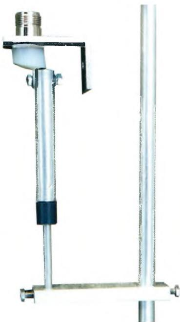
Le montage et le réglage du Gamma Match.
