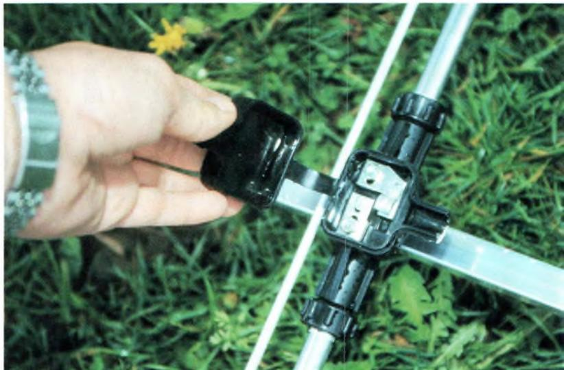
Le point d'alimentation est encapsulé dans un boîtier en polyéthylène.
