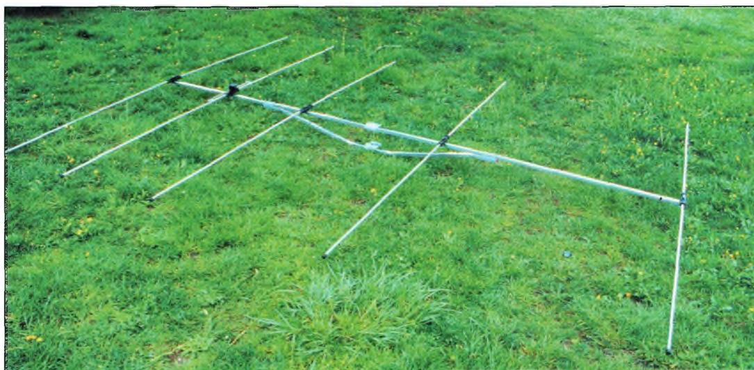
La Yagi 5 éléments 50 MHz AFT est légère et occupe peu de place.
