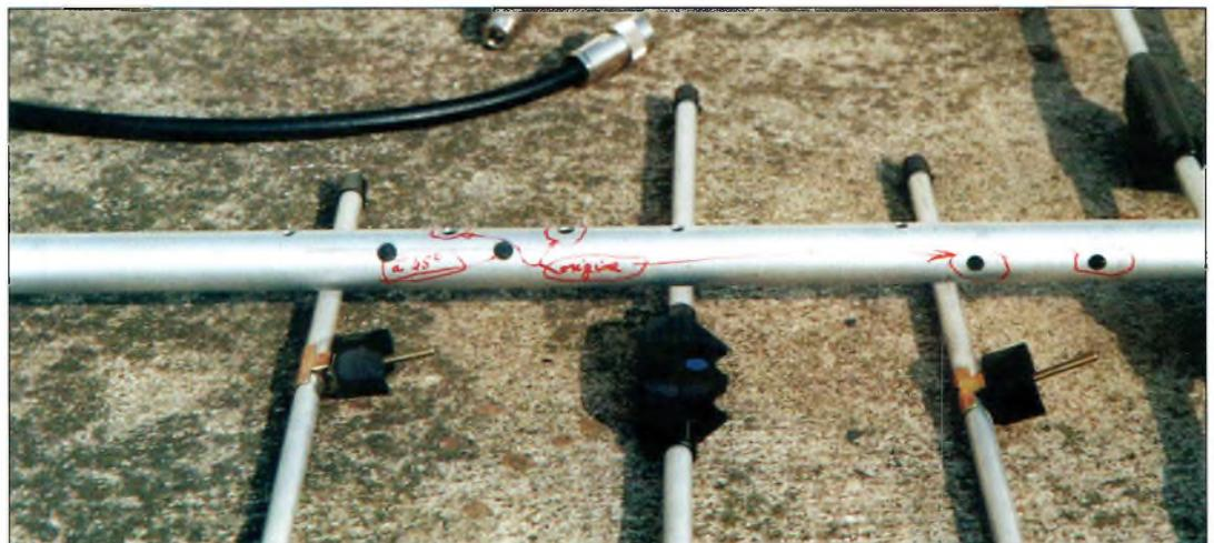
Notez les trous d'origine et ceux pratiqués à 45 degrés pour monter les antennes en oblique.
