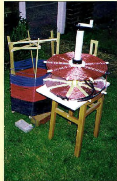
Quelques exemples d'inductances LF construites par GOMAF.
