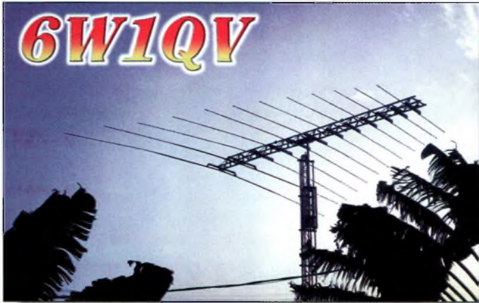
L'antenne log-périodique de 12 éléments fabriquée par Rohde & Schwarz chez Chris, BW1QV, au Sénégal.
