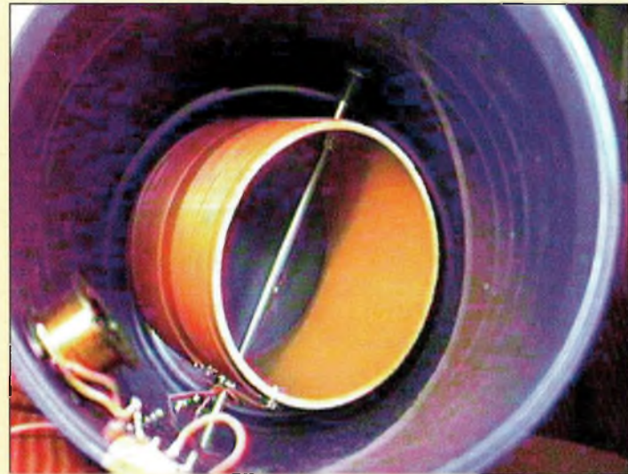
Le variomètre est indispensable si vous ne parvenez pas à installer une antenne de taille adéquate.
