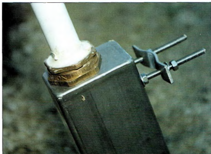
Remarquez la solidité de la liaison entre l'embase et le fouet en fibre de verre.
