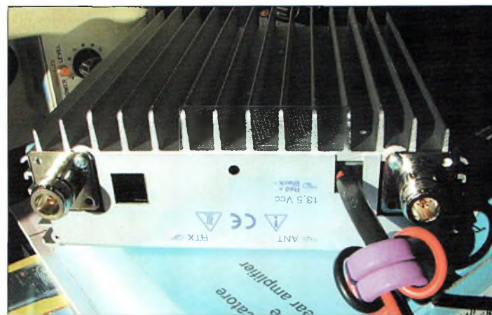
Les connecteurs N d'entrée et de sortie.
