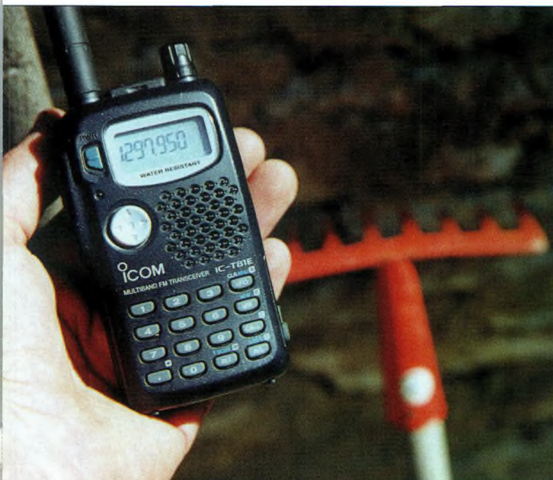
De simples récepteurs portatifs sont employés pour la détection. Ici, un ICOM IC-TB1E qui fonctionne en FM.
