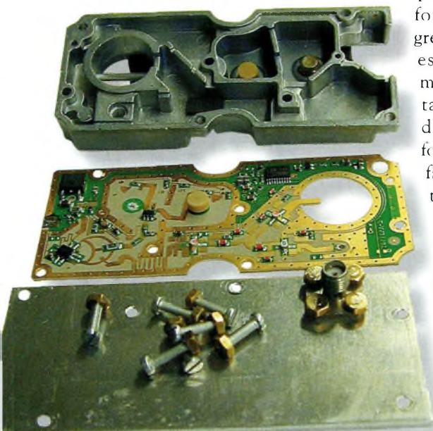
Toutes les pièces mécaniques et électroniques de la tête élaborée par F8BYC. je m'y suis
