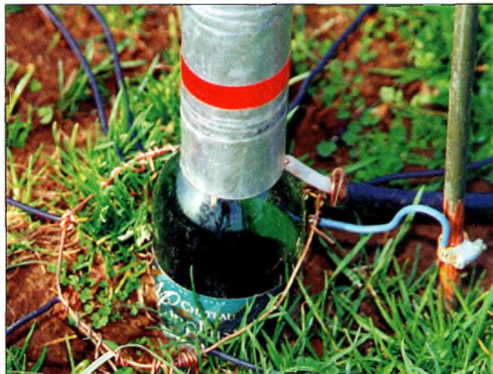
Zoom sur l'isolateur : une bouteille de Bergerac. Un Bordeaux ou un Bourgogne conviendrait aussi...
