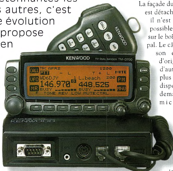
Le nouveau bibande Kenwood TM-D700 intègre un TNC pour le trafic Packet-Radio et un progiciel pour l'APRS.
