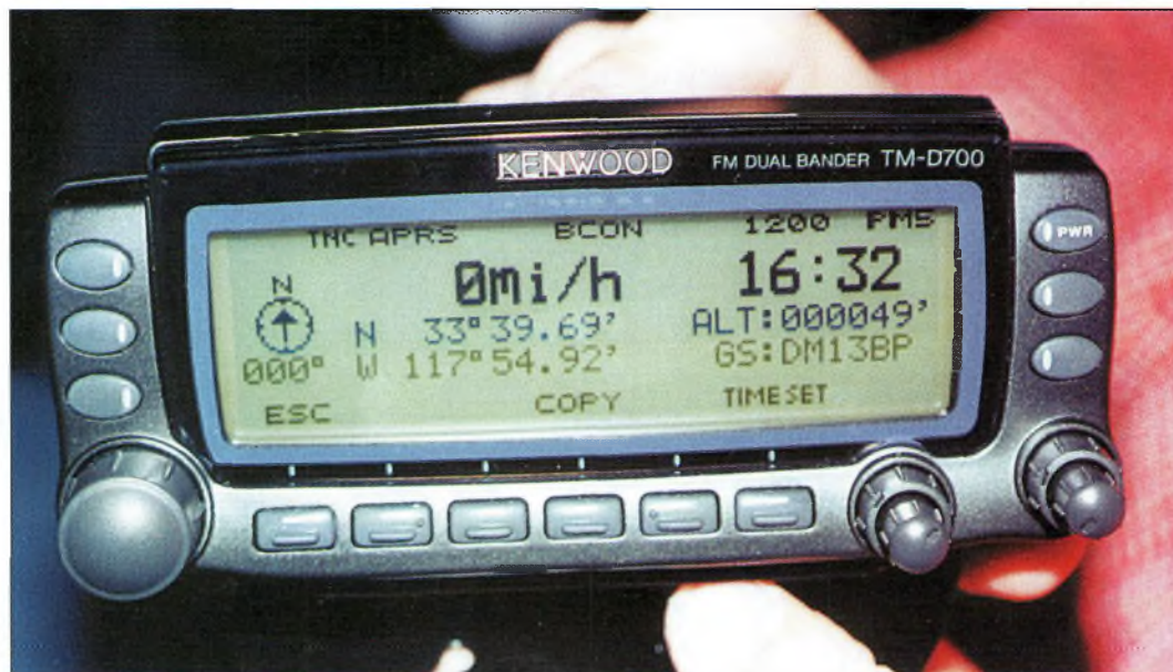
Lorsqu'un récepteur GPS est connecté, le TM-D700 affiche votre position, votre vitesse, la direction empruntée et d'autres informations comme le carré locator. Si votre récepteur GPS permet l'affichage de ce type de données.
