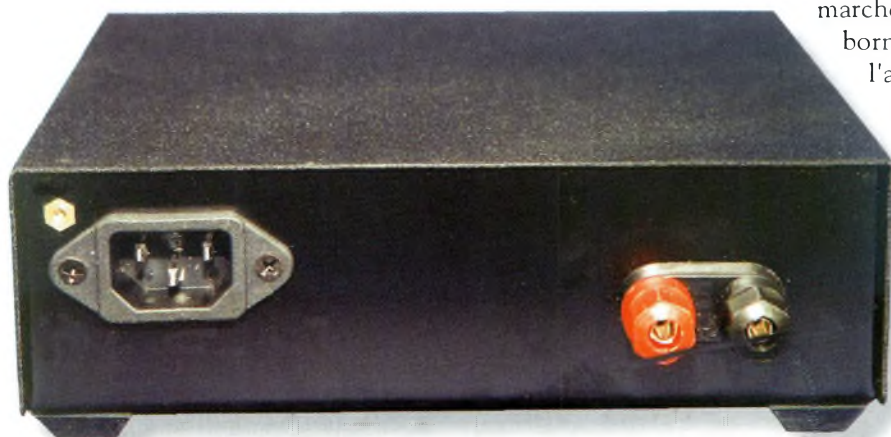
À l'arrière, les borniers de sortie et le connecteur d'alimentation AC.
