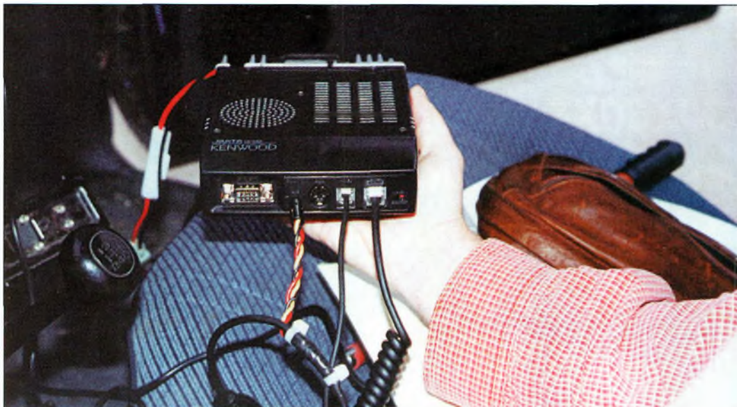
Le boîtier principal du TM-D700 peut être fixé sous le siège passager du véhicule, ou dans le coffre.
