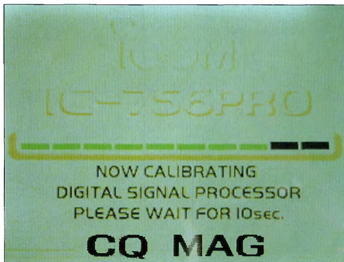
À l'allumage du 756Pro. 10 secondes de patience, le temps de l'initialisation du DSP
