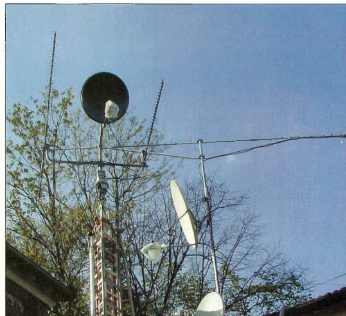
Deux mâts équipés exclusivement d'antennes Tonna sur toutes les bandes télévision du 438,5 MHz au 10 GHz. La "21 Tonna" est en haut du mât secondaire, en arrière plan.
