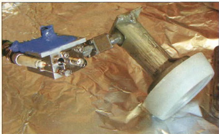
Fig. 11—Et voilà le travail, vous pouvez voir l'isolateur entre le DRO et sa transition. Ce jour-là, j'avais quand même abusé sur la pâte silicone !
