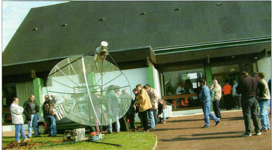
Une grosse parabole prime focus rencontrée au Cj' 2000, elle est employée pour le trafic EME.
