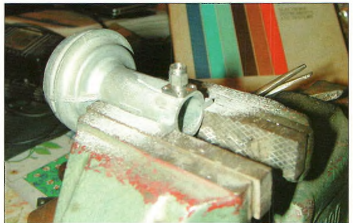
Fig. 4-Notez que le bord de la SMA et du guide d'onde est à fleur du fond.
