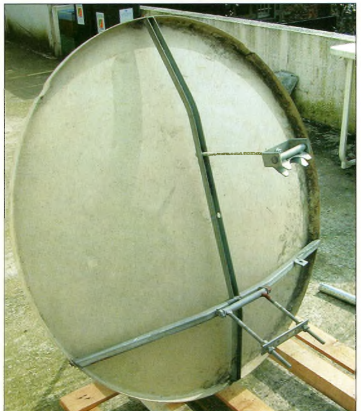
Le système de fixation modifié sur une parabole offset de 95 cm.
