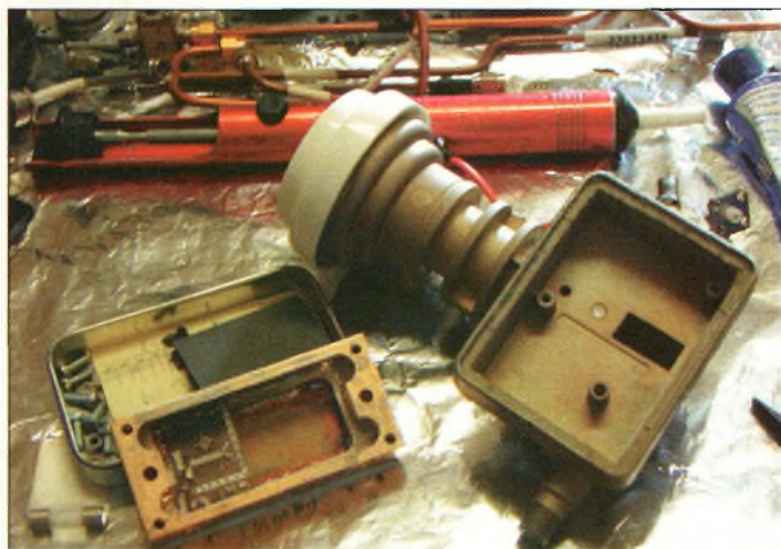
Fig. 12—À droite de l'image, un nouveau châssis de tête satellite qui va devenir une autre transition pour un autre DRO, à gauche.
