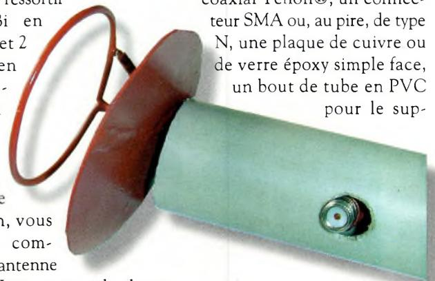
Fig. 7-Le support en tube PVC de 20/22.
