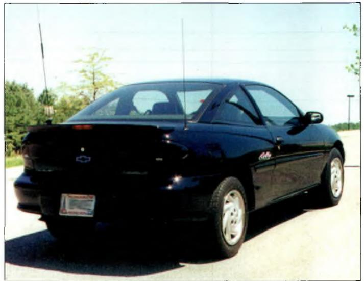
Photo A- Une installation HF mobile peut rester relativement discrète si les choses sont faites correctement. Préférez une grande antenne pour un meilleur rendement, et placez toute bobine au-dessus du niveau supérieur de la voiture.
