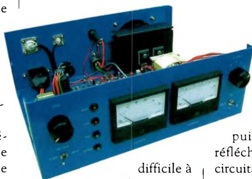
L'émetteur de 300/400 watts 136 kHz conçu par GØMARF.
