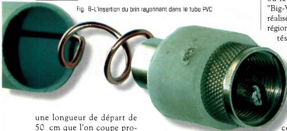
une longueur de départ de 50 cm que l'on coupe progressivement en regardant le ROS-mètre. Pour une fréquence de 144,150 MHz, on doit arriver à quelque chose comme 49 cm. Sachez que cela ne sert à rien de rechercher la petite bête pour ces réglages.
