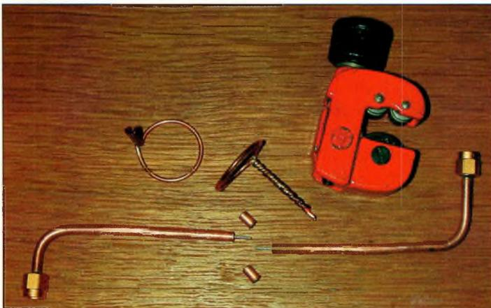
Fig. 10-Sous-ensembles des antennes 2 300 MHz.
