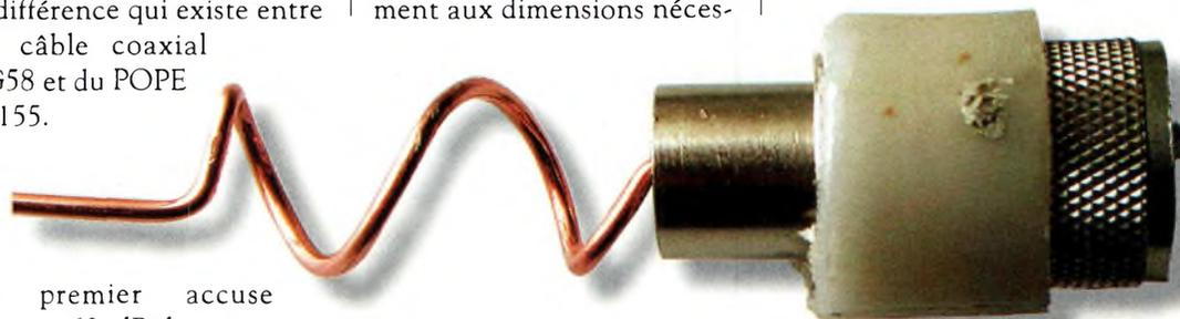
Fig. 5-La self de l'antenne ne doit pas toucher la masse, on peut la bloquer avec un peu de colle époxy.
