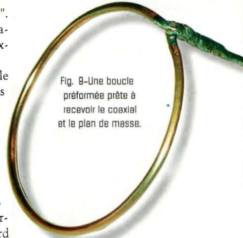
réaliser la version quart d'onde DDRR entre 1,8 et 432 MHz.
