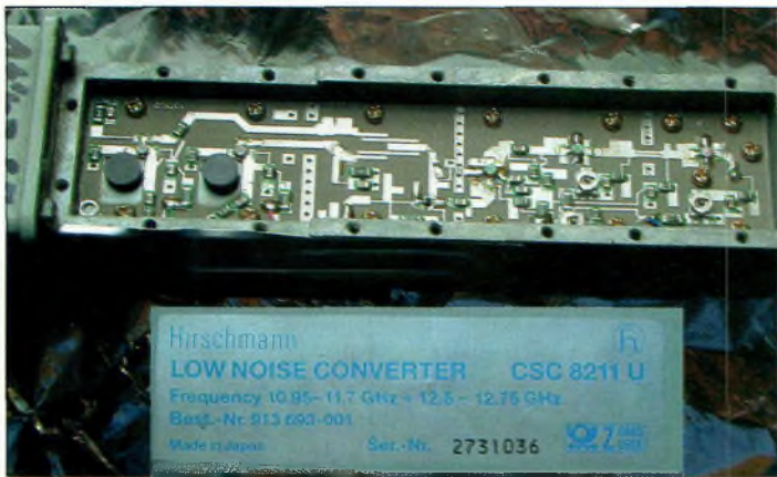
Voici tous les ingrédients nécessaires pour réaliser une tête d'émission sur 10 giga, coût de l'opération, environ 50 francs.
