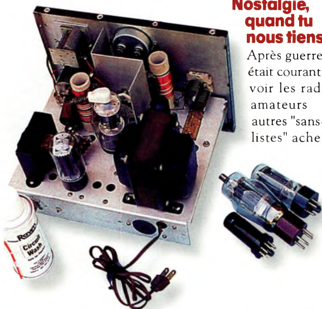
Photo A- Lorsque l'appareil est en bon état, il suffit parfois de remplacer les tubes et les condensateurs pour que l'appareil renaisse de ses cendres. Une bombe aérosol pour nettoyer les contacts électriques est aussi indispensable dans la majorité des cas.
