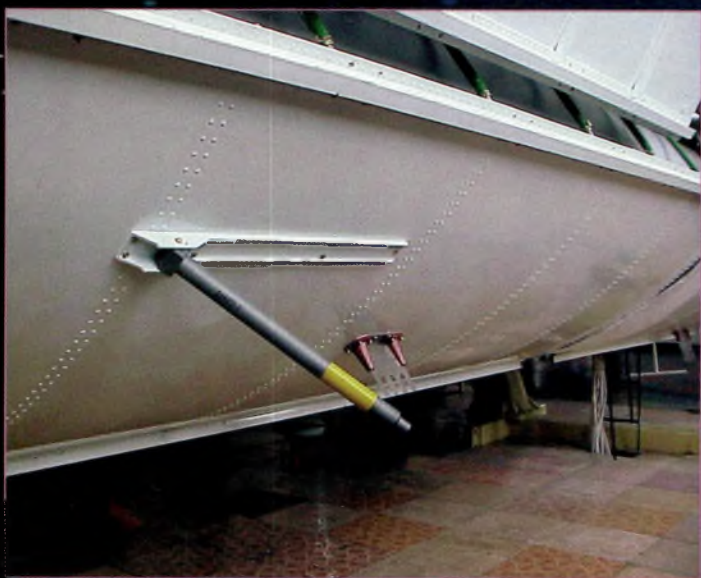
L'antenne Sirius qui sera utilisée pour les premières liaisons VHF. (Photo Lou McFadin, W5DID)
