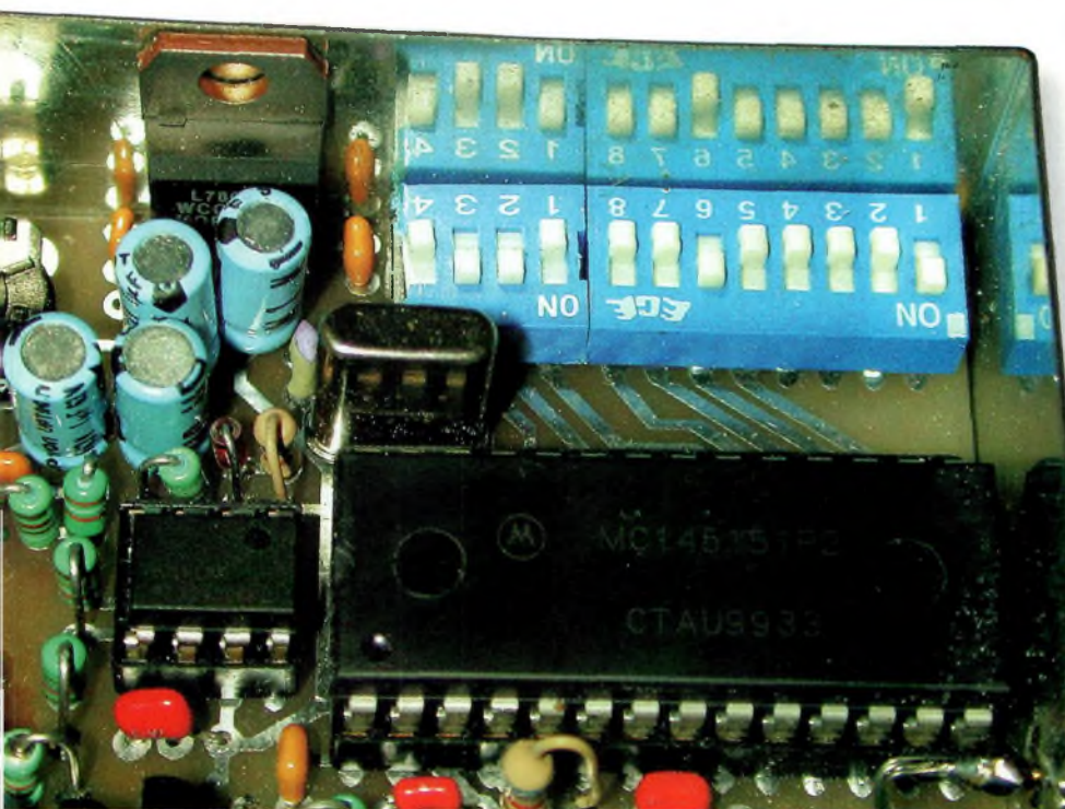
Peu de composants forment la partie synthétiseur de fréquence.
