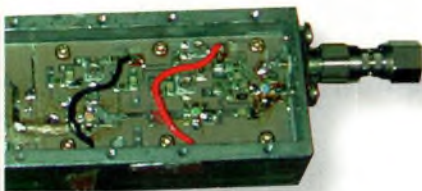
Les fils d'alimentation de l'amplificateur.
