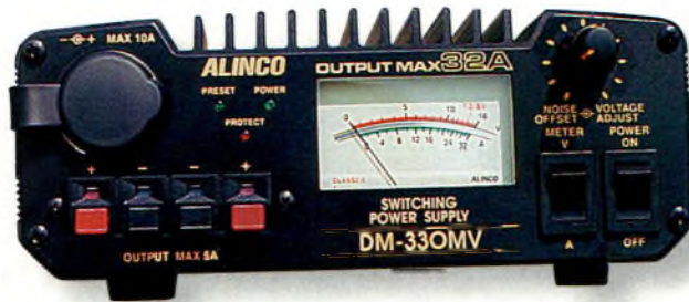
Vue de la façade du DM-330MV d'Alinco. L'indicateur de courant et de tension est commutable pour passer d'une mesure à l'autre.
