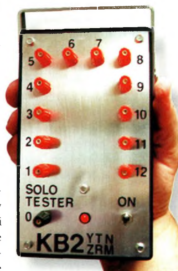
Le testeur de câbles prêt à servir pour un tas d'applications.
