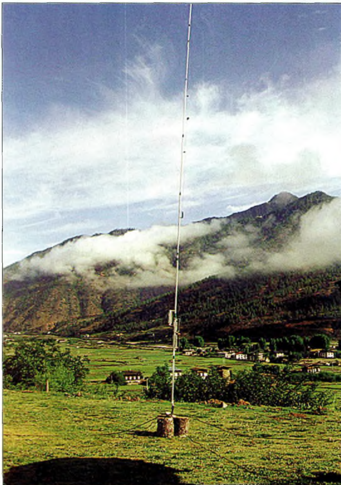
Dans de tels endroits, une simple antenne verticale suffit. Ici, on aperçoit la Butternut HF6V. Une antenne filaire a également été utilisée.
