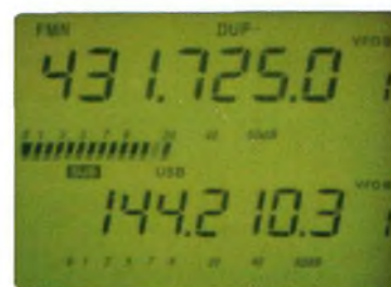
Le Smètre reste précis et l'affichage des fréquences est très lisible avec de gros chiffres.
