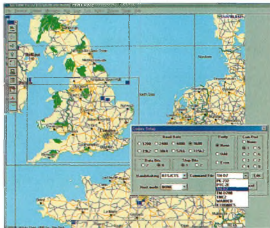
Fig.3- Le panneau de configuration permettant au logiciel Uiview de se connecter sur l'interface radio, ici un TH-D7 ou un TM-D700 de Kenwood.
