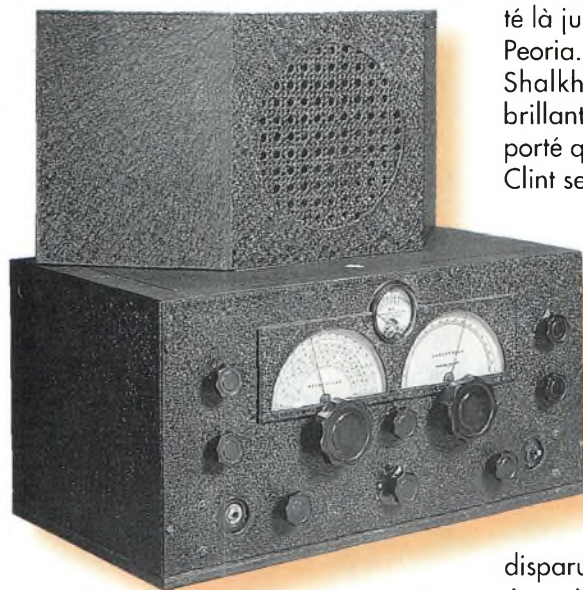
Le récepteur RME-69 présente un panneau avant un peu déroutant pour le nouvel utilisateur ; aucune commande n'est indiquée !
