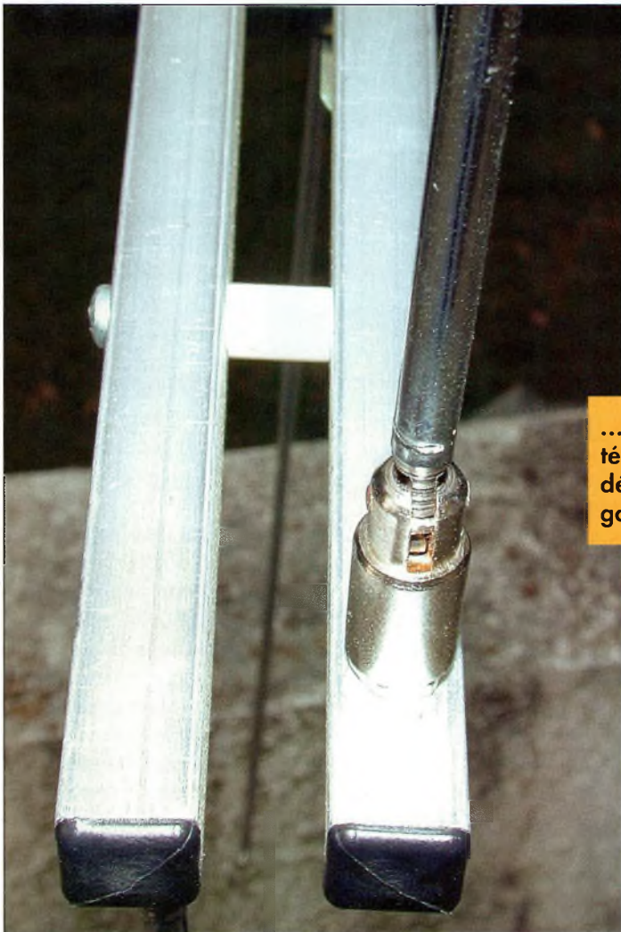
Les brins télescopiques s'articulent autour d'un axe pour permettre le rangement facile de l'antenne HB9CV.
