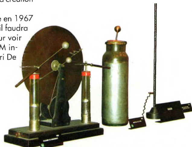
Les premières productions d'électricité n'était pas une chose facile, la machine de Wimshurst et la bouteille de Leyde.
