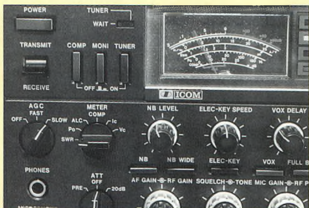
Photo B - Les intégrés de ICOM et les tuners d'antennes automatiques sont analogiques avec des moteurs réglant des condensateurs variables.
