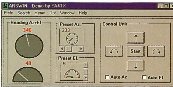
Le panneau de contrôle de ARS.
