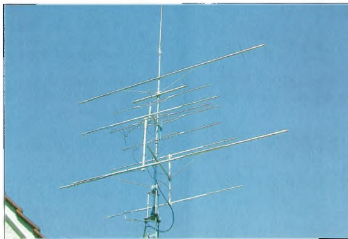
Les antennes de Franck, 4 fois 11 éléments grand espacement sur 144 DXSR pour la BLU, 4 fois 21 DXSR en 432 puis enfin, 4 fois 35 éléments Tonna sur 1296 MHz. Une antenne verticale bibande et une 3 éléments 28 MHz émergent de l'ensemble.
