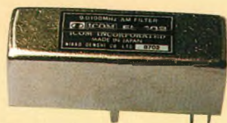
Photo B - C'est un filtre à quartz enfichable optionnel utilisé pour maintenir la réception AM avec un transceiver ICOM. Il opère à 9 MHz environ et a une bande passante de 6 KHz. La plupart des filtres SSB et/ou CW optionnels paraissent identiques mais ont des bandes passantes plus étroites.
