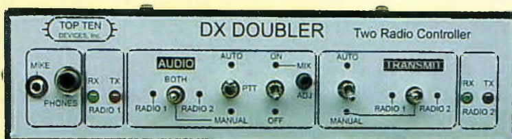
Le DX Doubler (DXD) prend le contrôle de deux radios. Boîtier de commande de deux radios (SO2R). Branchez vos écouteurs, votre micro, votre manipulateur et votre commutateur à pied dans le DXD, connectez le DXD à vos radios et vous voilà prêt à opérer. La photo représente la disposition de la façade avant qui est très ergonomique.
