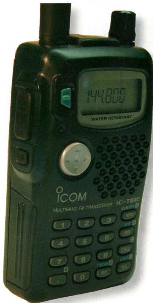
Le navigateur permet de sélectionner les menus, de changer de bande et modifier le volume sonore.
