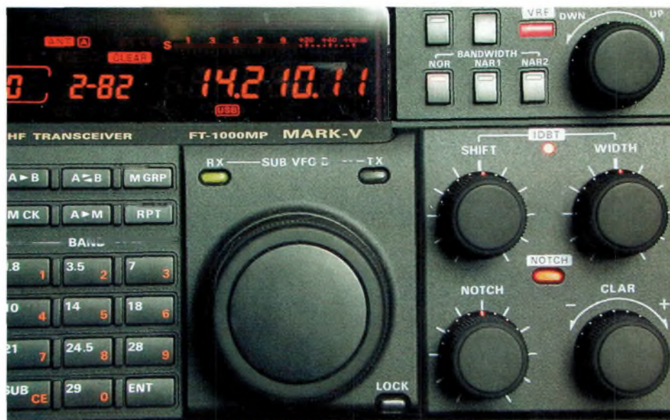
Bien qu'indépendant, le second récepteur subit les réglages du récepteur maître.
