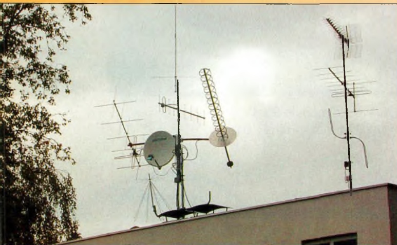
Les antennes de Florian, F4BIX, la croisée 144, l'héliostatique 435 et 2300 servant de source à la parabole sont home made.
