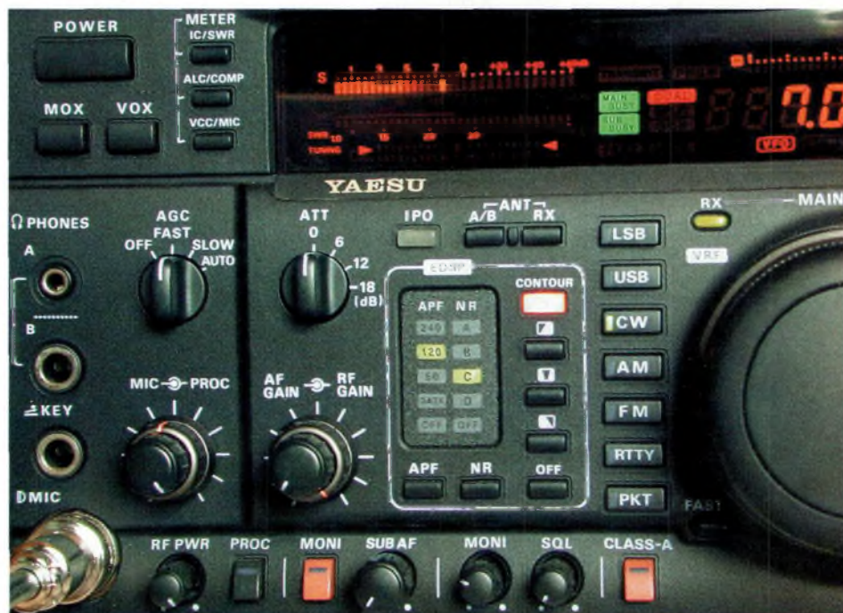
En dessous du 5mètre l'un des deux indicateurs sert à vérifier le courant, l'ALC, le ROS, le niveau micro, etc. L'autre offre la particularité de surveiller l'accord de la boîte automatique.
