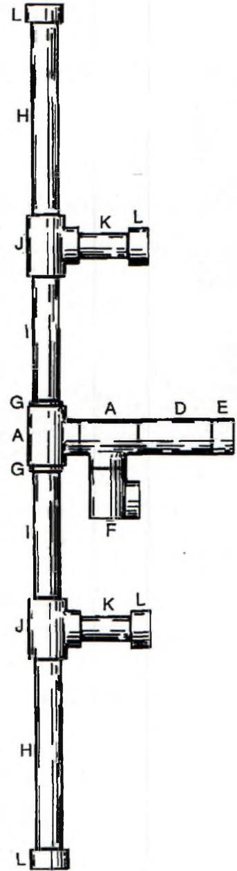
Figure 5. Schéma d'assemblage des tubes pour la colinéaire quatre éléments. Voir la figure 6 pour l'assemblage des parties A à G.
