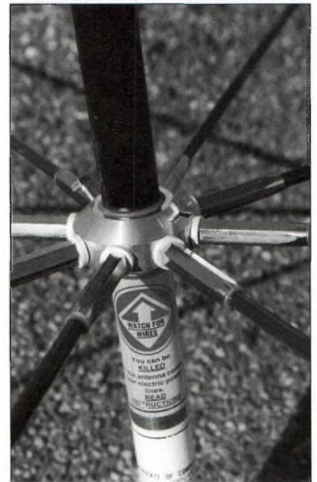
Photo 2. La fixation du collier supportant les radiaux peut sembler sommaire, mais au moins, le système a le mérite d'être robuste !
