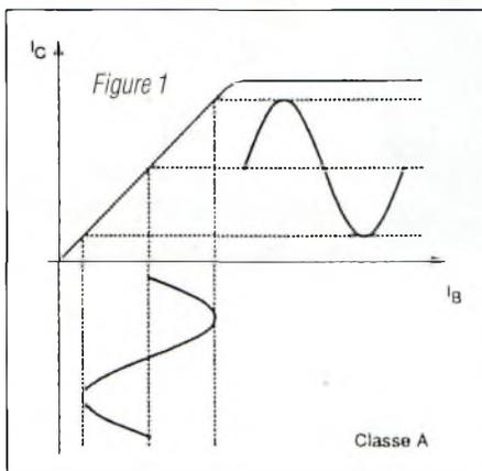
Les amplificateurs de classe A dont la linéarité est excellente, sont utilisés pour amplifier les signaux BF et HF. Par contre, le rendement de l'amplificateur (puissance HF fournie divisée par la
