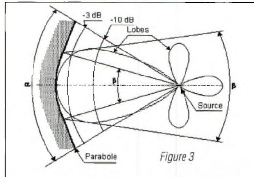
rayonnement (figure 3), qui, en pratique, correspond à une chute de signal de moins 10 dB. Si le diamètre de la parabole est supérieur à la ligne des -10 dB, la partie supplémentaire est inutile.
