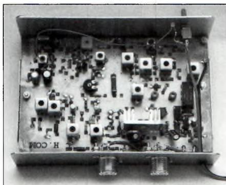
Les composants sont montés sur un circuit imprimé à double face. La réalisation reste relativement simple. Pour la version en kit, les débutants se feront aider par un technicien confirmé.
