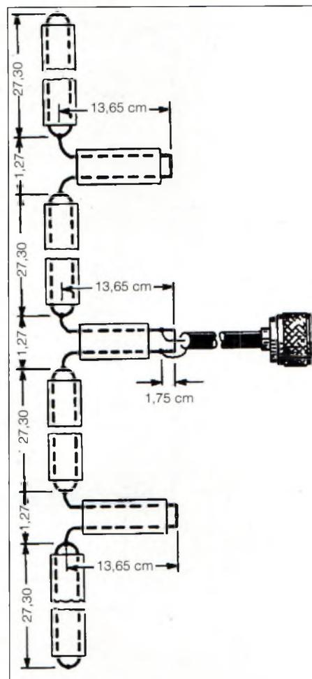
Figure 3. Schéma électrique de la colinéaire à quatre éléments.
