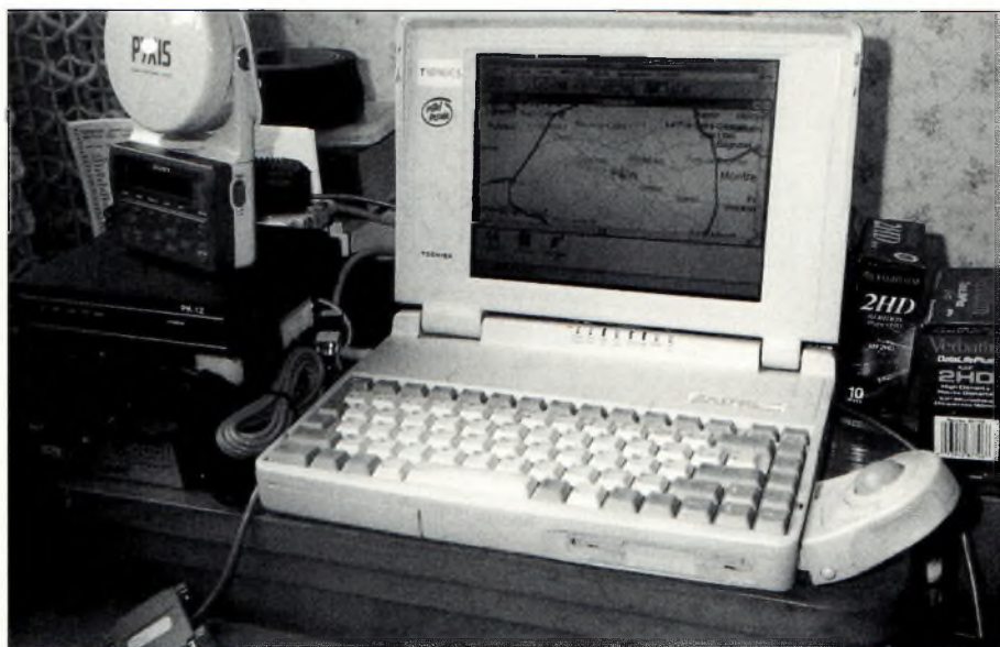
L'équipement du parfait chasseur. Un PC portable, un PK12, un récepteur GPS, un transceiver et APRS de WB4APR. Grâce au firmware AEA, inclus dans le PK12, le GPS entre dans les stations Amateurs.
