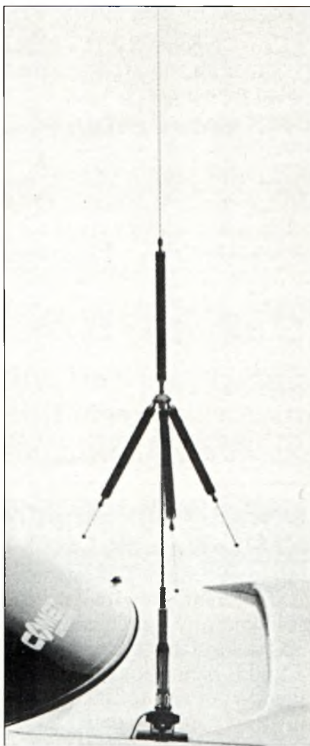
L'antenne HF mobile COMET HA-4S ne mesure guère plus de 1,20 mètres de haut !
