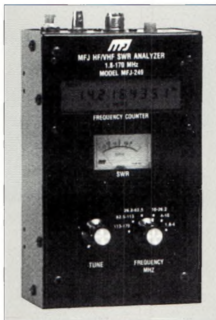
Le MFJ-249. Les connecteurs mentionnés dans le texte sont partiellement visibles sur le dessus de l'appareil. L'écran LCD donne une lecture précise de la fréquence. Le vumètre sert pour la lecture du ROS.
