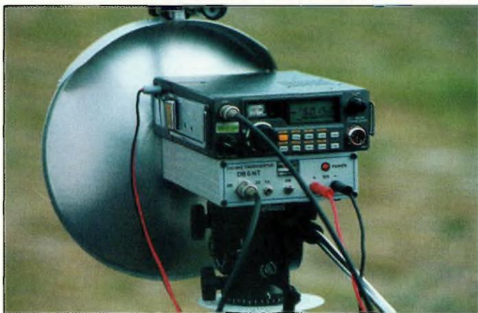
Transverter 241 GHz de DB6NT. (Photo F1OIH).
