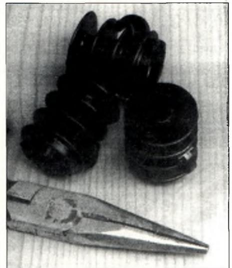
*Photo 1. Des isolateurs comme ceux utilisés pour les clôtures électriques sont très pratiques pour installer des lignes bifilaires. Des lignes de 450 ohms s'intègrent parfaitement entre les cercles. Deux isolateurs sont nécessaires pour supporter des lignes plus larges.*
