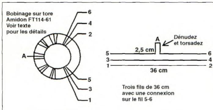
Figure 2 - Schéma de bobinage de la tore.
