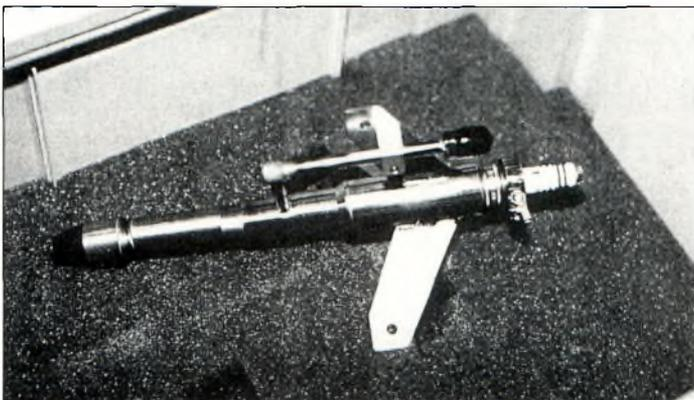
Correction d'orbite : le moteur plasma de Phase3D.
