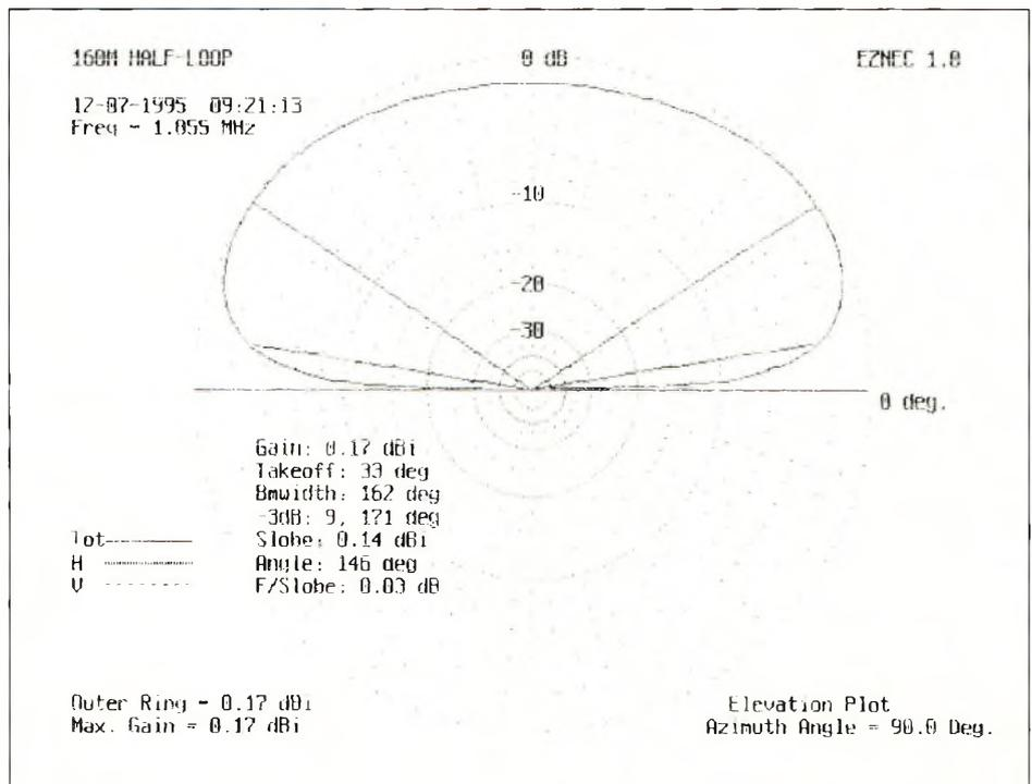
Figure 1B. Diagramme de rayonnement vertical montrant l'angle de départ sur 160 mètres.
