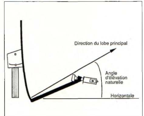
Figure 6 - L'axe de réception est décalé avec une antenne offset. Le lobe principal et la perpendiculaire forment un angle appelé "élévation naturelle".
