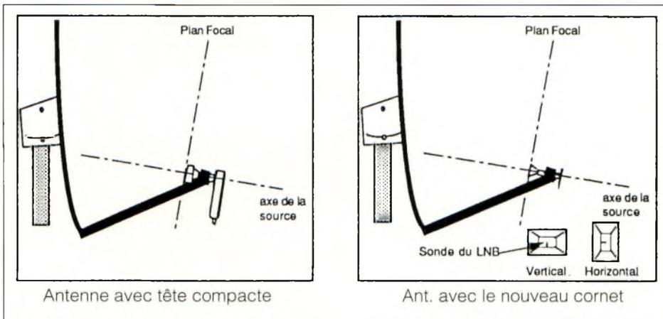
Figure 9 - Il est nécessaire de conserver l'axe de la source initiale et le plan focal.
