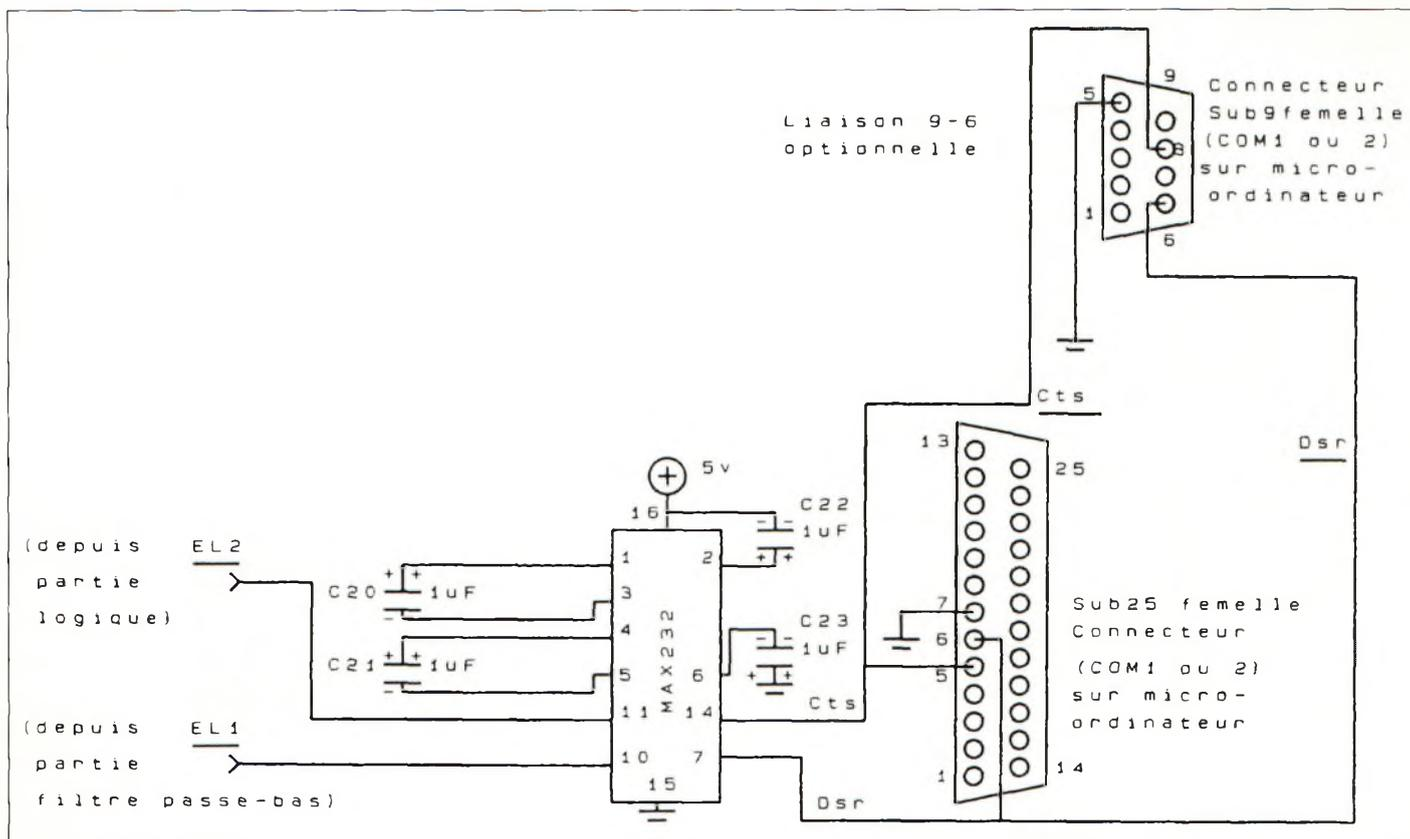
Figure 1. Schéma de l'interface série.
