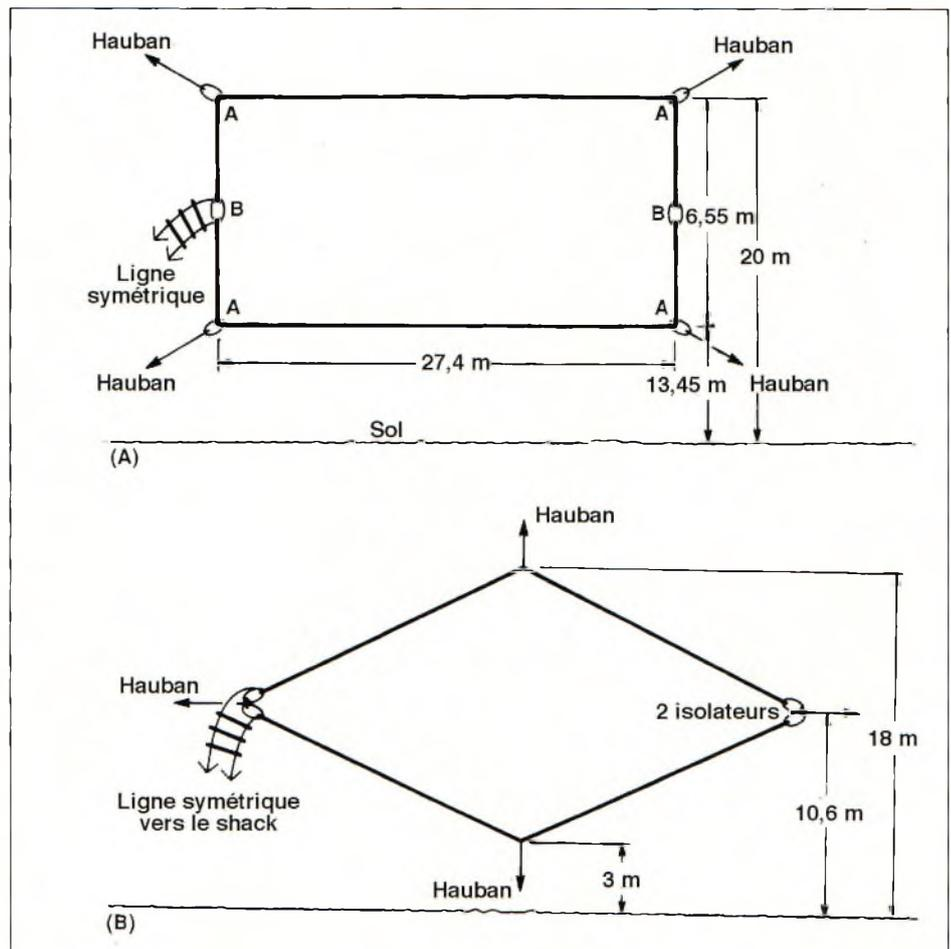
Figure 2. (A) La configuration rectangulaire telle que décrite dans le texte. (B) Cette alternative fut suggérée par W7ZO et conviendra à ceux qui ne disposent que d'un seul support.
