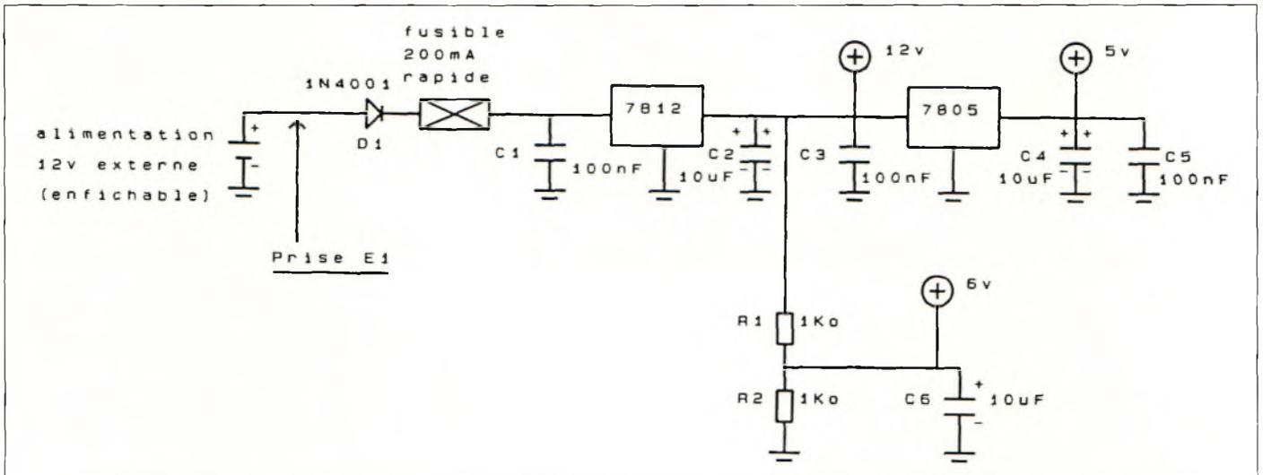
Figure 2. Schéma de principe de la partie alimentation.
