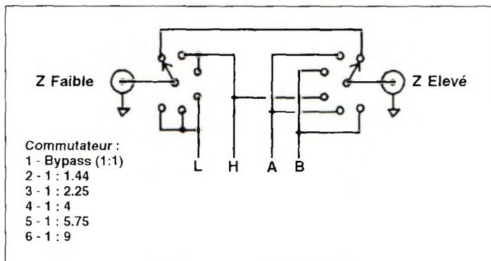
Figure 3 - Schéma de câblage du commutateur.
