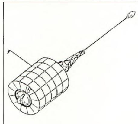
*Le satellite de navigation Russe Tsikada, qui abrite RS10/11, utilise la stabilisation par gradient de gravité.*
