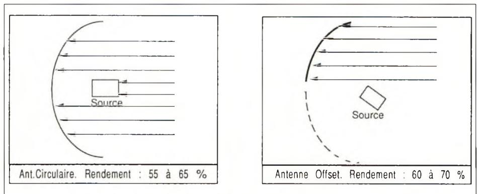
Figure 2 - Comparaison du rendement obtenu avec une antenne circulaire et une antenne offset.
