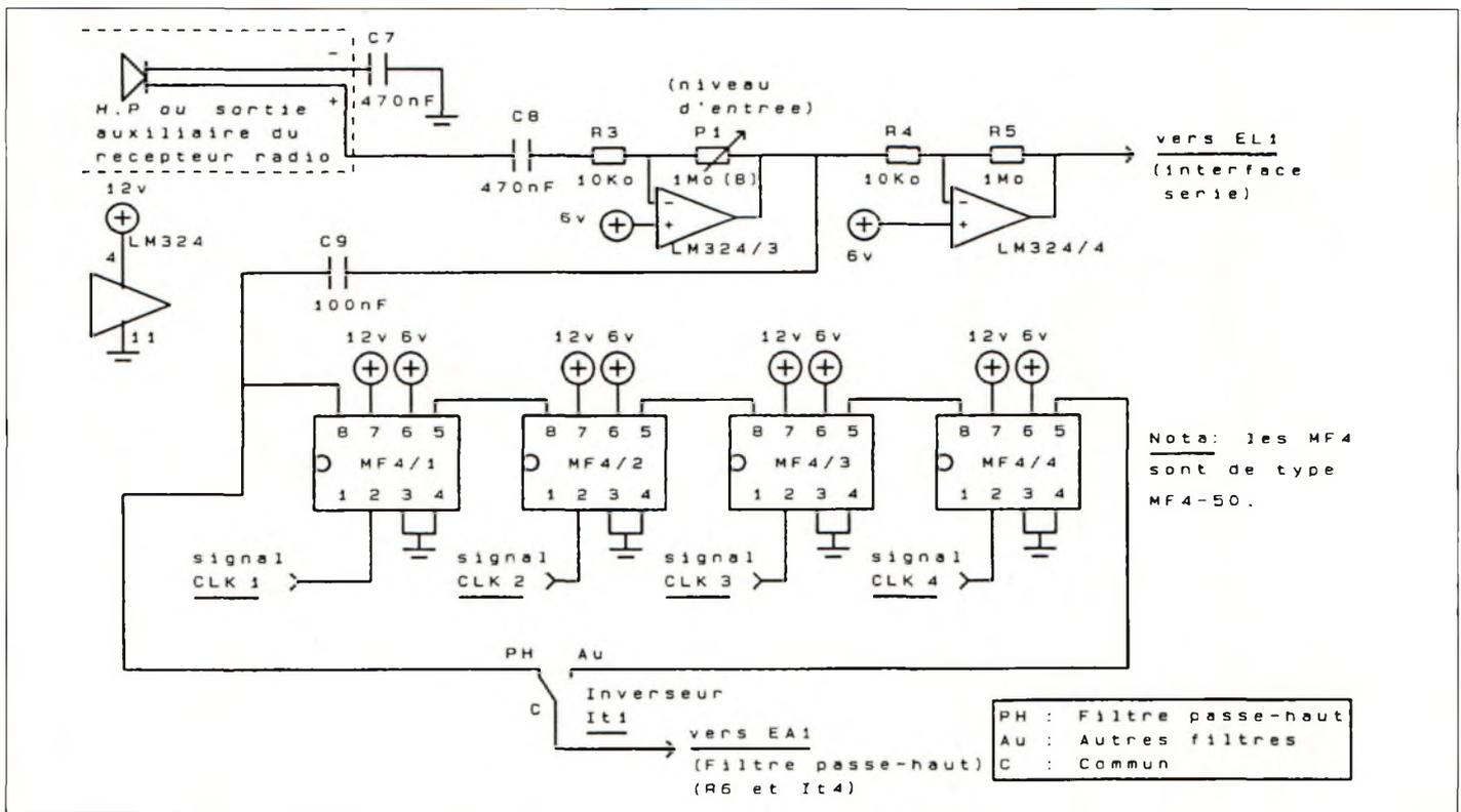
Figure 4. Schéma de la partie Entrée + Filtre passe-bas.
