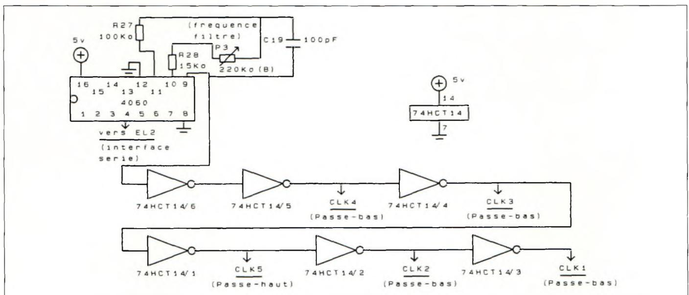
Figure 3. Schéma de principe de la partie logique.
