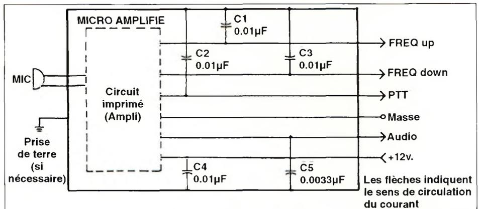
Figure 2 - Synoptique typique d'un microphone préamplifié. C1 à C5 sont ajoutés à l'intérieur du boîtier du microphone pour empêcher les effets du courant RF.
