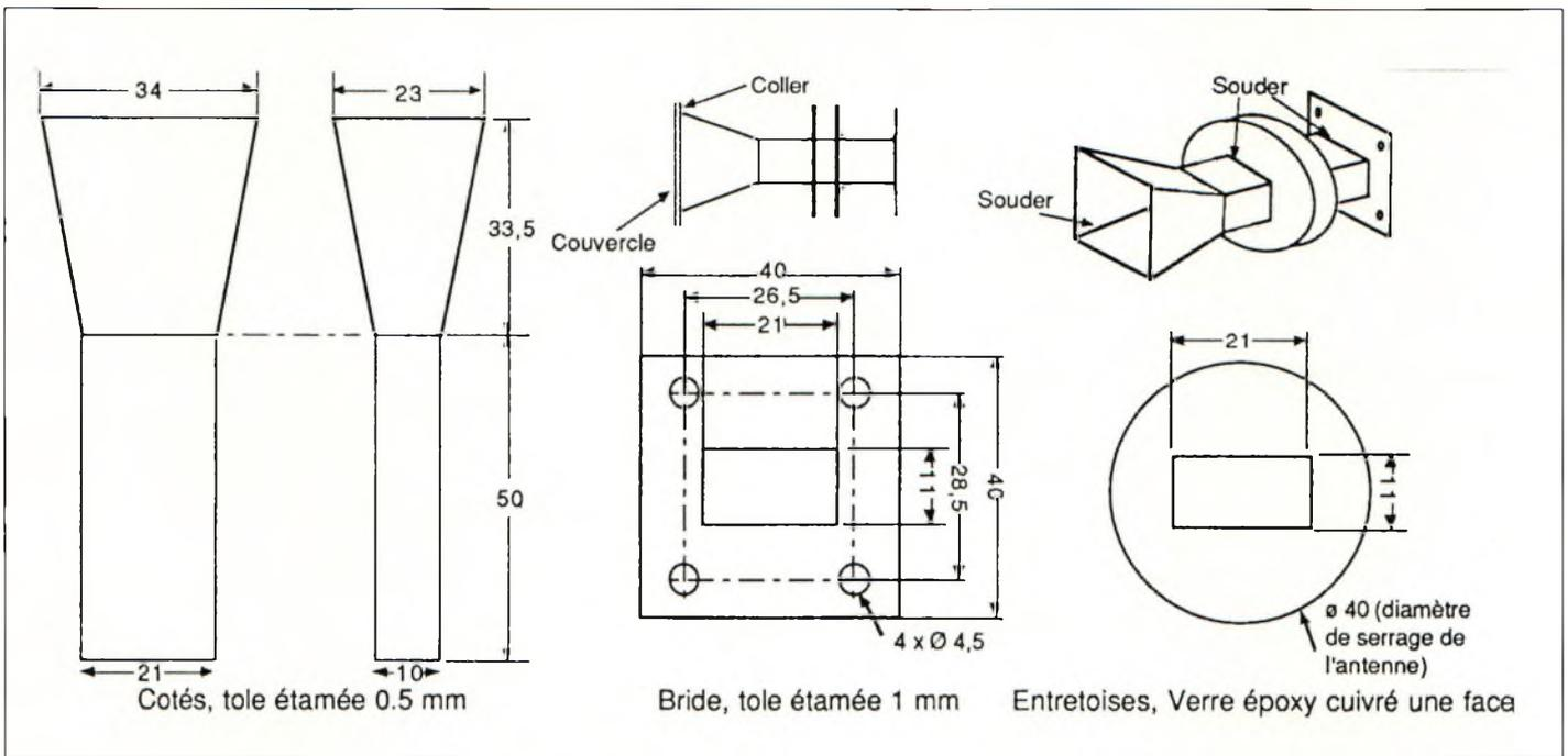
Figure 8 - Schéma pour la réalisation d'un cornet.
