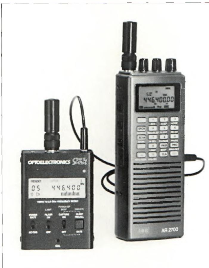
Le Scout d'Optoelectronics connecté ici à un récepteur AOR AR2700.
