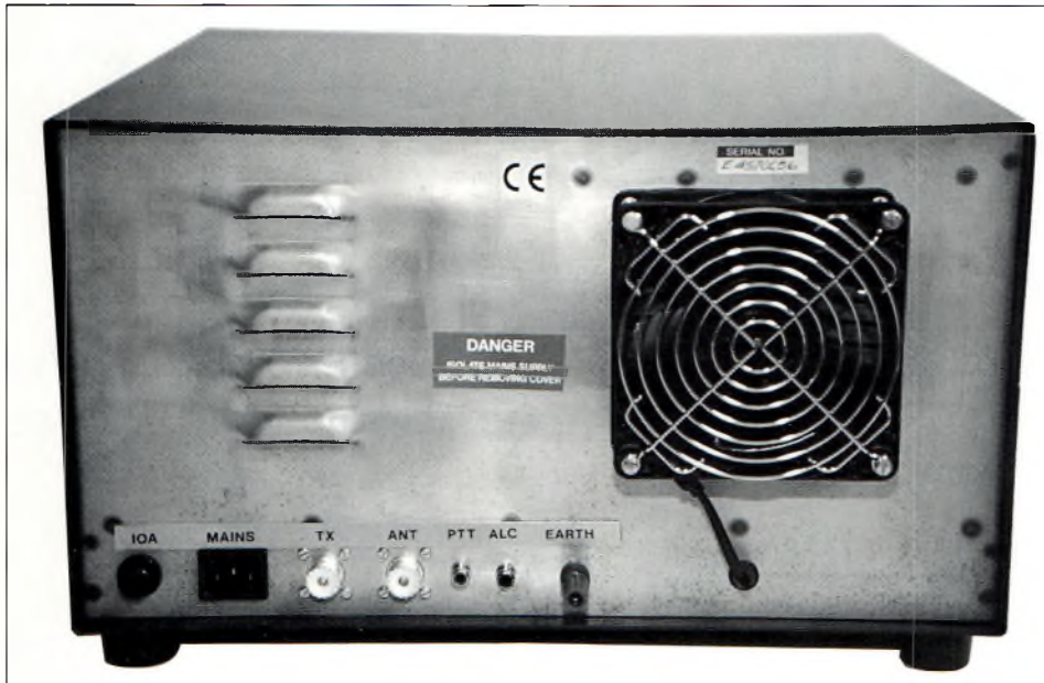
A l'arrière se profilent différents connecteurs, dont l'entrée/sortie HF, la commande d'ALC, le PTT et l'indispensable borne de terre. Le ventilateur est très silencieux.
