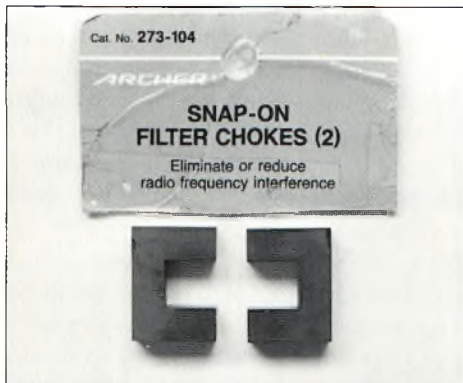
Les tores de ferrite en deux parties à assembler soi-même sont disponibles dans la plupart des magasins de composants électroniques. Ces ferrites servent généralement de filtre pour les téléphones, ordinateurs et autres appareils de bureau.
