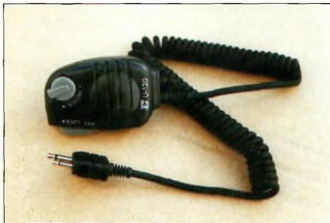
Ce dispositif est un nouveau micro/haut-parleur pour portable VHF. Le volume est réglable sur le micro grâce à un petit potentiomètre. Le casque se connecte sur le micro. Son impédance est de 1 kohm tandis que celle de l'écouteur est de 7,2 ohms. L'ensemble ne pèse que 85 grammes. Le jack est de diamètre 3,5 mm.
