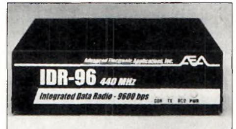
Advanced Electronic Applications, Inc. présente le IDR-96™, un appareil intégrant un TNC Packet-Radio 9600 bauds (PK-96) et un transceiver. Le TNC possède une boîte à lettres, peut fonctionner en Gateway, est compatible GPS, identifie le TCP/IP, TheNet, NetROM et encore bien
