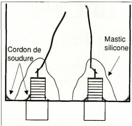
Figure 4. Les cordons de soudure doivent être étanches.
