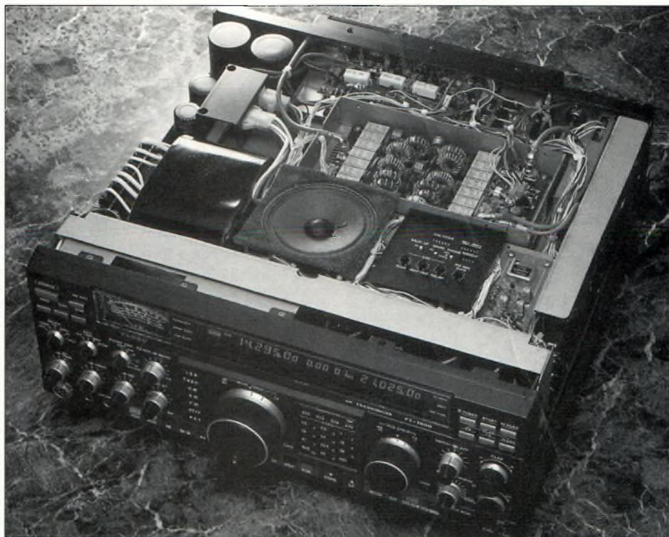
*Assurez-vous d'avoir une position confortable et utilisez un équipement bien réglé. Certains réglages de "confort" ne sont accessibles qu'à l'intérieur du transceiver, comme par exemple le volume du retour son (side tone) en CW.*
