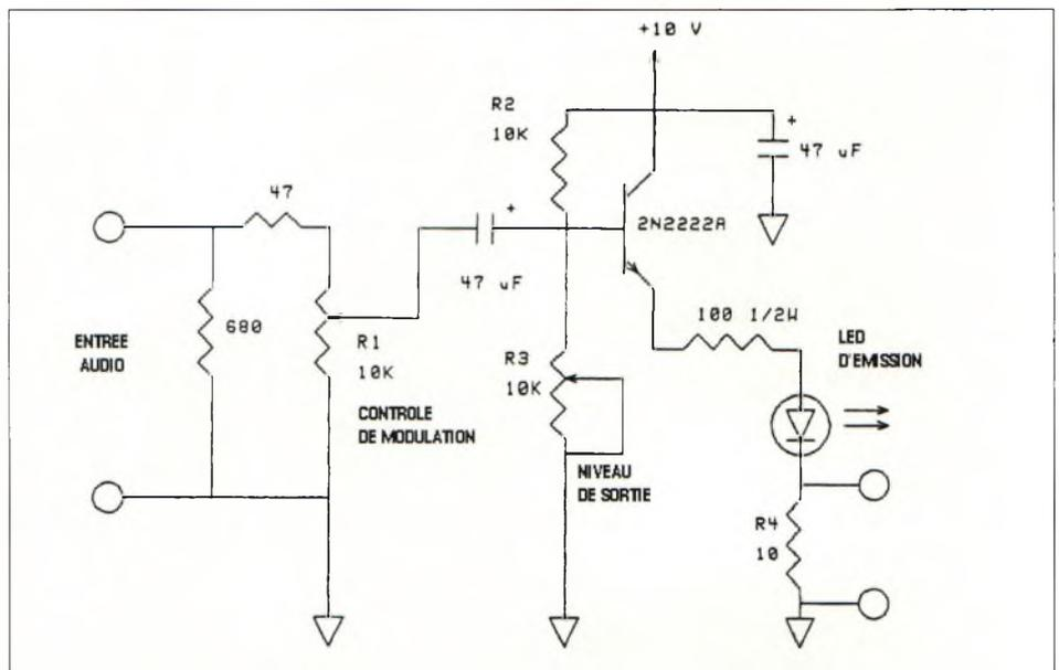
Figure 1. Schéma de principe de l'émetteur optique amélioré.
