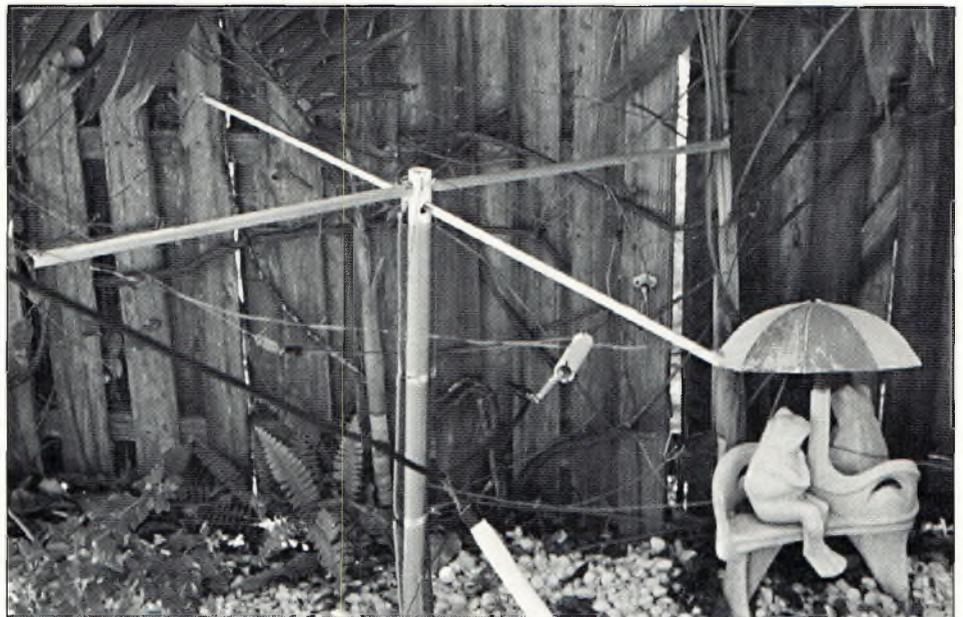
*Le chapeau supérieur se trouve en fait par terre (la grenouille n'a rien à voir avec tout ça !). Le fil sombre arrivant de la gauche est le sloper 80 mètres. Le fil est gainé pour empêcher les brûlures qui pourraient survenir au contact de l'antenne.*
