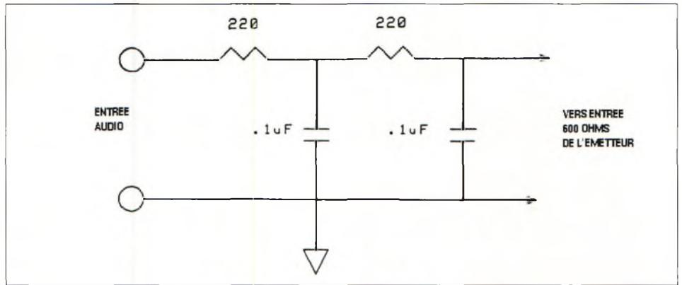
Figure 2. Un filtre passe-bas audio simple.
