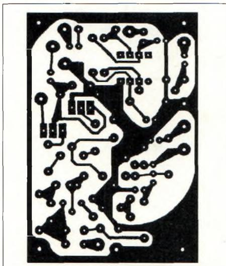
Figure 3. Le circuit imprimé du générateur DSB.
