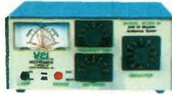
Boîte d'accord manuelle à Vu-mètre Fréquence : 1,8-30 MHz
