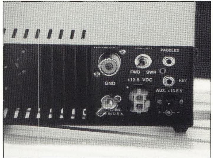
*L'appareil intègre un keyer électronique (connecteur «paddle») et offre les mêmes possibilités d'utilisation que les transceivers HF haut de gamme.*
