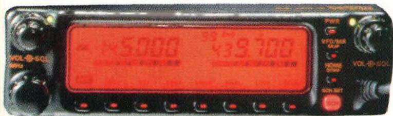
Le nouveau **YAESU FT-8100**, transceiver VHF/UHF à façade détachable.
