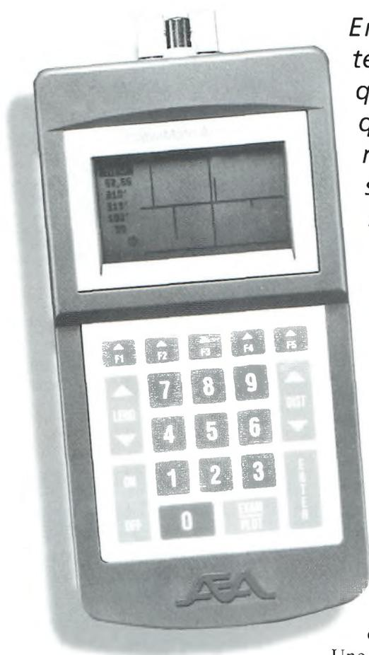
*Le CableMate de AEA est un réflectomètre du domaine temporel. C'est un excellent outil pour vérifier l'état de vos câbles et d'en connaître les défauts.*
