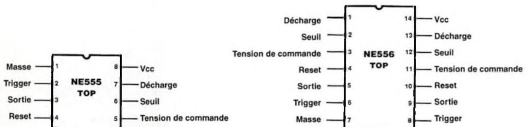
Fig. 2- Diagrammes de câblage des NE555 et NE556 utilisés dans le montage.
