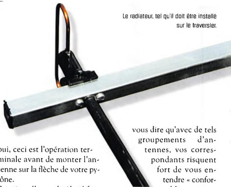
Le radiateur, tel qu'il doit être installé sur le traversier.
