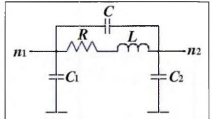
Fig. 1 - Schéma équivalent de l'inductance avec le composant « Mrind ».
