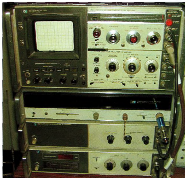
Un banc de mesure des années 1978/1980 au grand complet avec, de bas en haut, le présélecteur, le générateur de poursuite, le fréquencemètre et l'analyseur de spectre. Un appareil aux fonctions identiques fabriqué de nos jours peut valoir beaucoup d'argent. Alors ne loupez pas les brocantes !
