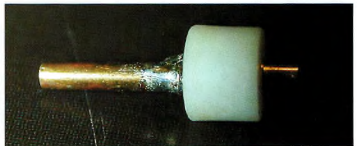
La sonde qui plonge dans le cornet. À gauche et à droite celle qui va dans la fiche SMA.
