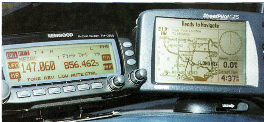
La façade du transceiver est détachée du corps de l'appareil et ne peut pas y être fixée. Le cordon de liaison est livré d'origine. Sur ce cliché, le TM-D700 est relié à un récepteur GPS pour le trafic APRS.
