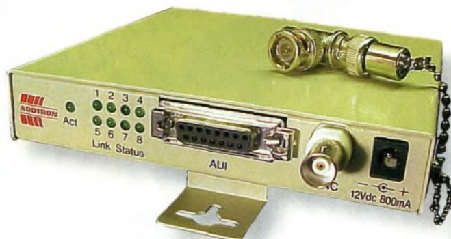
**Fig. 2** - Un hub 10BaseT à port 8 utilisé par l'auteur. Ce hub coûte environ de 500 F et a été utilisé pendant trois ans. A l'arrière, il y a huit prises RJ-45 jacks. Sur le panneau représenté devant, il y a un connecteur BNC pour ThinNet et un connecteur Sub-D AUI 15-pin. Ces deux connecteurs supplémentaires permettent un équipement réseau plus ancien pour connecter au hub. Remarquez aussi les huit LED "Link Status", une pour chaque port, et la prise de courant.
