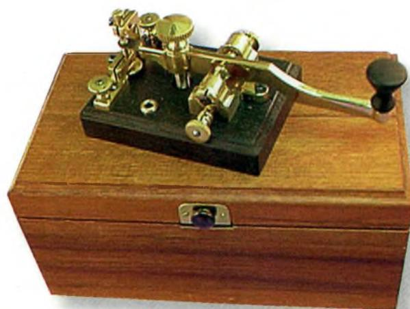
Photo 2 – Une version plus petite de la célèbre clé suédoise comporte un long bras similaire et un complément entier de réglages ainsi qu'un bouton d'arrêt de déplacement entre le point d'appui et la poignée. La clé est représentée sur son étui en feutre. (Photo prise avec l'aimable autorisation de N1FN)
