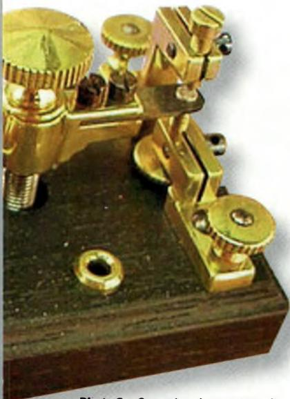
Photo 3 – Gros plan du montage du contact arrière de la clé suédoise et des réglages reliés. Remarquez les parties minuscules et les composants complexes du mécanisme. Très joli !
