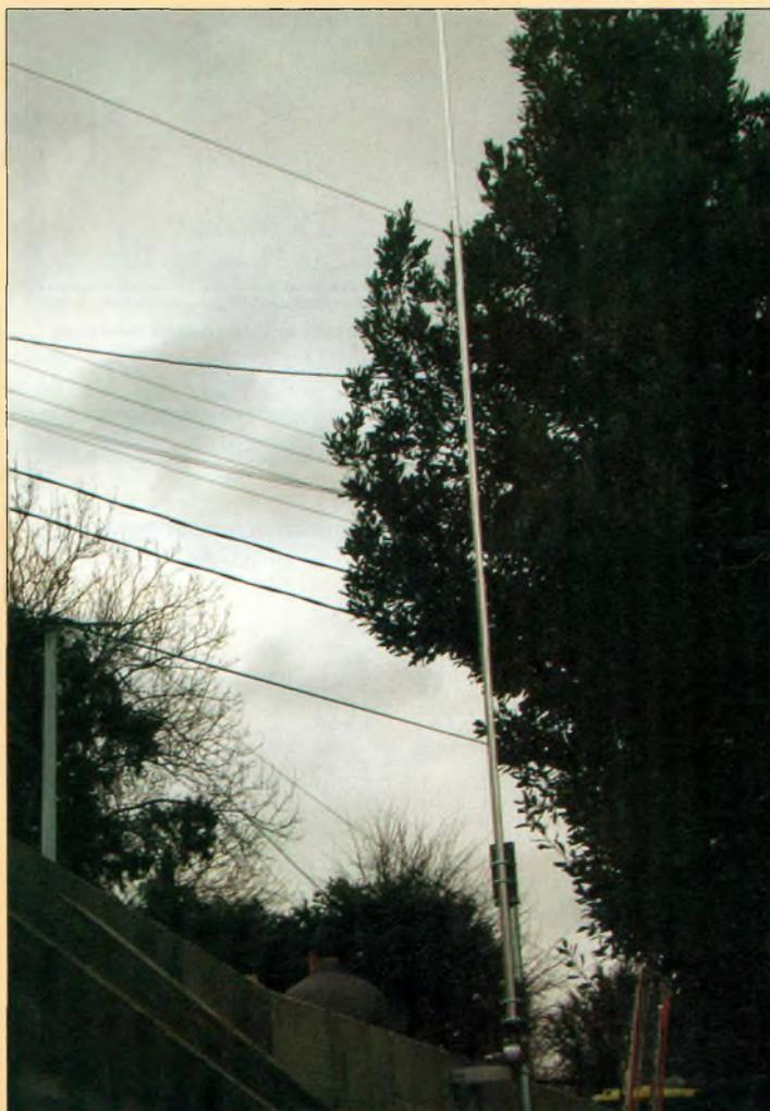
Une antenne large bande équipée d'un transformateur d'impédance de rapport 10 à 1 (fabrication ITA).
