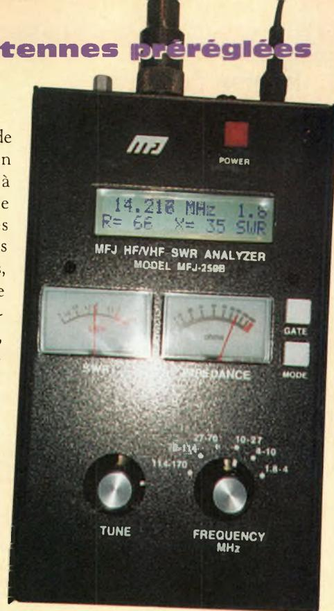
**Photo A** - L'Analyseur d'Antenne MFJ 259B est facile à utiliser, un central intégré idéal pour la vérification des SWR, des bandes passantes et des câbles coaxiaux ; le préréglage manuel des commandes etc. Il vérifie ici le SWR dans le shack ou "transceiver au bout d'une ligne coaxiale" d'une antenne verticale à cinq bandes comme je l'explique dans le texte. Avant de régler les longueurs de l'antenne, le SWR est de 1,8:1 à 14,218 MHz.
