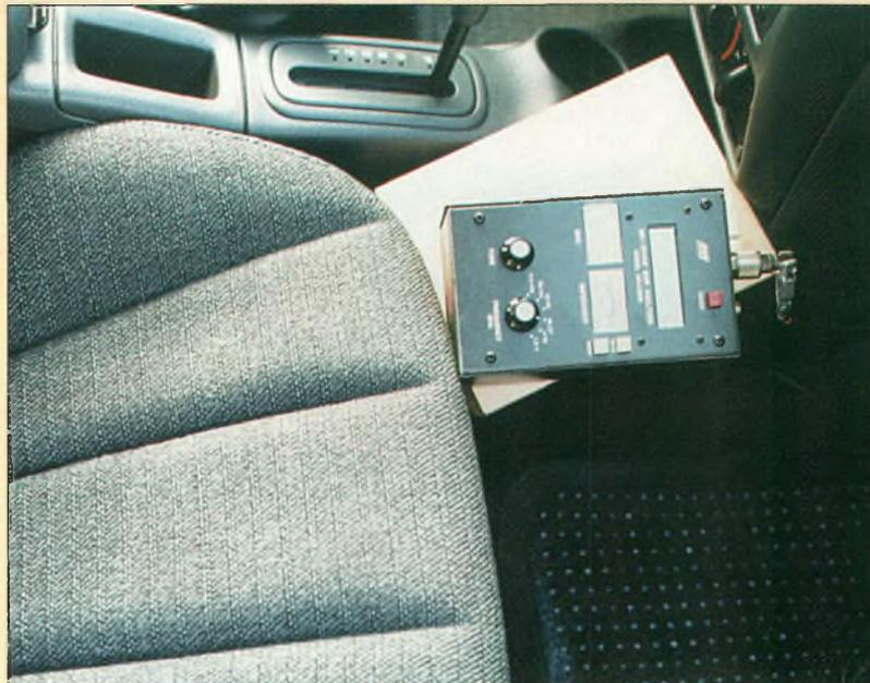
**Photo E-** Le MFJ259B fonctionne aussi très bien pour établir les fréquences et régler l'impédance, vous n'avez même pas besoin de poser votre transceiver dans le véhicule jusqu'à ce que l'antenne soit parfaitement établie.
