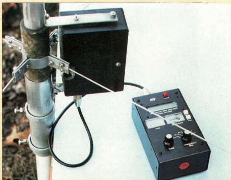
**Photo B** - Pour faciliter le réglage et la vérification immédiats, je compare le SWR de l'antenne à la base avec son SWR mesuré dans le shack. En raison de l'interaction de la ligne d'alimentation, toutes les mesures SWR sont modifiées en fréquences hautes de 80 à 100 kHz. Le SWR est maintenant de 1,4:1 à 14,218 MHz.
