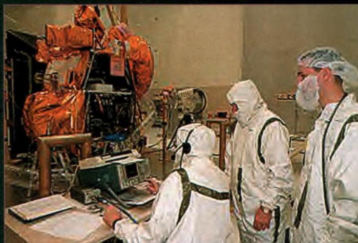
Test de l'antenne UHF de l'Odysée de Mars. (photo de la NASA)
