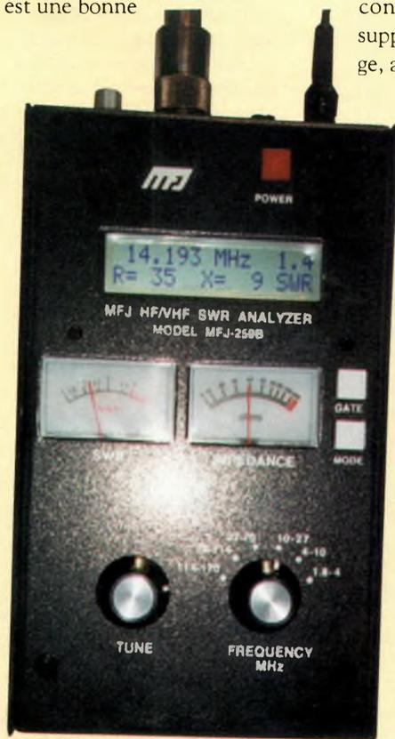
**Photo D**— En retournant avec assurance dans le shack, je vérifie à nouveau le SWR "transceiver au bout de la ligne coaxiale" de l'antenne. Cela indique maintenant 1,4:1 à 14,193 MHz. (Désolé, je ne visais pas exactement 14,218 avant de prendre la photo. Excusez-moi pour le reflet du flash de l'appareil photo.
