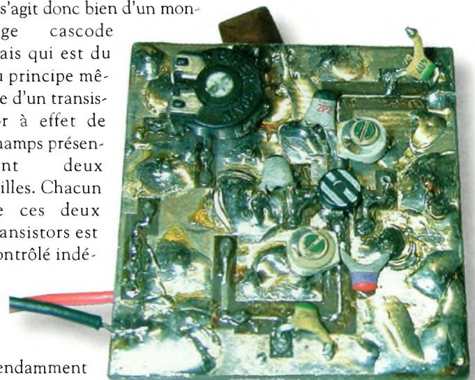
Le transistor est monté avec son marquage contre le circuit imprimé.
