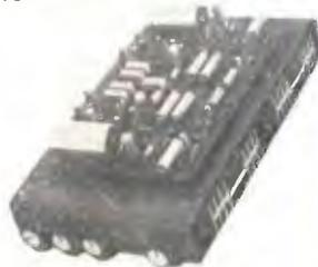
**Mod. 3002:** Amplificatore HiFi Monoaurale 25 Watt ★ Altre caratt. identico al Mod. 3004 ★ Dim. cm. 16 x 16 x 9 ★ Alim. 40 V ★ N. 8 transistor ★ **MONTATO E COLLAUDATO L. 18.500 ★ ALIMENTATORE L. 5.000 (prezzi netti) ★**
