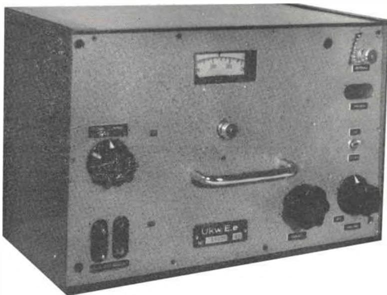
Circa le caratteristiche elettriche, l'apparecchio è del tipo supereterodina a semplice conversione che impiega 7 tubi del tipo RV12P4000 al fine di facilitare al massimo la manutenzione.
