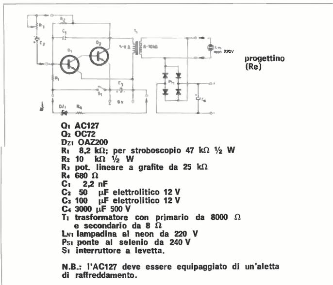
Per modificarlo in uno stroboscopio, aggiungere  $L_{N1}$ ,  $R_3$ ,  $C_2$  e cambiare  $R_1$  con una resistenza da 47 kΩ.
