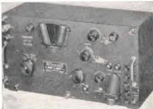
**Ricevitori BC-312/AC** - Come sopra con alimentatore funzionante in corrente alternata da 110-125-140-160-220 V, internamente incorporato. Viene venduto al prezzo di L. 35.000 funzionante e provato prima di essere spedito. Con media frequenza a cristallo L. 10.000 in più.
