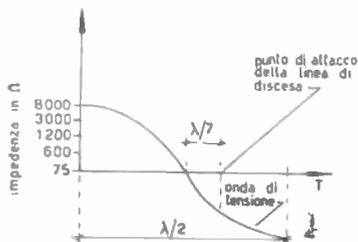
N.B. il valore dell'impedenza è direttamente proporzionale al valore dell'onda stazionaria di tensione.
