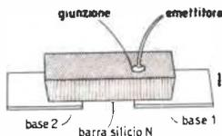
Attualmente questo tipo di costruzione si ritiene superato e i transistor unigiunzione vengono anch'essi costruiti con le tecniche più perfezionate.
